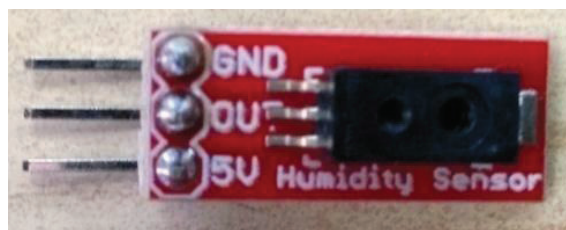
Figura 2.21 Módulo del sensor de humedad HIH-4030
