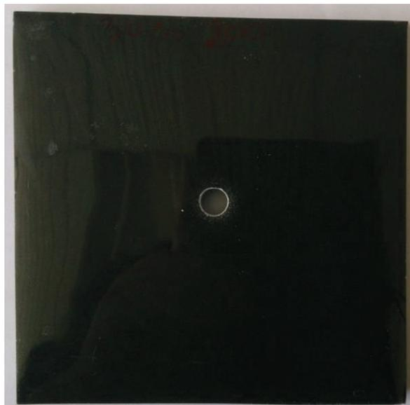
**Figura 3.12.** Placa de material compuesto de resina poliéster insaturada y 30% de residuos con tamaño de partícula 0,075 mm
