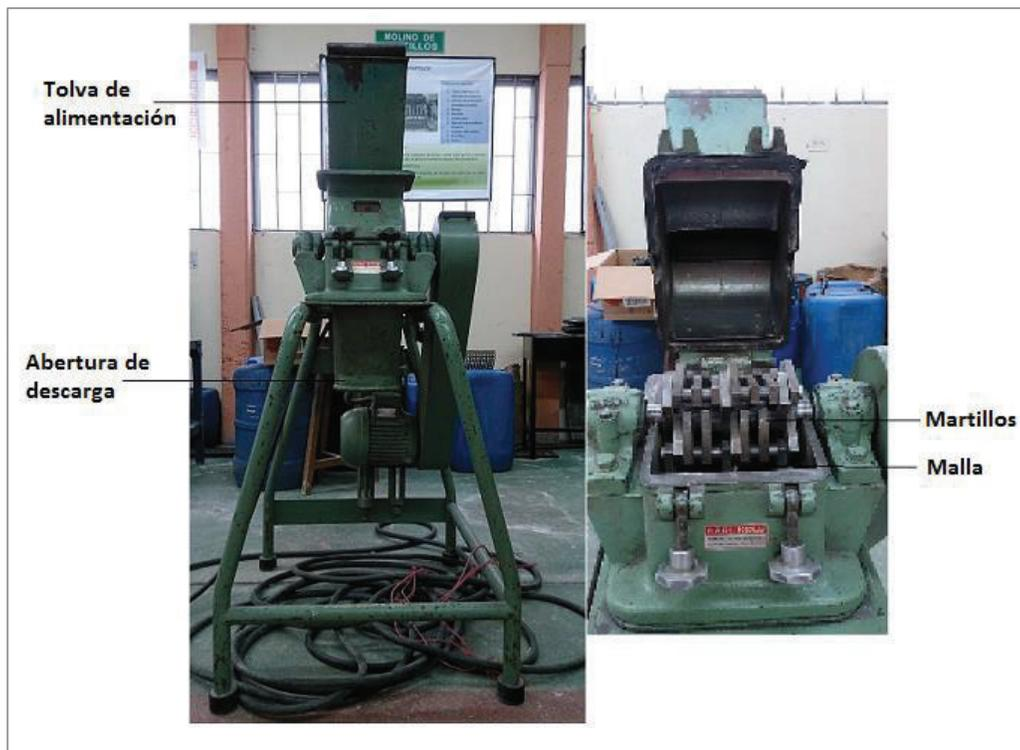
**Figura 2.3.** Molino de martillos utilizado para la reducción de tamaño de las tarjetas de circuitos impresos
