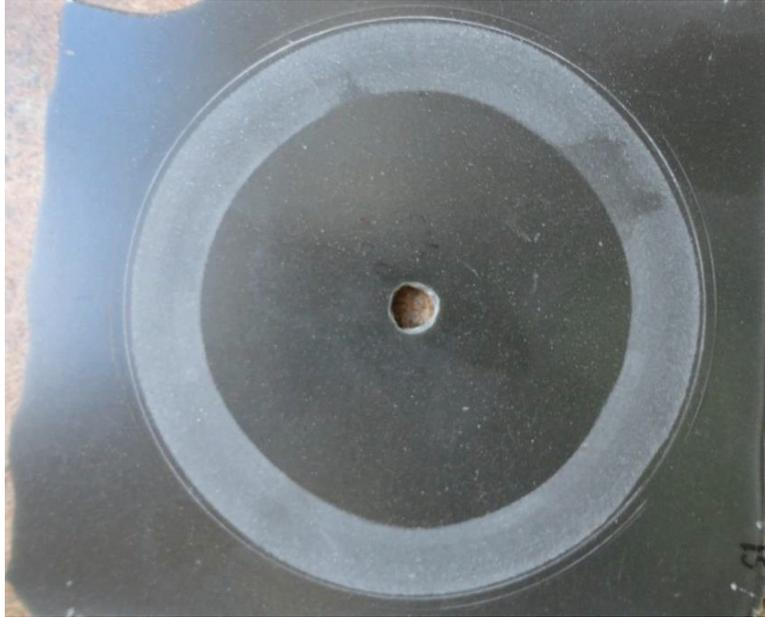
**Figura 3.35.** Placa obtenida de polimetimetacrilato y 15% de residuos de tamaño 0,075 mm para ensayo de abrasión
