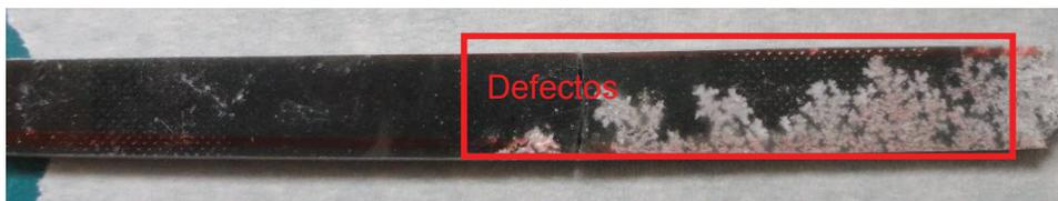
**Figura 3.9.** Placa obtenida de polimetimetacrilato y 20% de residuos de tamaño 0,15 mm para ensayo de flexión
