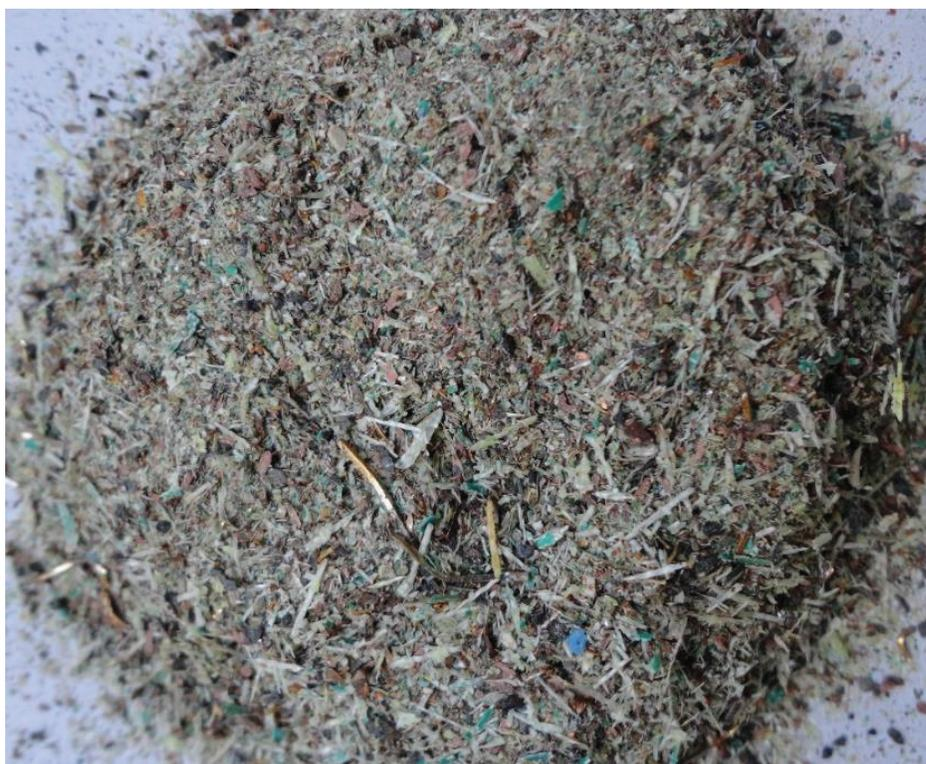
**Figura 3.1.** Fracción metálica obtenida de la separación gravimétrica
