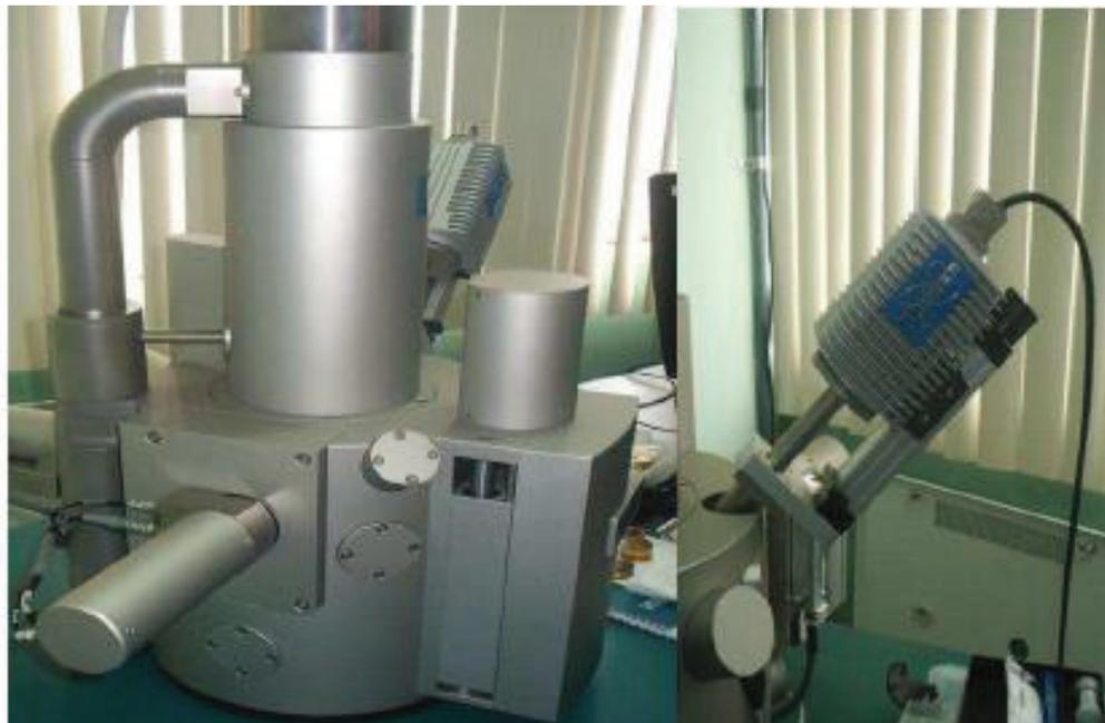
**Figura 2.9.** Microscopio electrónico de barrido TESCAN
