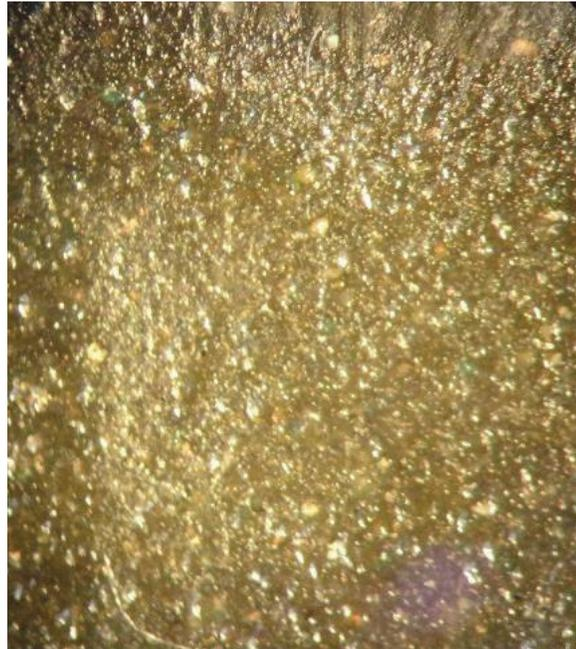
**Figura 3.37.** Resultado obtenido de microscopía óptica con 100 aumentos del material compuesto de resina poliéster insaturada y 20% de residuos de tamaño 0,075 mm
