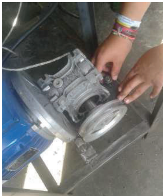
Figura 3.8 Montaje Motor en Templador.
