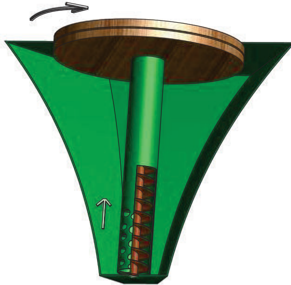
Figura 1.25. Recirculación por Gravedad
