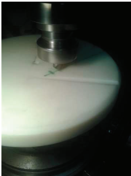
Figura 3.3 Fabricación del Disco Móvil.
