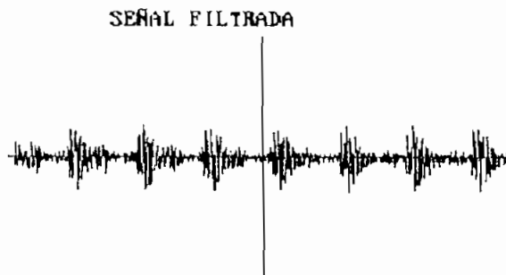
Figura 5.20: Señal filtrada por un filtro pasa-altos
