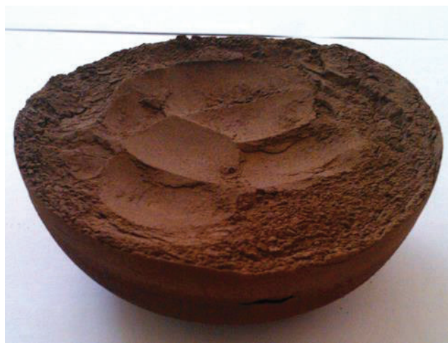
Figura 3.10. Fotografía de la muestra de relaves correspondiente al ensayo N° 16 (granos < 45 \mu m , 1\ 000\ ^\circ C ), después de haber sido calcinada
