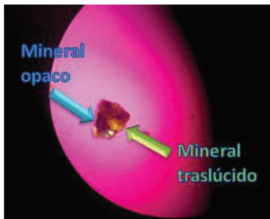
Figura 3.14. Fotografía de un grano de ferritas correspondiente al ensayo N° 1, observado con el microscopio petrográfico ZEISS, con analizador
