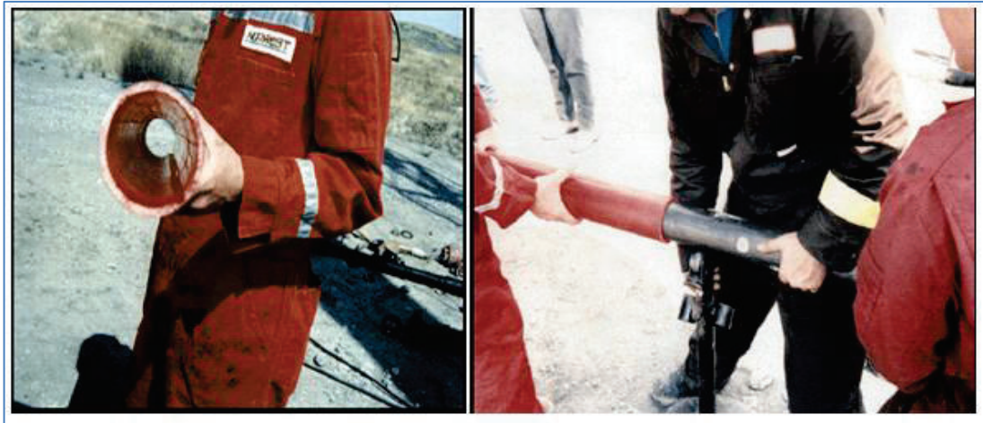
FIGURA 2. 51 DISPARO CON CAMISAS DE PROPELENTE
