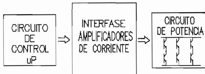
FIGURA 3.1.- Diagrama de bloques de las partes constitutivas del inversor.
