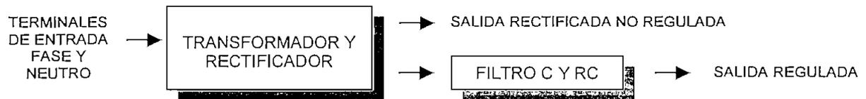
Figura 2.4 Diagrama de bloques rectificador
