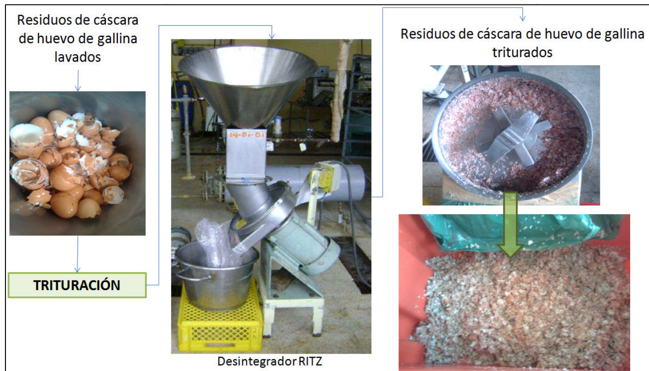
Figura AI.1. Proceso y equipos utilizados para la tritución de residuos de cáscara de huevo de gallina
