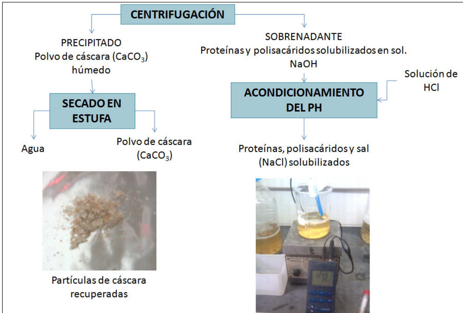
Figura AII.3. Equipos e instrumentos utilizados durante el proceso de acondicionamiento de pH
