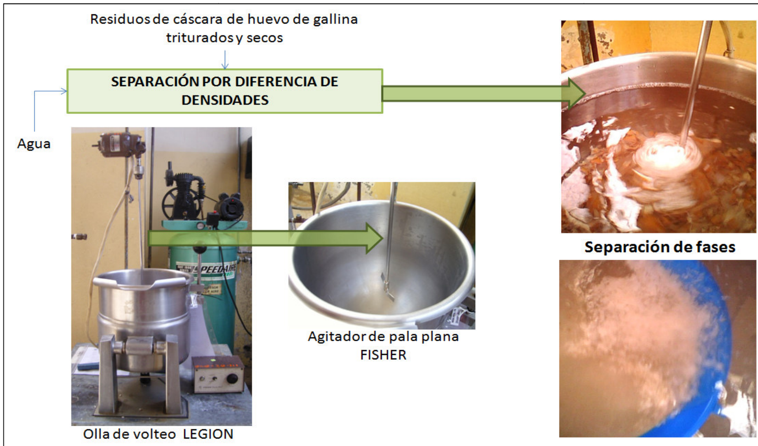
Figura A1.3. Proceso y equipos utilizados para la separación por diferencia de densidades de residuos de cáscara de huevo de gallina
