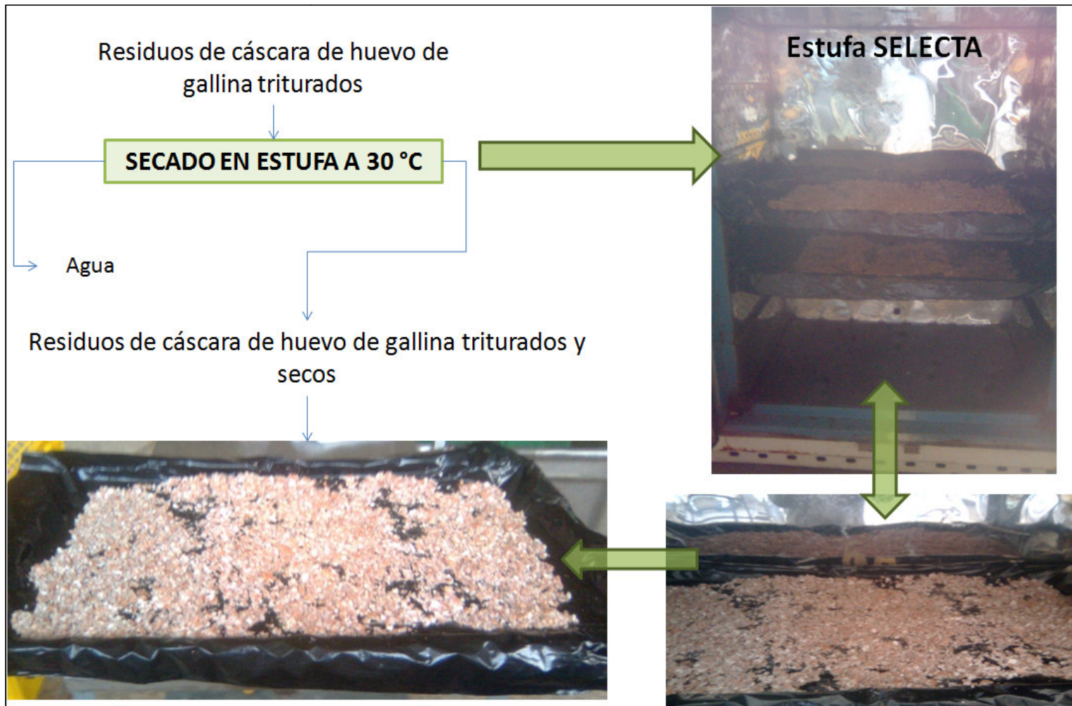
Figura AI.2. Proceso y equipos utilizados para el secado de los residuos de cáscara de huevo de gallina triturados
