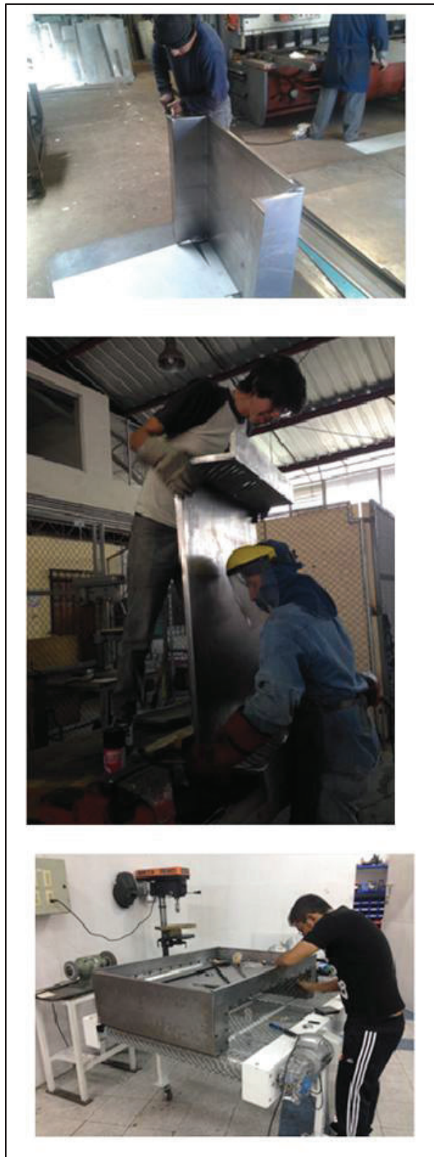
Fotografía 5.1. Construcción del horno de secador.
