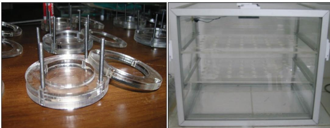
**Figura AI.2.** Izquierda: cápsulas de polimetilmetacrilato. Derecha: cámara hermética de polimetilmetacrilato y aluminio, de 60 x 40 x 60 cm
