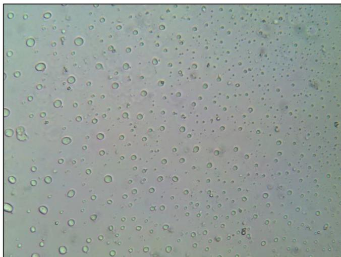
**Figura 3.3.** Microfotografía a 100 X de una emulsión TLc: 30 % GL y 30 % BW
