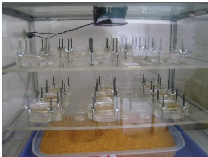
**Figura AI.1.** Cápsulas y cámara hermética utilizadas para la determinación de la permeabilidad al vapor de agua en funcionamiento
