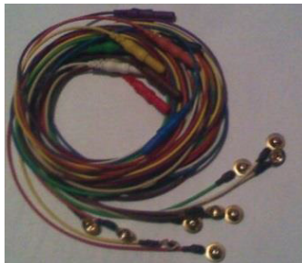
Figura 3.1: Electrodo para EEG tipo copa (plata-oro) utilizados.
