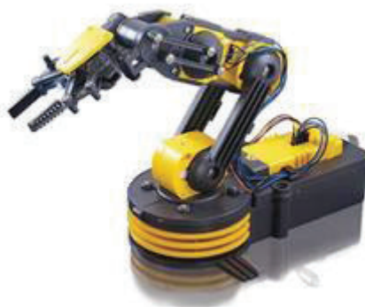
Figura 4.21: Brazo robótico de cinco grados de libertad utilizado.
