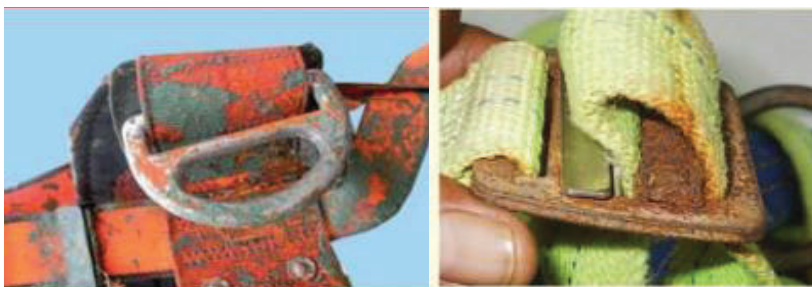
Figura 2.26 Desgaste en hebillas con presencia de un químico y con presencia de corrosión
