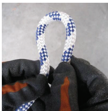
Figura 2.1 Cuerda sin daño interno
