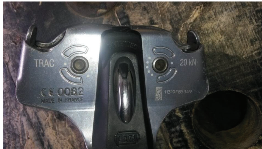
Figura 4.42 Especificaciones mecánicas de la polea Fuente: propia
