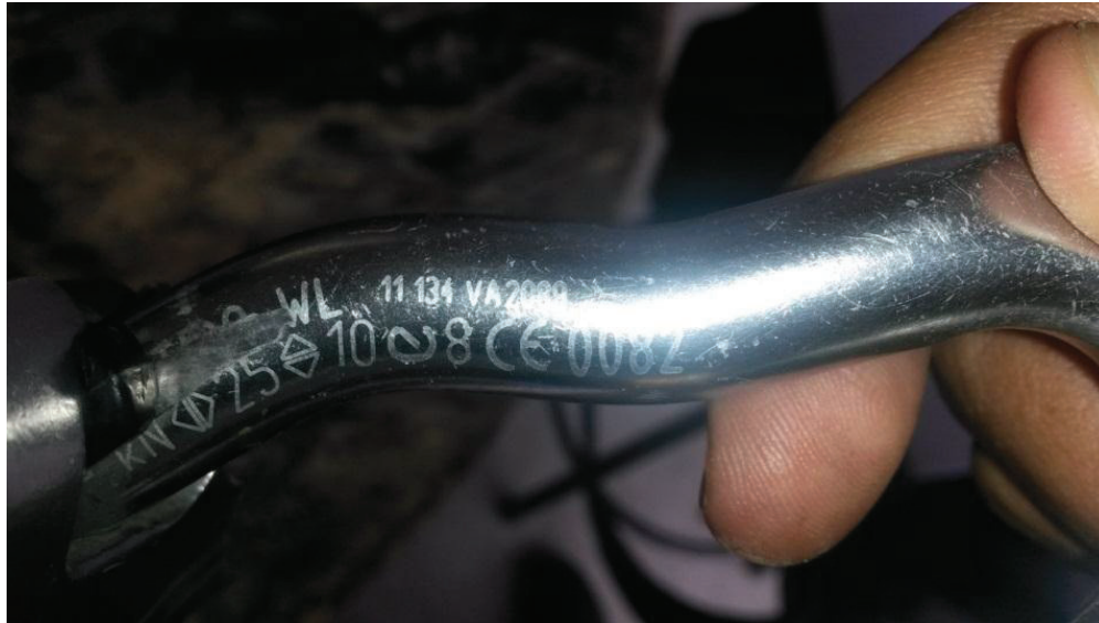
Figura 4.43 Características mecánicas del mosquetón Fuente: propia
