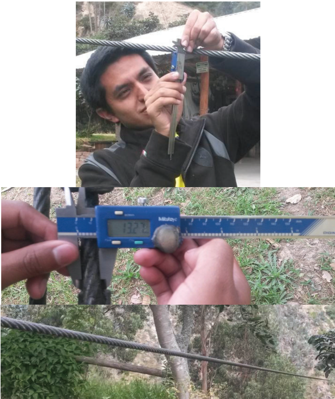
Figura 4.17 Medición en campo del diámetro del cable Fuente: propia
