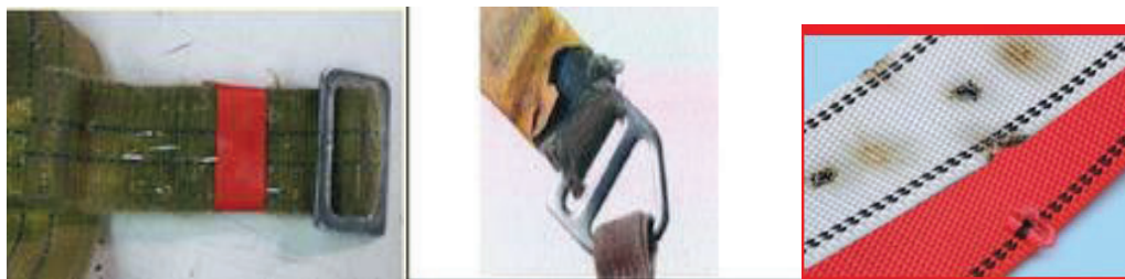
Figura 2.25 Desgaste de cintas
