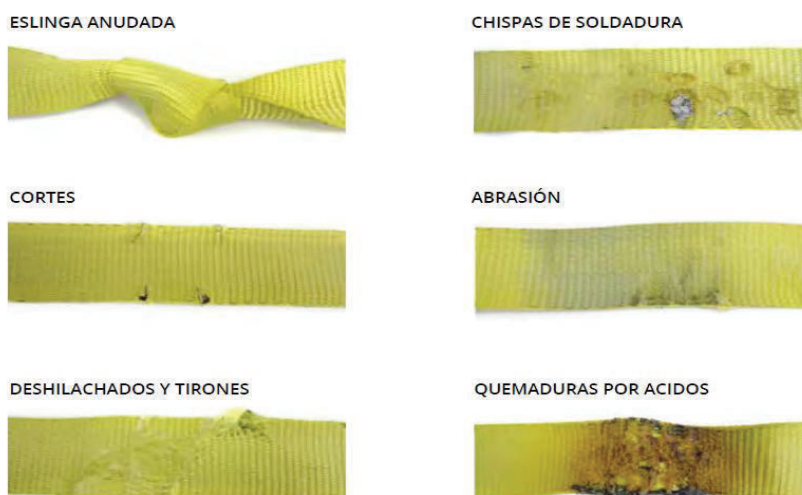
Figura 2.8 Daños en las cintas
