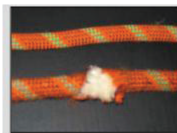
Figura 2.22 Daños de corte en cuerdas
