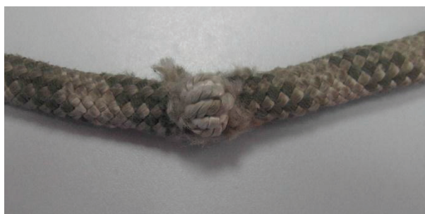
Figura 2.3 Cuerda con daño en la funda
