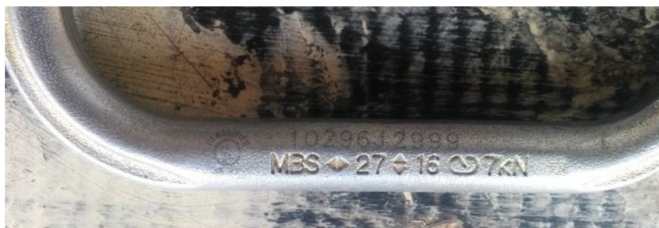
Figura 4.47 Características mecánicas del mosquetón Fuente: propia
