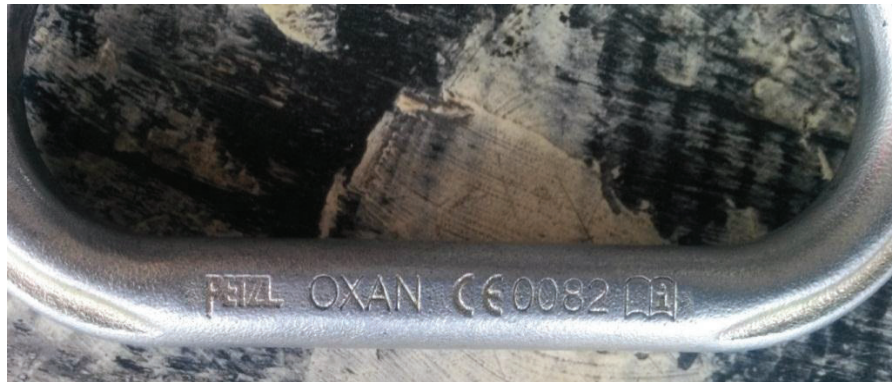
Figura 4.45 Código de certificación del mosquetón Fuente: propia
