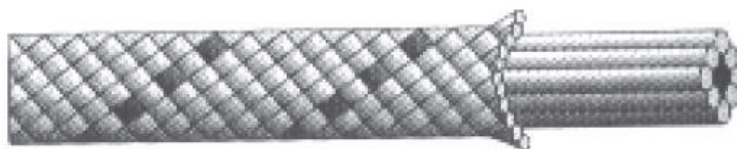
Figura 1.25 Camisa y alma de una cuerda estática Fuente: http://www.olerdola.org/documentos/Cuerdas.pdf
