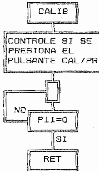
FIG 3.20. DIAGRAMA DE FLUJO DE LA SUBROUTINA CALIB.
