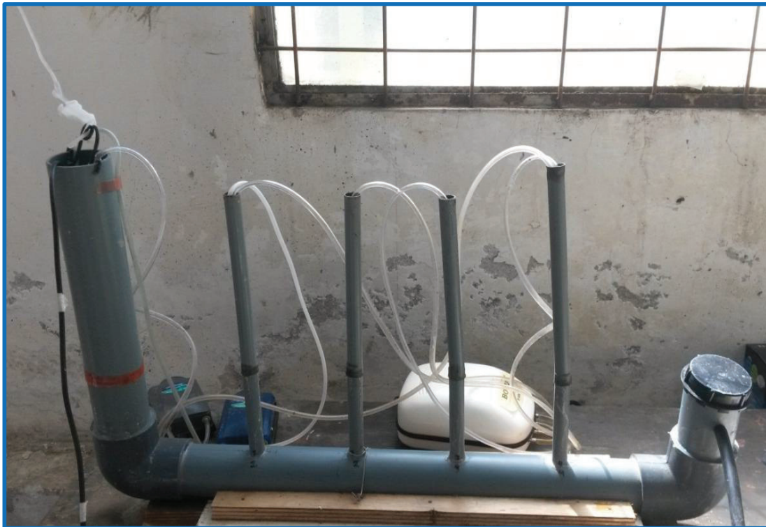
FIGURA 3.3 FOTOGRAFÍA DEL BIOREACTOR AEROBIO HORIZONTAL
