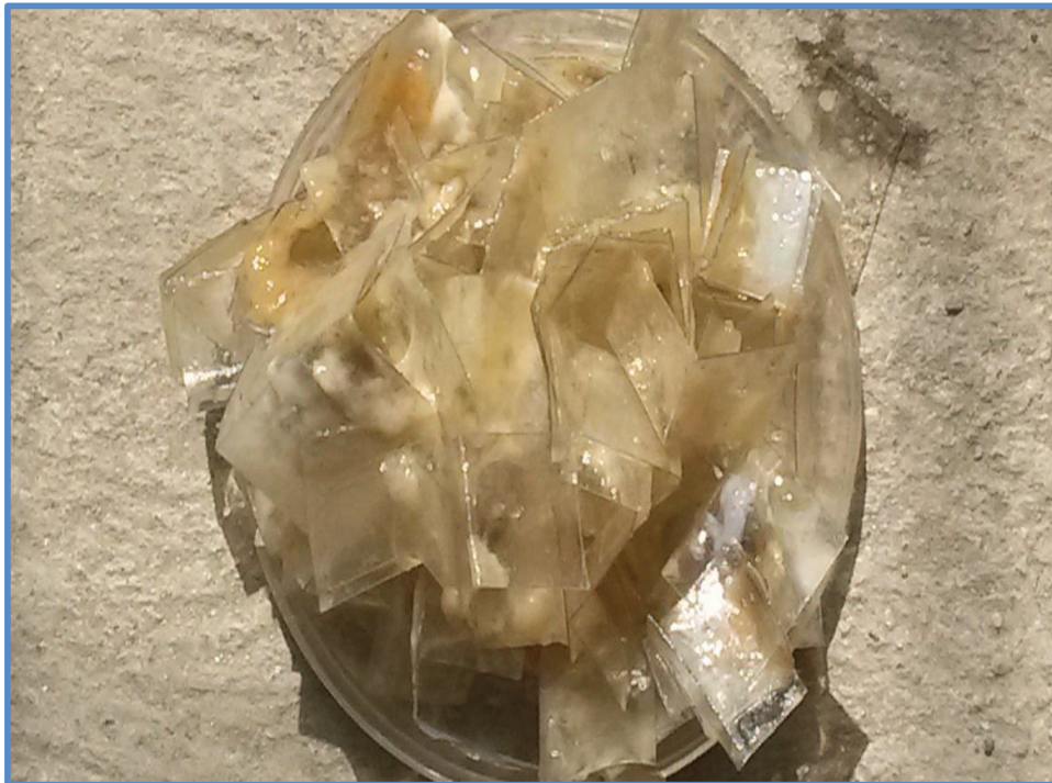
FIGURA 4.1 BIOPELICULA FORMADA DENTRO DEL REACTOR AEROBIO HORIZONTAL JUNTO AL MEDIO DE SOPORTE PET
