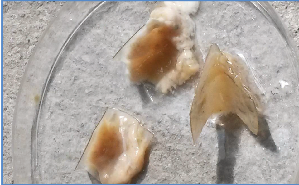
FIGURA 2. 2 MEDIO DE SOPORTE CON BIOPELÍCULA ADHERIDA
