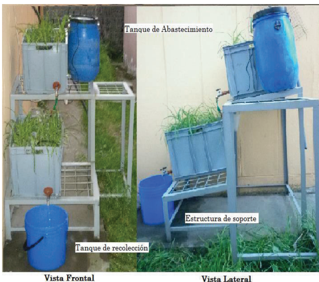
Figura 3.37. Sistema de humedales artificiales implementado
