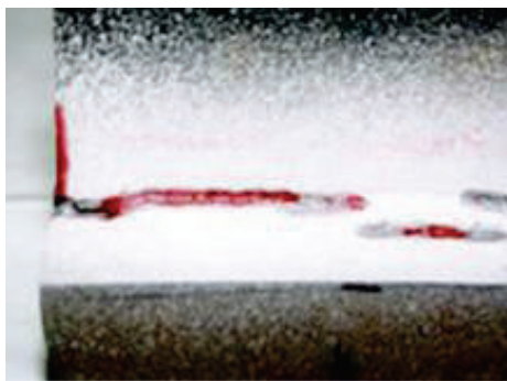
Figura 3. 17 Inspección por Tintas penetrantes
