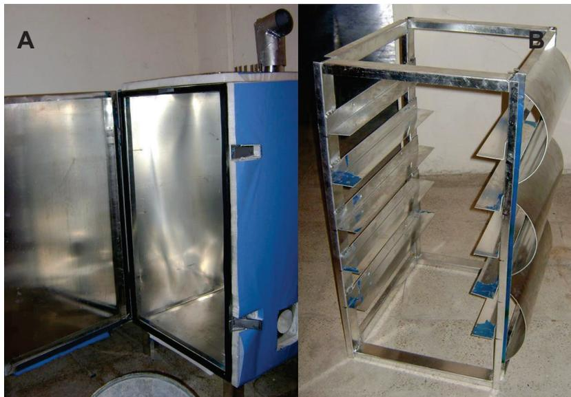
**Figura 2.20.** (A) Fermentador y (B) soporte interno con deflectores utilizados para el proceso de fermentación a escala de laboratorio
