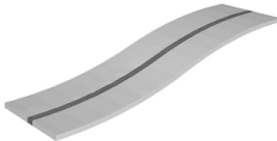
Figura 3.24 Buckling de una soldadura a tope 14
