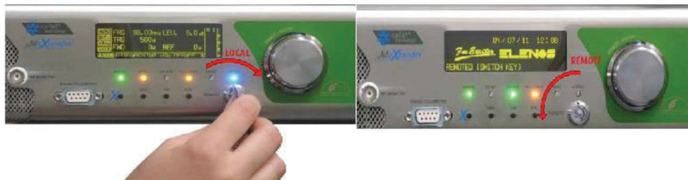
**Figura 52** – Llave de modo local y remoto del transmisor.
