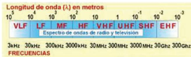
**Figura 3** - Bandas de frecuencias del espectro radioeléctrico.
