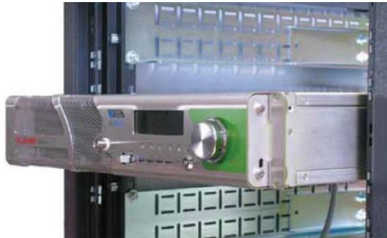
**Figura 47** – Montaje del transmisor en el RACK.
