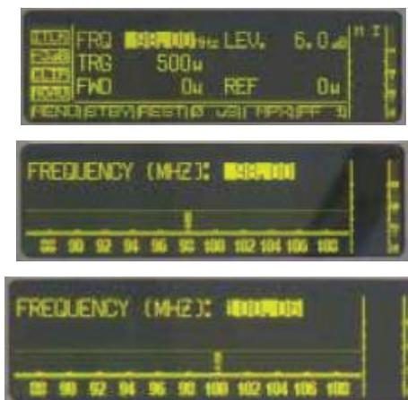
**Figura 54** – Ajuste de la frecuencia de trasmisión.
