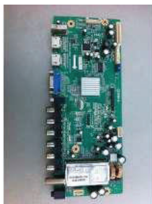
Figura 5. 9 Ejemplo de placa de comunicaciones y ubicación de leds de aviso.
