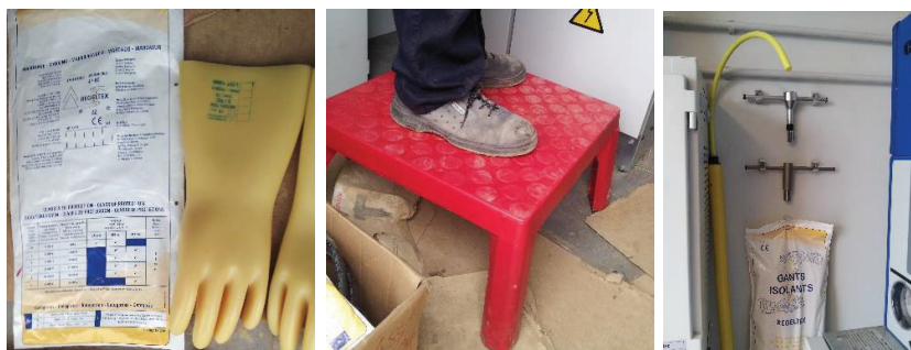
Figura 5. 16 Guantes dieléctricos, banquillo dieléctrico, pértiga de salvamento para medio voltaje.
