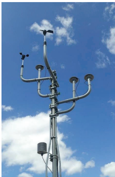
Figura 3. 5 Ejemplo de piranómetros en una estación meteorológica de monitoreo.
