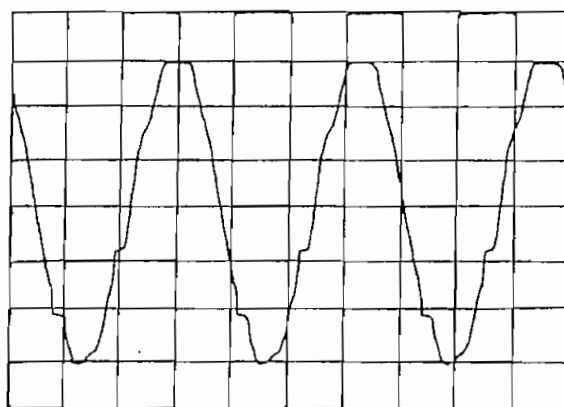
Figura No. 4.2 Voltaje generado con un banco de capacitores Escala: Horz. 5 ms/div. Vert. 100 V/div.
