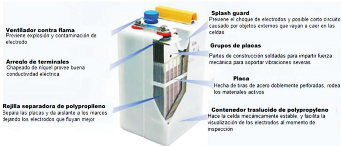
Figura 2.37 Componentes de una batería de níquel-cadmio
