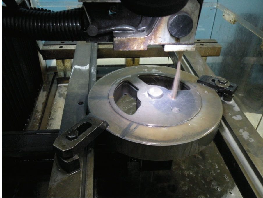
Figura B.5 Proceso de corte por hilo de tungsteno para interiores del acumulador cinético (Fuente: Propia)
