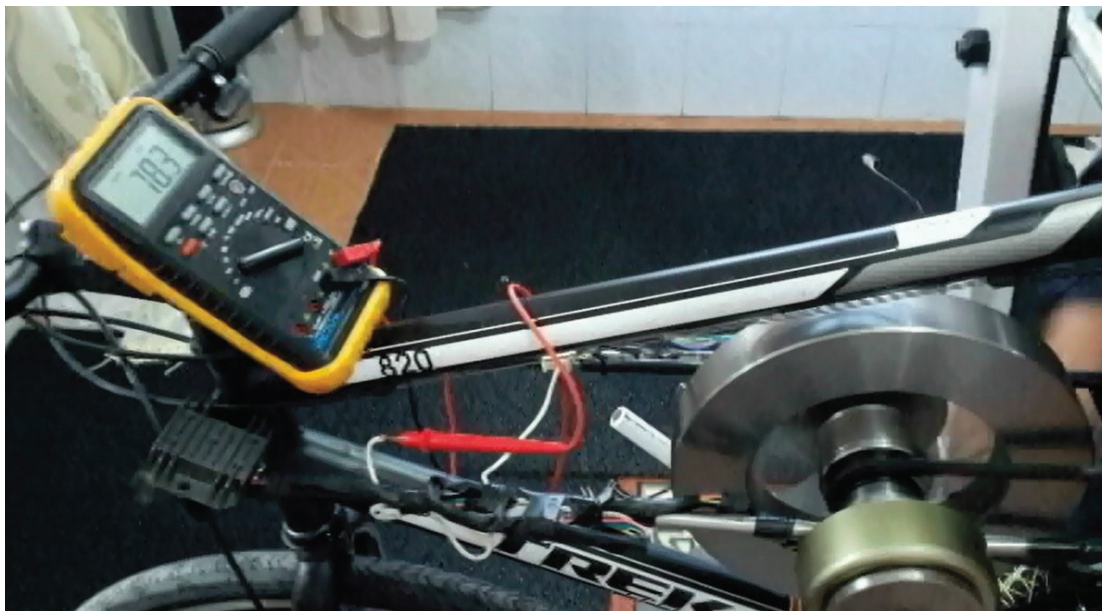
Figura B.22 Voltajes obtenidos entre 20 y 70 voltios con la prueba de dos generadores
