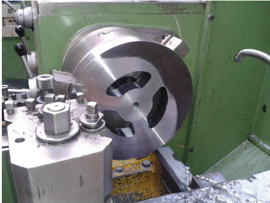
Figura B.3 Maquinado del acumulador cinético
