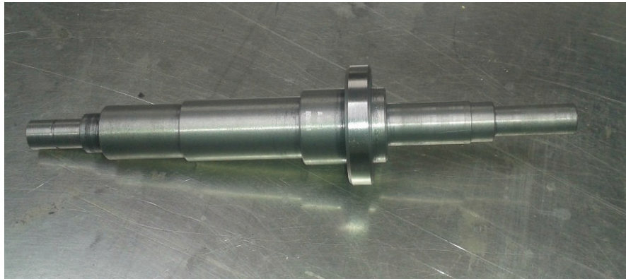
Figura B.8 Eje listo para los procesos de roscado y fresado del chavetero (Fuente: Propia)
