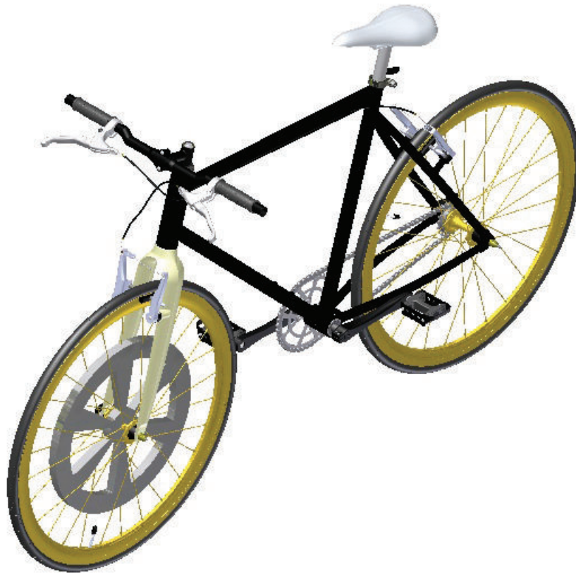
Figura 2.6 Acumulador cinético vertical en el eje delantero de la bicicleta
