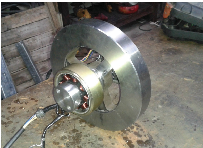
Figura B.16 Ensamble del sistema híbrido finalizado para ser montado en la estructura que va almacenar el mismo (Fuente: Propia)
