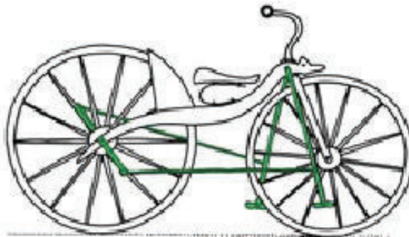
Figura 1.4 Esquema de la primera bicicleta con mecanismo de impulsión
