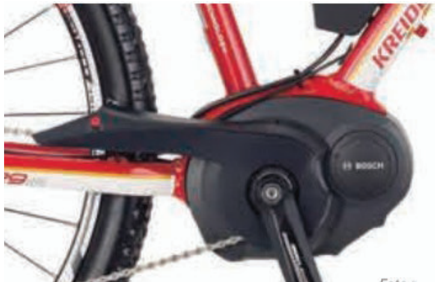
Figura 1.43 Motor Bosch acoplado en el pedalier de una bicicleta
