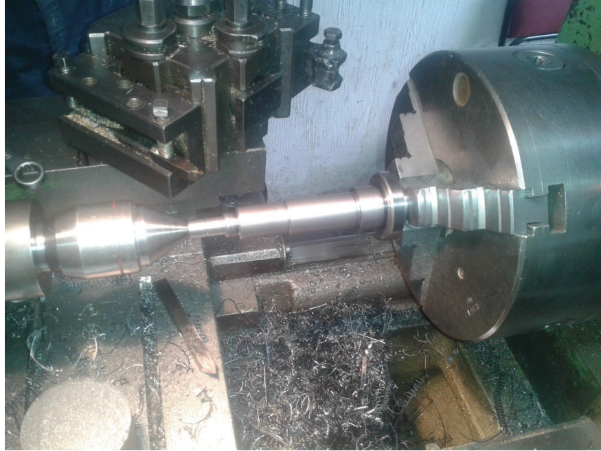
Figura B.7 Maquinado del eje para el sistema híbrido (Fuente: Propia)
