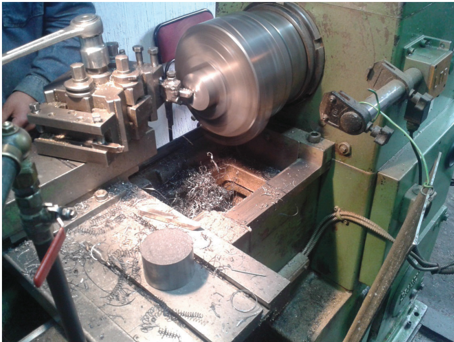
Figura B.10 Maquinado de los soportes que albergan al sistema híbrido
