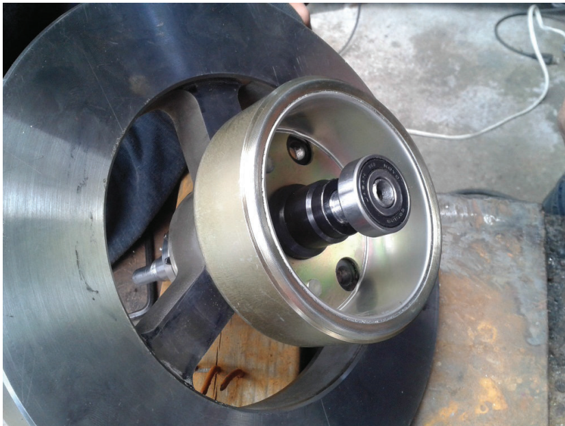
Figura B.14 Montaje de los rodamientos y volante de inercia en el sistema híbrido
