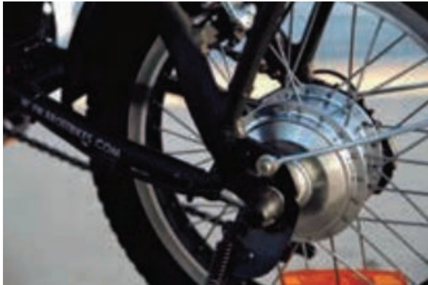
Figura 1.41 Motor Hub acoplado al buje de la rueda posterior
