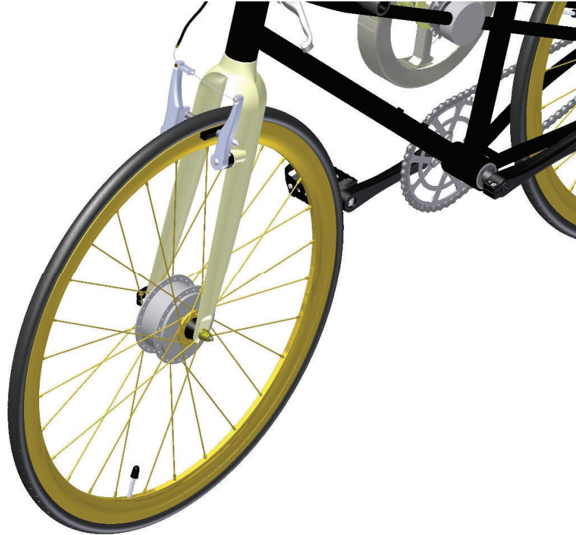
Figura 2.42 Motor HUB ensamblado en el buje de la llanta delantera
