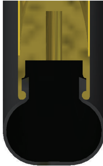
Figura 2.11 Corte transversal del neumático de bicicleta 28 x 1 5/8"
