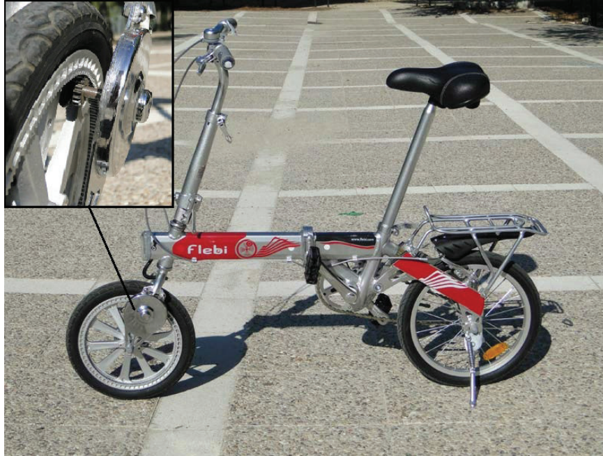
Figura 1.34 Bicicleta Flebi's original, el motor de 250 W transmite su potencia mediante un engrane directamente a la rueda
