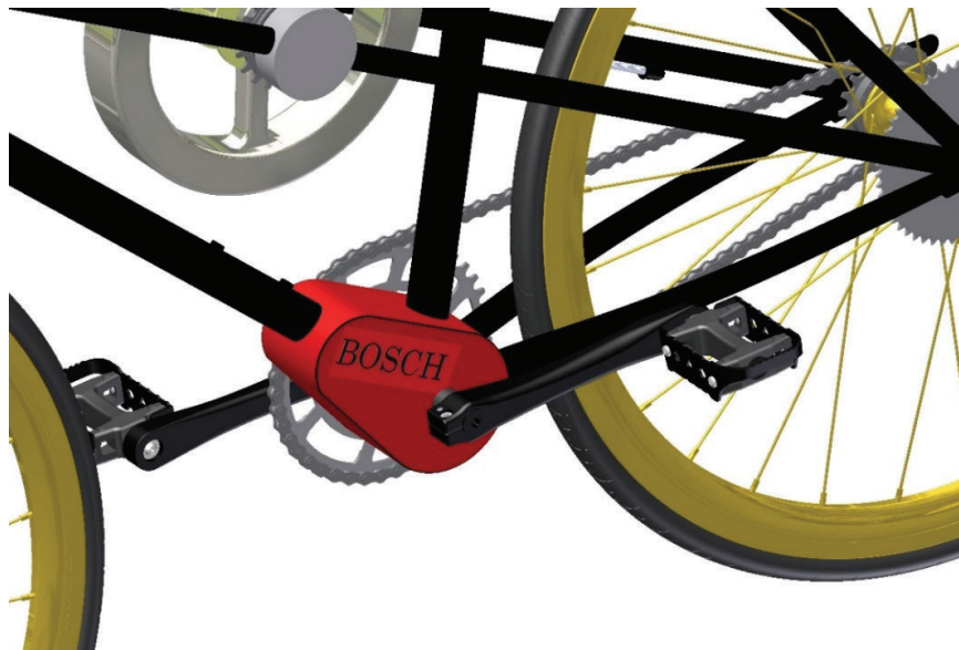
Figura 2.43 Motor pedalier en el eje del pedal de la bicicleta
