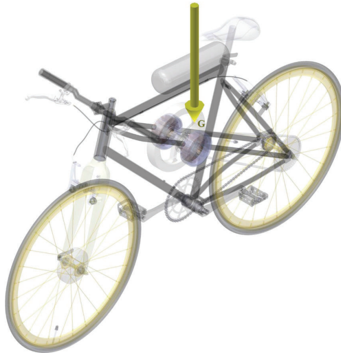
Figura 3.2 Obtención de la posición del centro de gravedad
