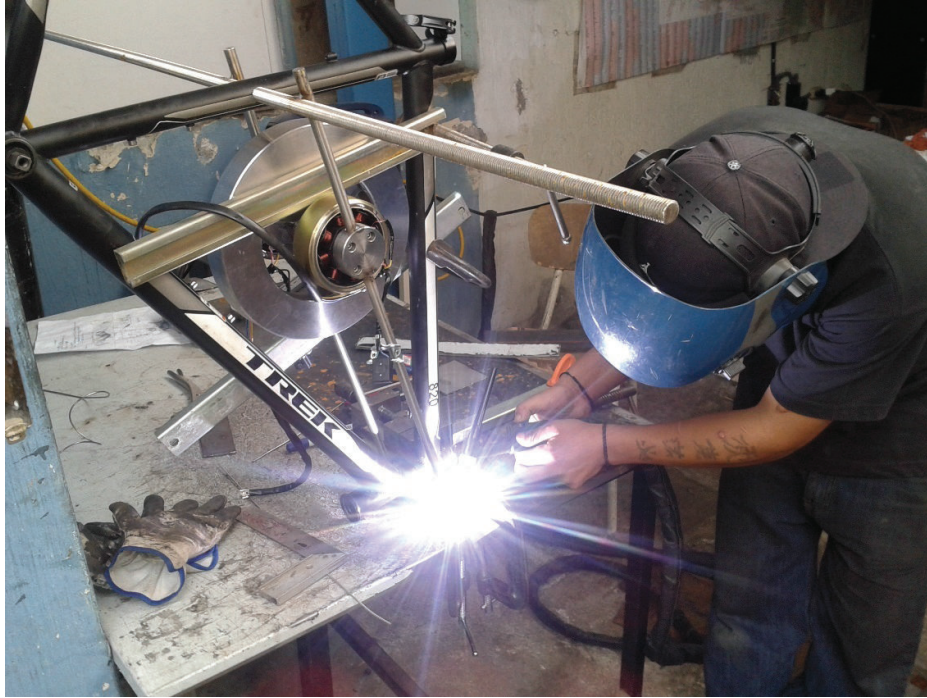
Figura B.17 Soldadura Tig para el soporte que va a albergar a todo el sistema híbrido (Fuente: Propia)
