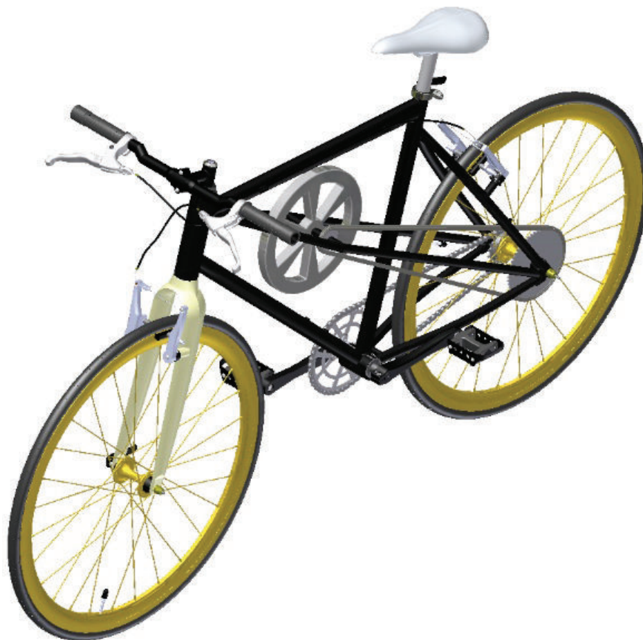
Figura 2.5 Acumulador cinético vertical en el cuadro de la bicicleta
