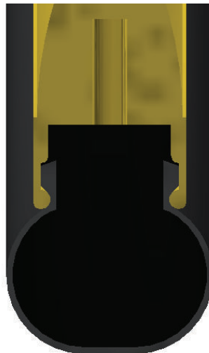
Figura 2.10 Corte transversal del neumático de bicicleta 28 x 1 5/8"
