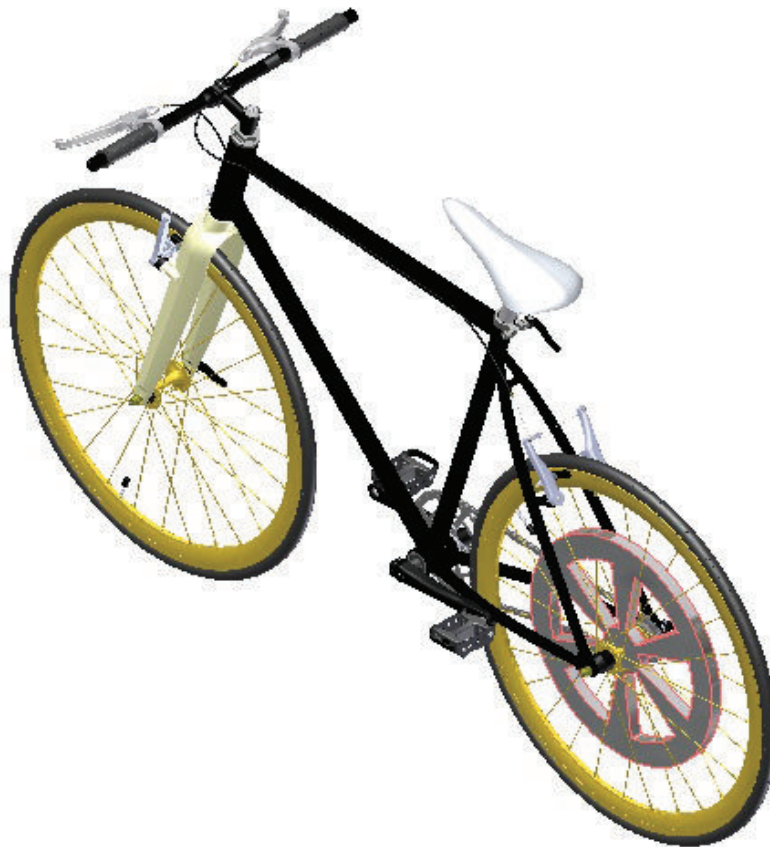
Figura 2.7 Acumulador cinético vertical en el eje posterior de la bicicleta
