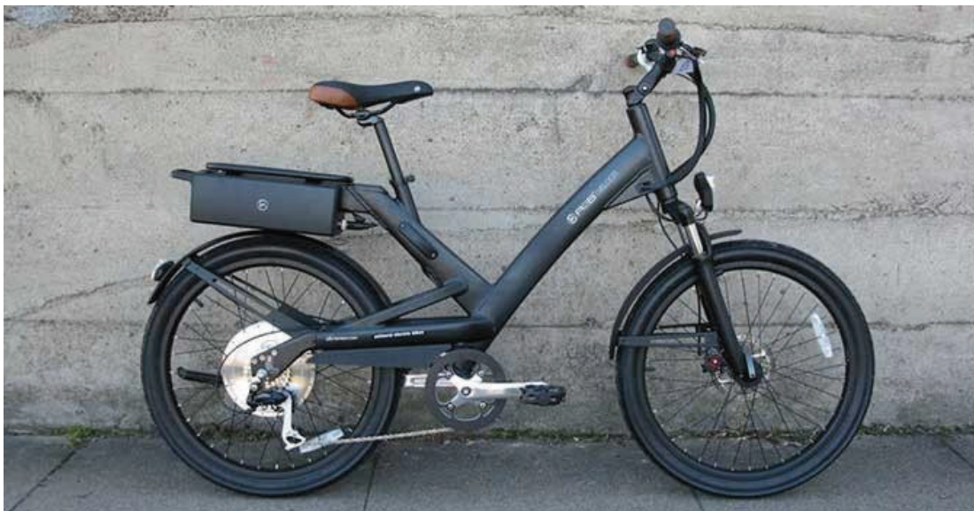
Figura 1.35 Bicicleta de Ashland electric bikes modelo A2B velocity, el motor de 450 W transmite su potencia directamente al buje (motor hub)
