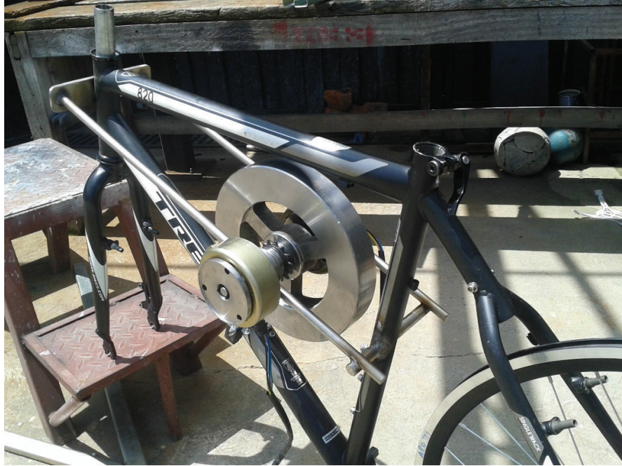
Figura B.19 Vista lateral del sistema híbrido volante de inercia y generadores de corriente (Fuente: Propia)
