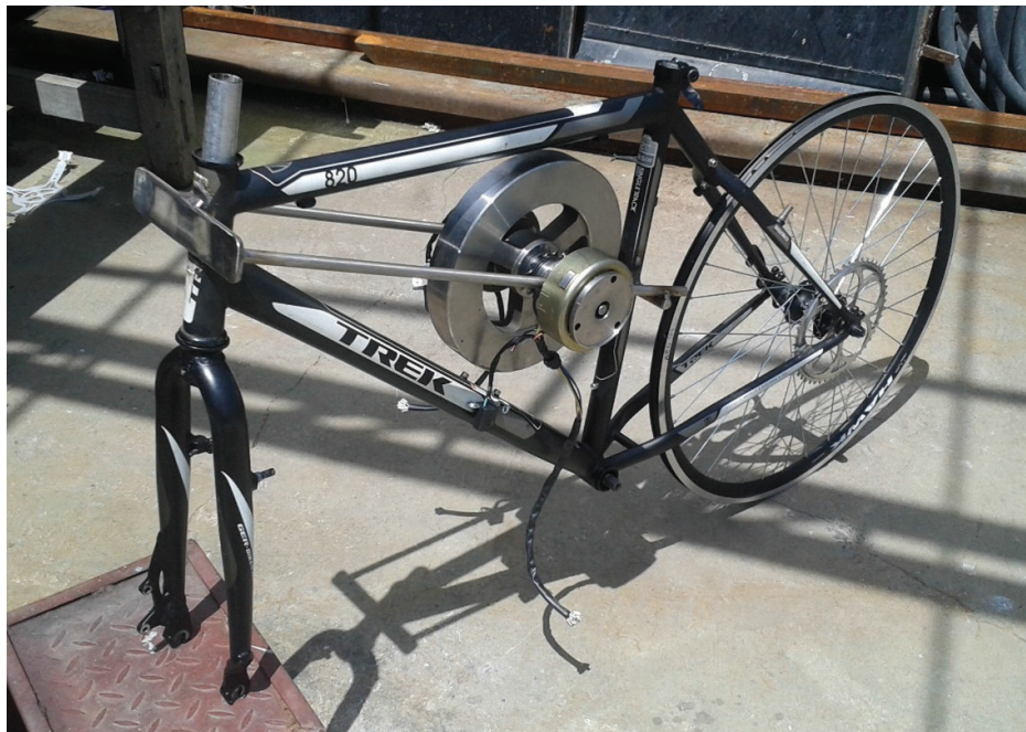
Figura B.18 Finalización de la construcción del sistema híbrido (Fuente: Propia)
