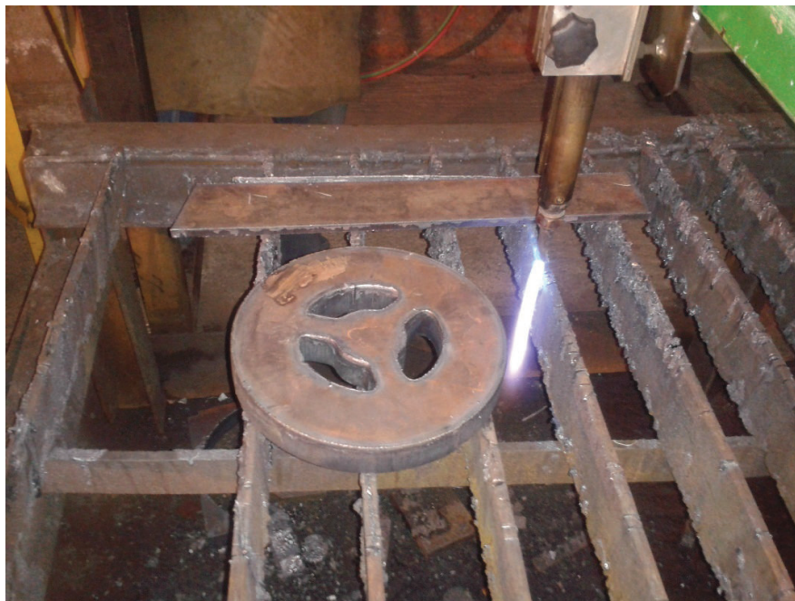
Figura B.2 Corte oxiacetilénico semiautomático del acumulador cinético (Fuente: Propia)
