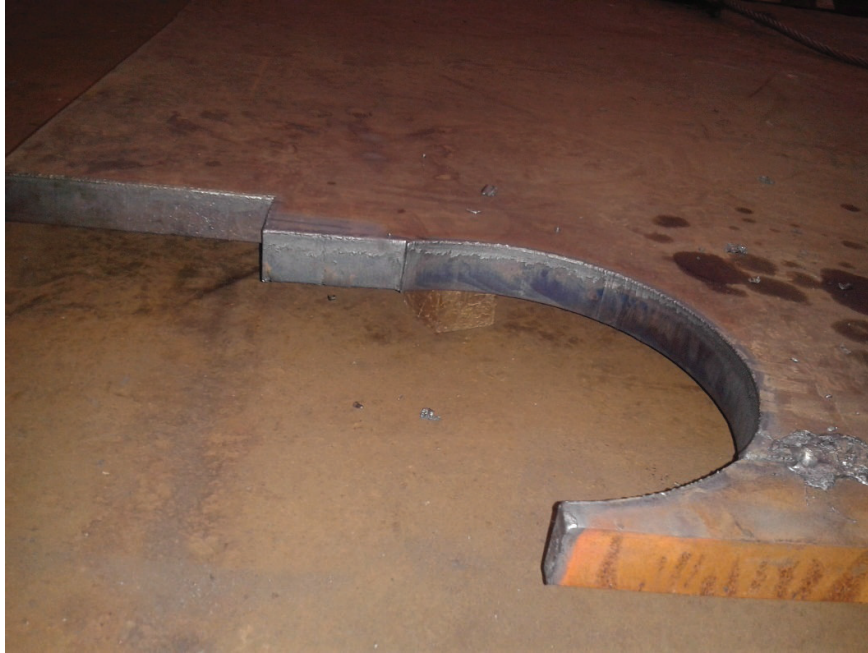
Figura B.1 Plancha de 1 ½" de Acero A36 para el acumulador cinético (Fuente: Propia)
