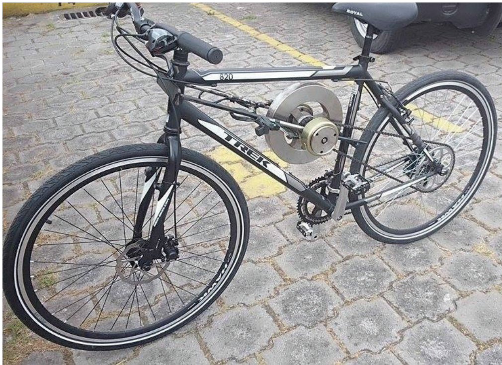
Figura B.20 Sistema híbrido en conjunto con todos los elementos de la bicicleta (Fuente: Propia)
