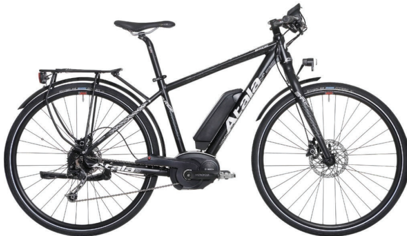
Figura 1.36 Bicicleta atala modelo B-Ride S 29” 9V, Equipada con equipo Bosch Performance Cruise 36V, 250W en el pedalier.
