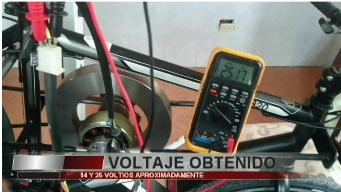
Figura B.21 Voltajes obtenidos entre 14 y 25 voltios con la prueba de un solo generador
