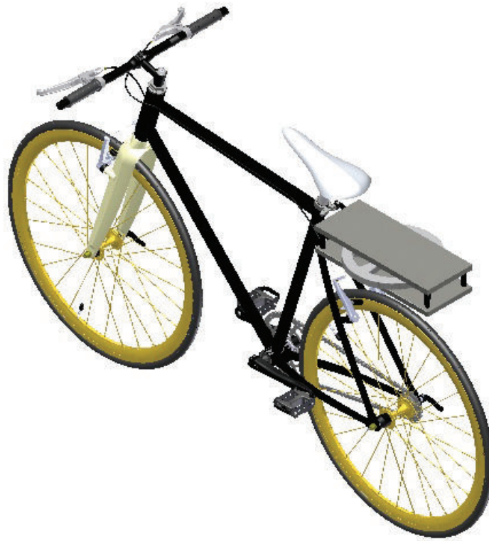
Figura 2.8 Acumulador cinético horizontal sobre la llanta posterior
