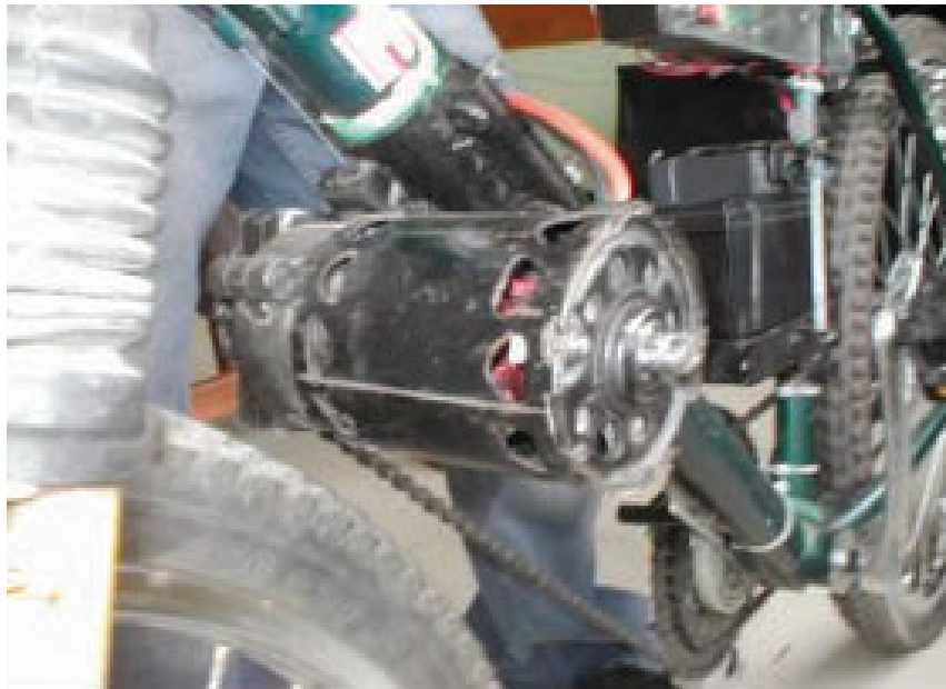
Figura 1.44 Motor de corriente continua acoplado al cuadro de una bicicleta
