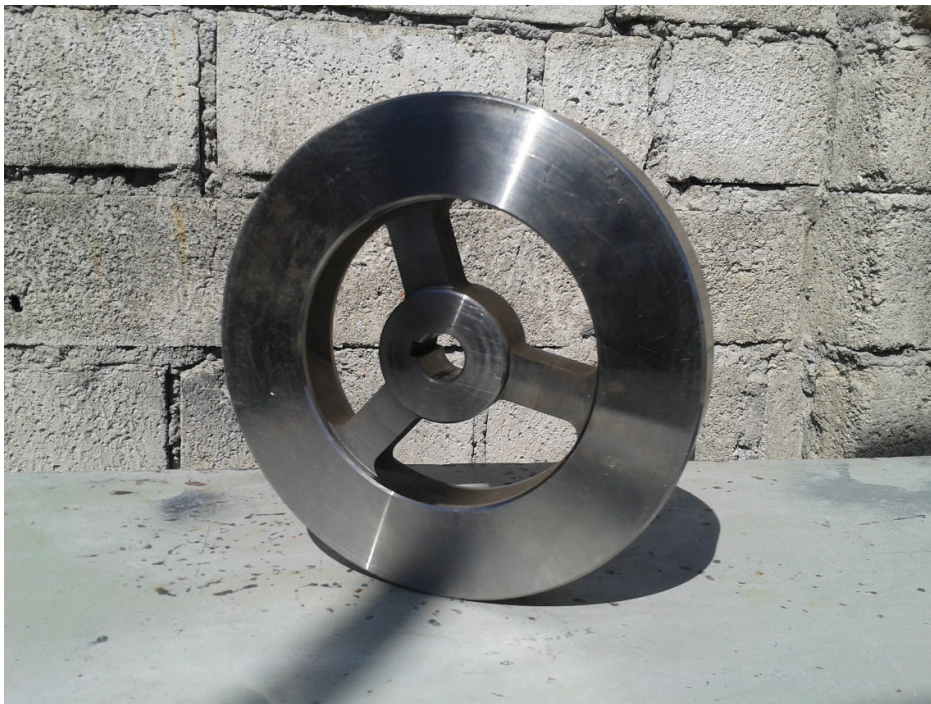
Figura B.6 Acumulador cinético finalizado para ser ensamblado en el sistema híbrido (Fuente: Propia)
