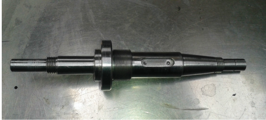
Figura B.9 Eje de transmisión finalizado para ser ensamblado los elementos parte del sistema híbrido
