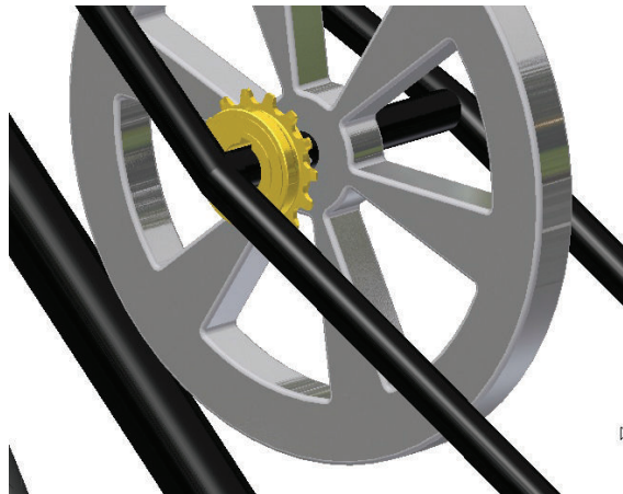
Figura 2.18 Ubicación del freewheel en el sistema de acumulador cinético
