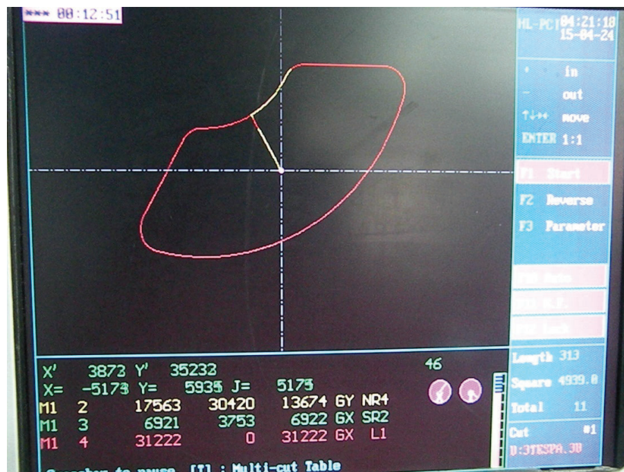
Figura B.4 Introducción de la región de seguimiento para el proceso de corte por hilo
