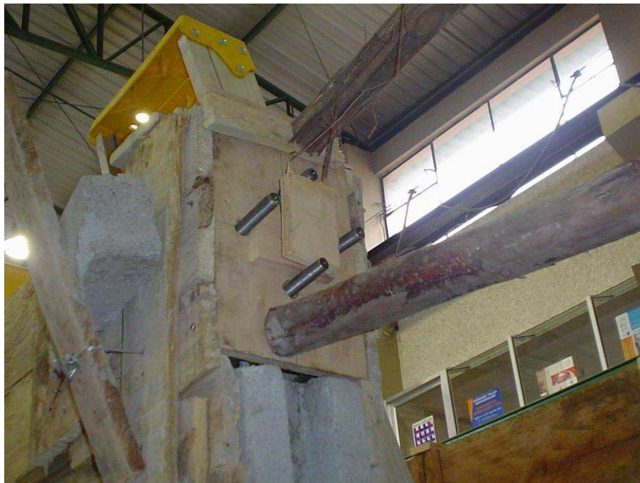
FIGURA 3.13 Alineamiento de ejes con equipo de carga.
