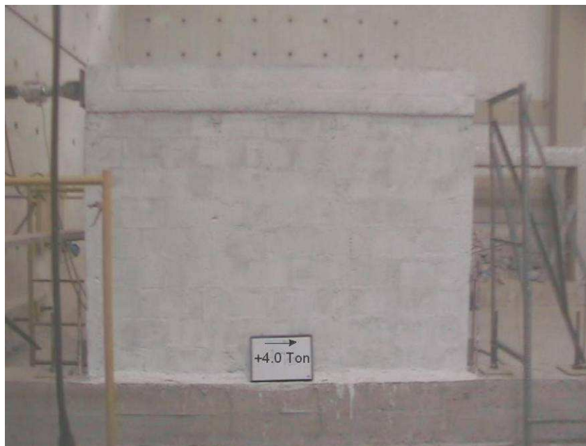
FIGURA 4.13 Cuarto ciclo de carga pared sin presencia de fisuras
