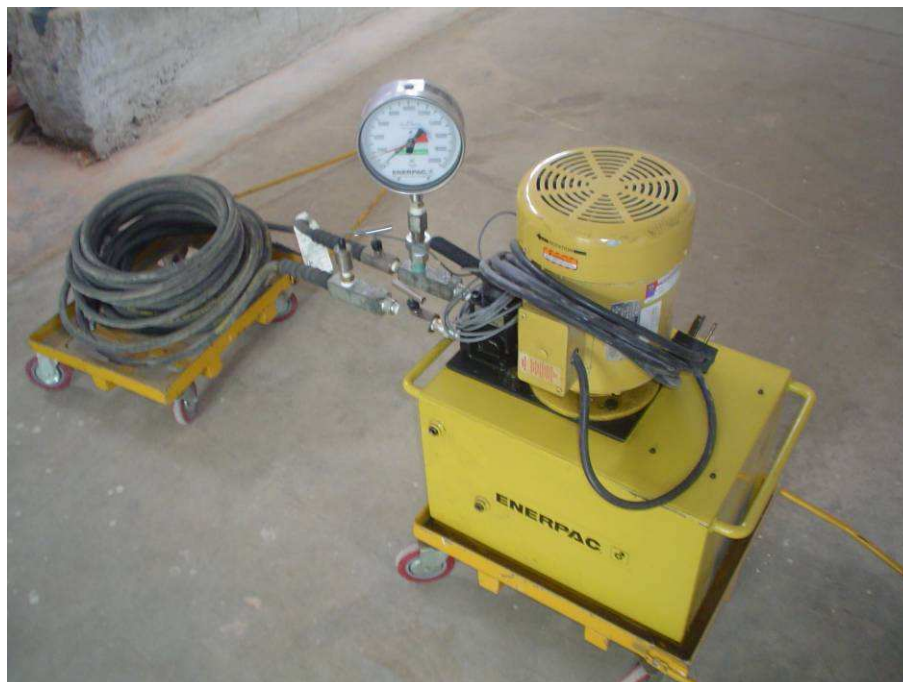
FIGURA 2.16 Bomba eléctrica ENERPAC con capacidad de 100 toneladas
