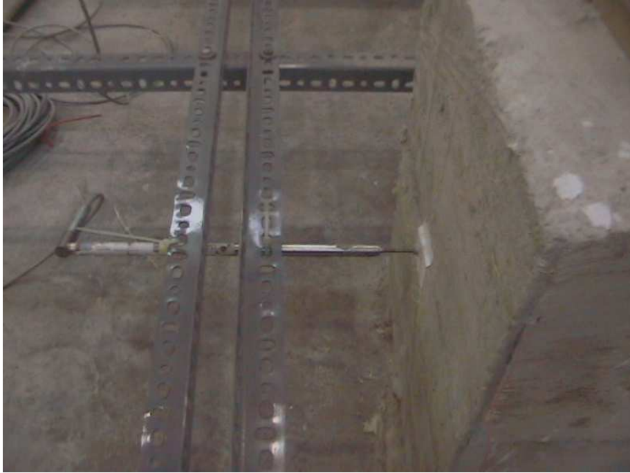
FIGURA 2.22 Posición de LVDT en cadena de cimentación.
