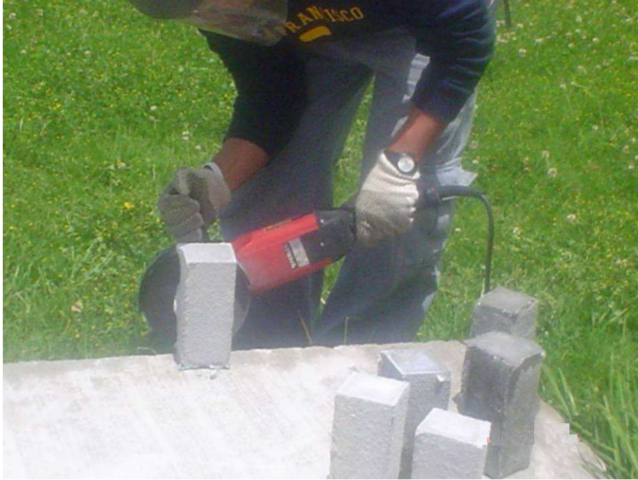
FIGURA 2.6 Preparación de prisma para ensayo a compresión
