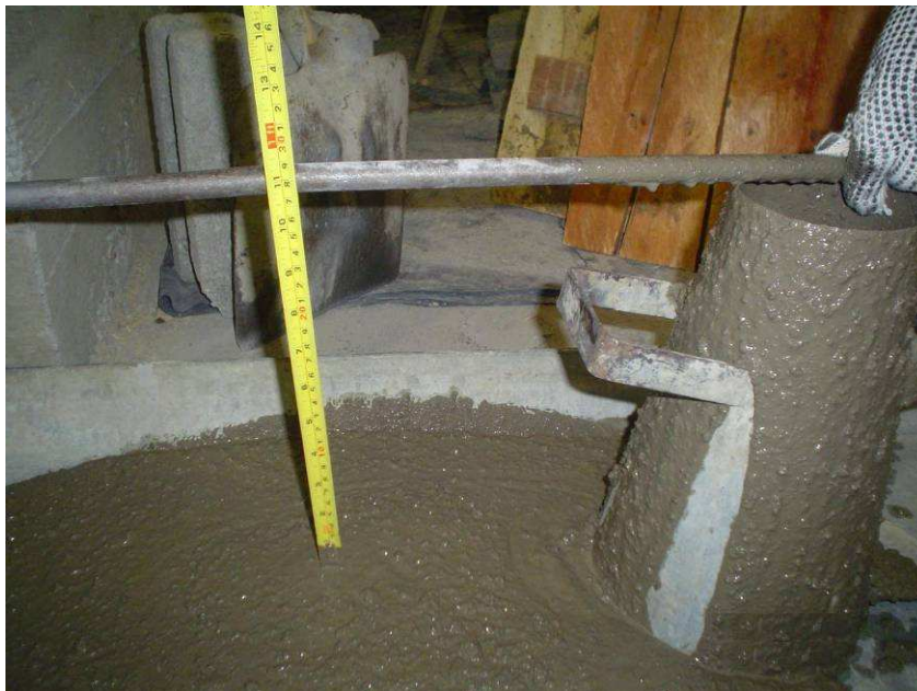
FIGURA 3.7 Cono de Abrams – control de fluidez del hormigón
