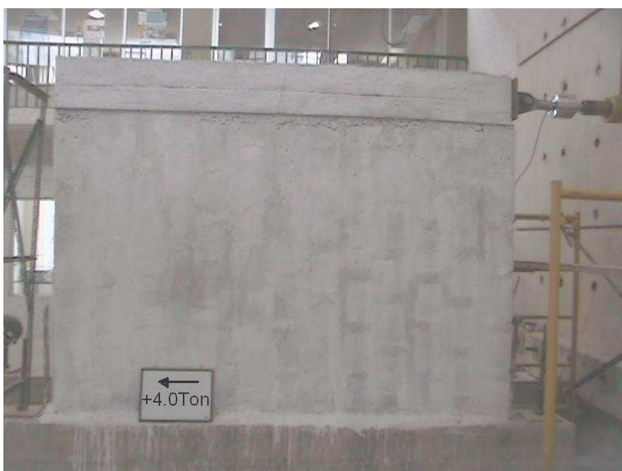
FIGURA 4.32 Aplicación de 4ton de carga positiva.
