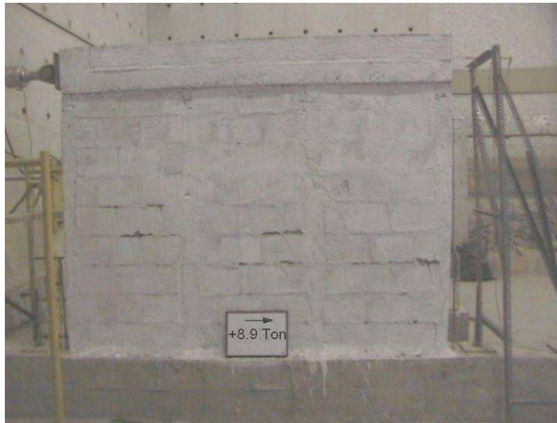
FIGURA 4.17 Fisuras en la pared a las 8,9 t de carga positiva.
