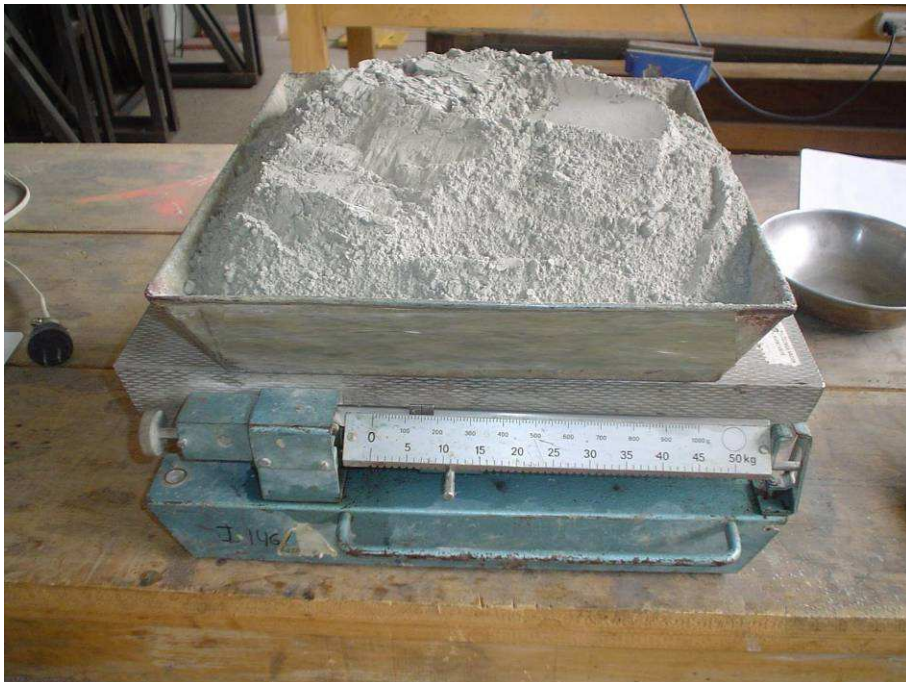
FIGURA 3.4 Dosificación al peso del cemento.
