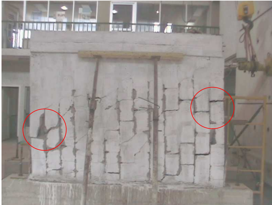
FIGURA 4.41 Pared totalmente ensayada
