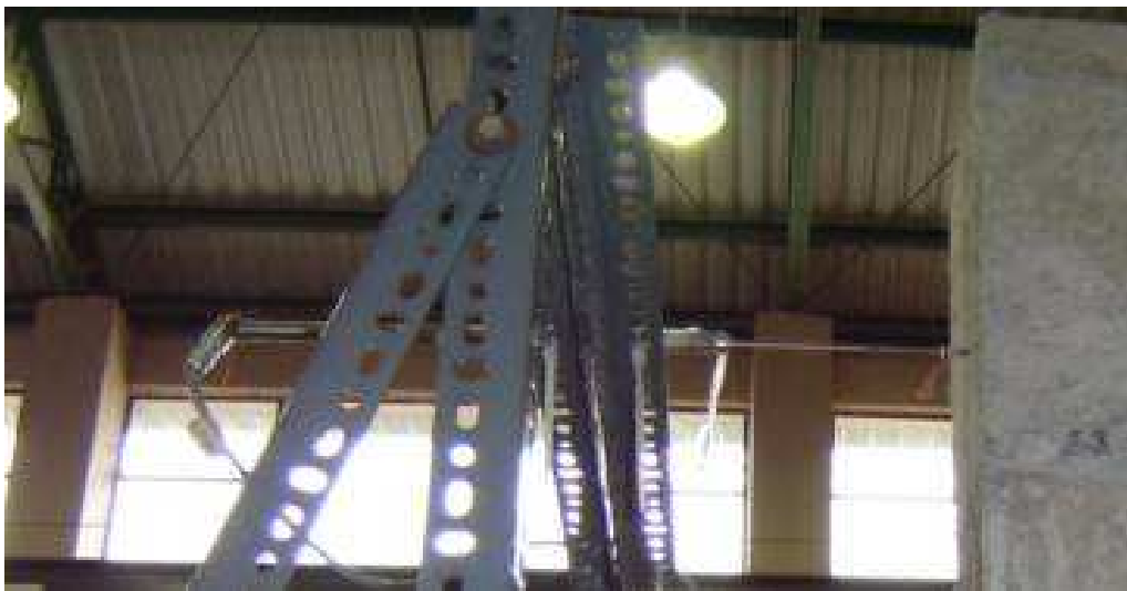
FIGURA 2.21 Posición de LVDT en viga superior de las mamposterías.
