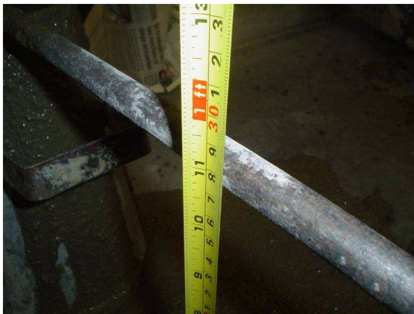
FIGURA 3.8 Cono de Abrams – control de asentamiento del hormigón (27 cm)
