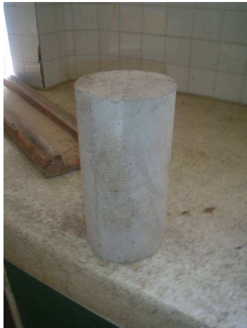
FIGURA 3.23 Cilindro estándar para el ensayo del hormigón.
