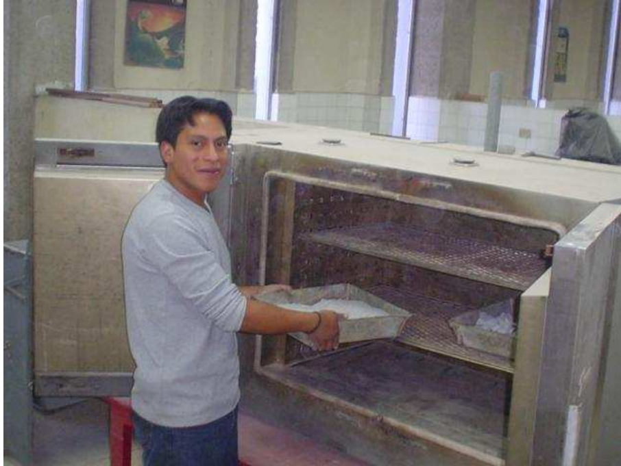
FIGURA 2.13 Horno para secado de agregados en el proceso de dosificación
