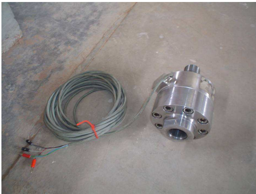
FIGURA 2.19 Celda de carga HBM-KRAFTAUFNEHMEP FORCE TRANSDUCER con capacidad de 200 KN 2mv/V y el acople.
