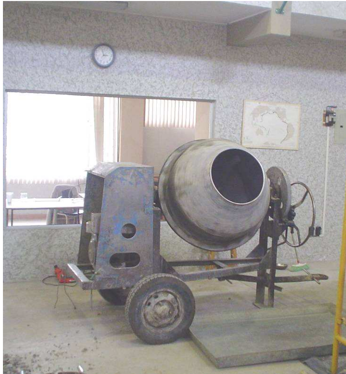
FIGURA 2.9 Concreteira para mezclar el hormigón.
