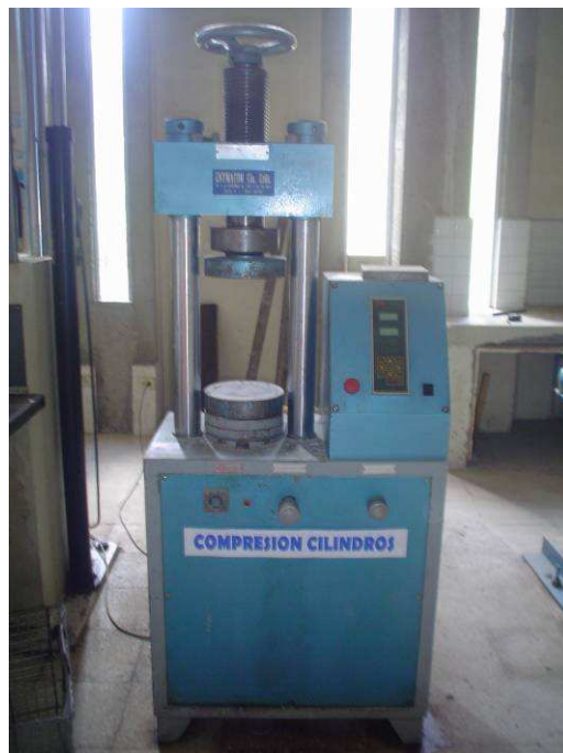
FIGURA 2.14 Máquina para realizar los ensayos a compresión de muestras (prismas y cilindros).
