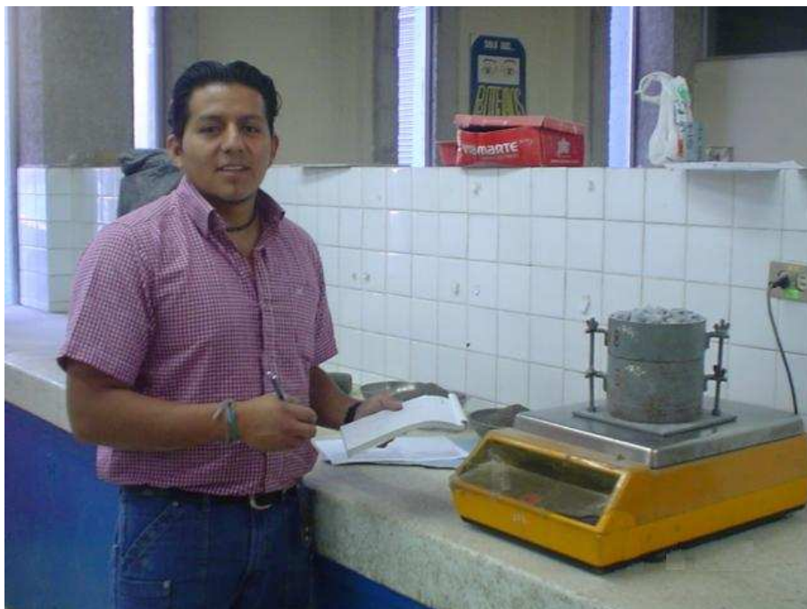
FIGURA 2.12 Balanza de precisión para pesar todas las muestras
