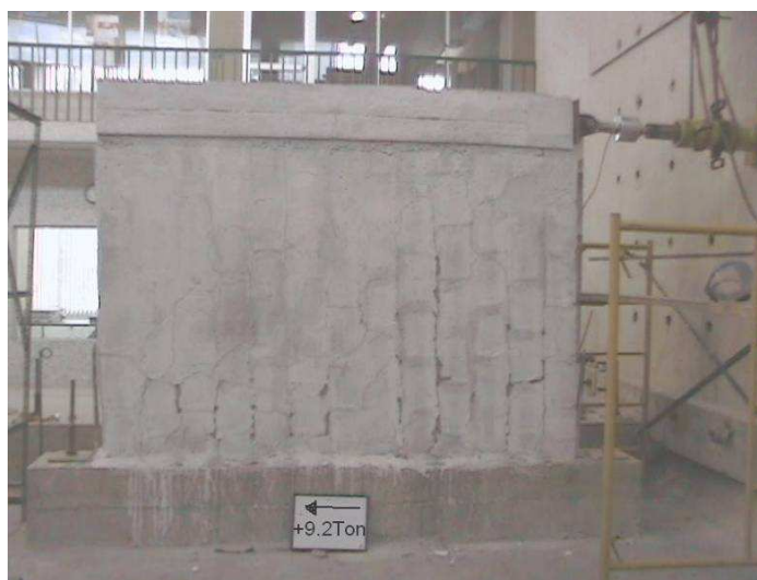
FIGURA 4.38 Fisuras en la pared a las 9,2 t de carga positiva agotamiento de la pared
