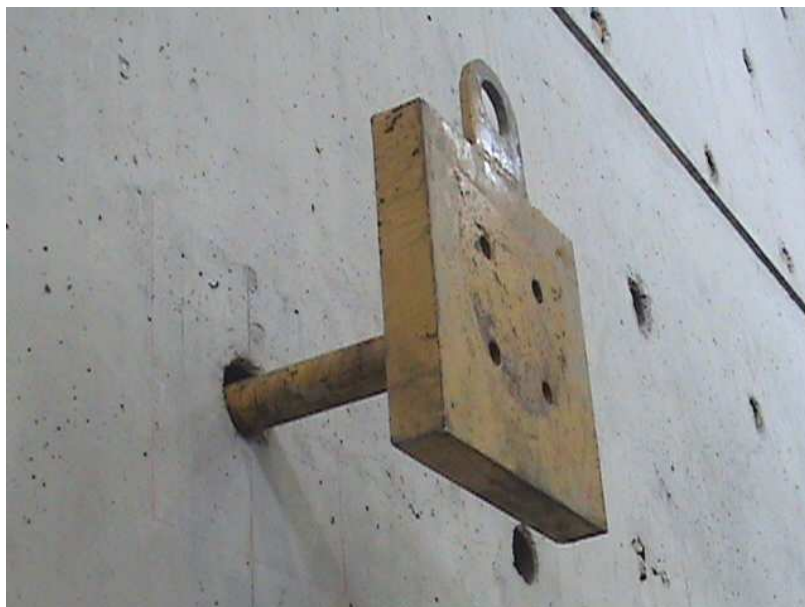
FIGURA 4.4 Placa de reacción del dispositivo de carga
