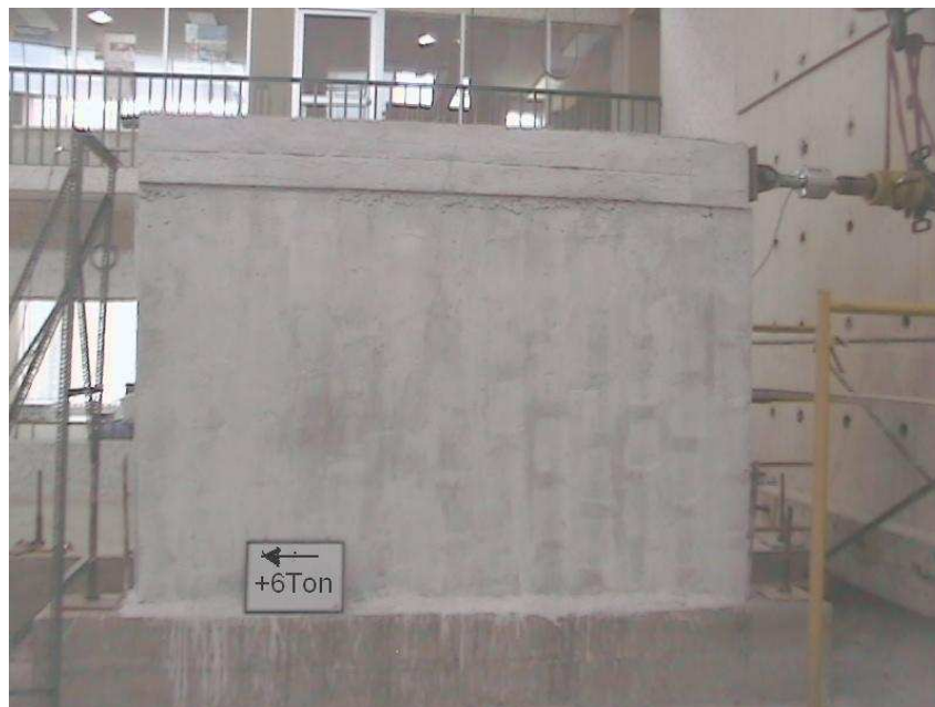
FIGURA 4.33 Pared Aplicando 6 t de carga positiva
