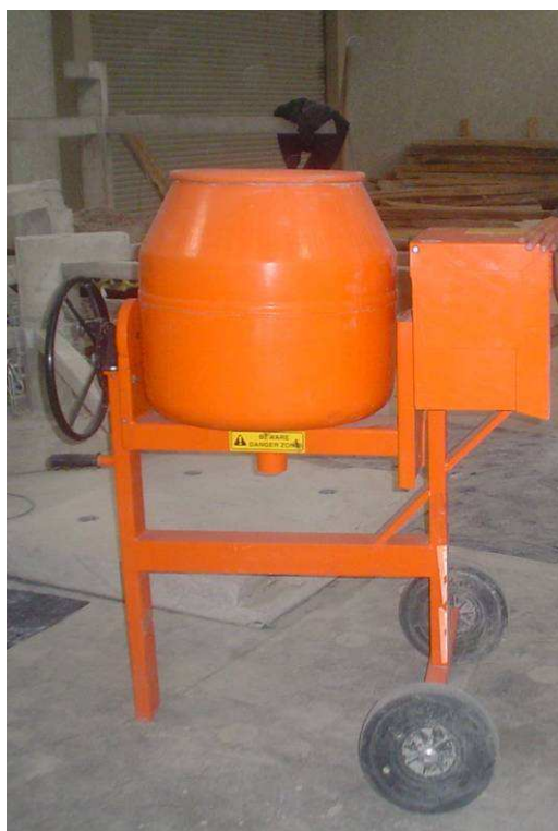
FIGURA 2.8 Concretera para mezclar el hormigón líquido.
