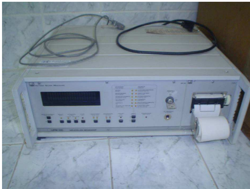
FIGURA 2.24 Sistema UPM100 HBM de 80 canales para recopilación y procesamiento de datos de carga y deformación de manera digital para lo que se utilizó el software CATMAN.
