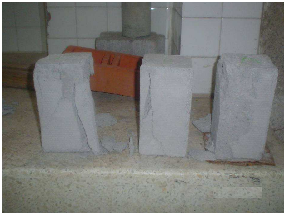
FIGURA 2.7 Falla por carga a compresión en prismas.
