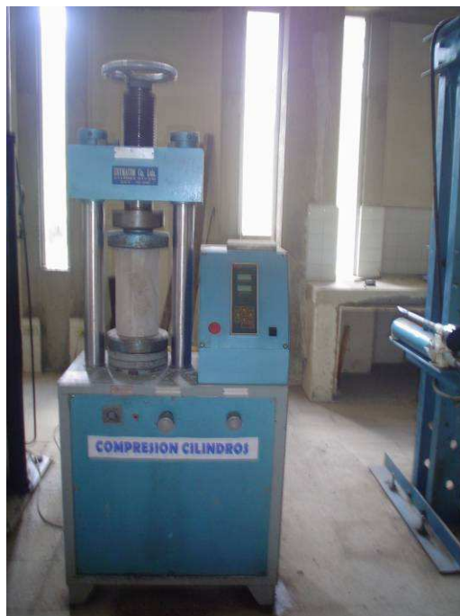
FIGURA 3.24 Ensayo a compresión para determinación de f'_c .
