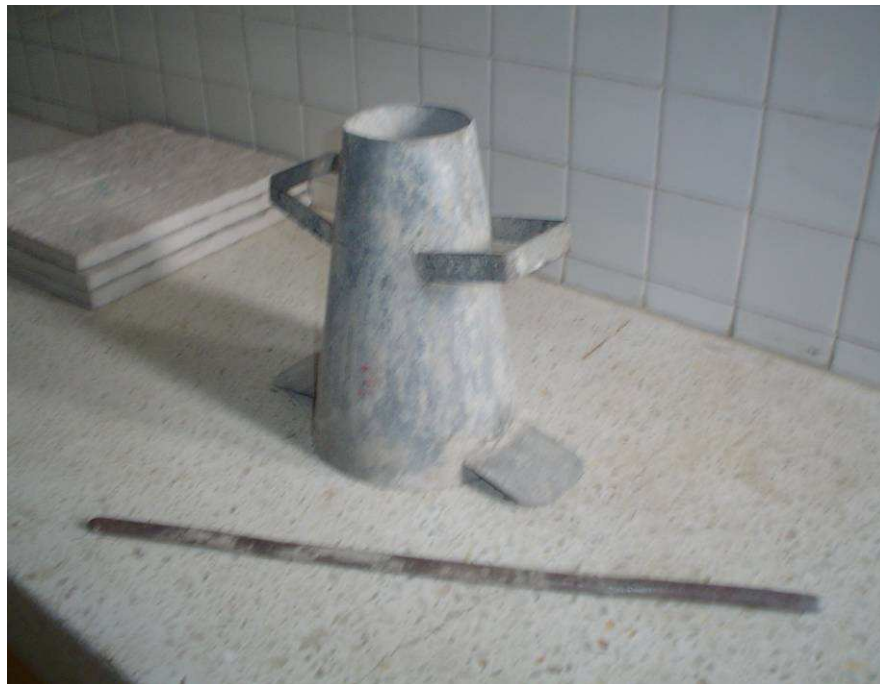
FIGURA 2.10 Cono de Abrams, sirve para realizar la prueba de asentamiento.
