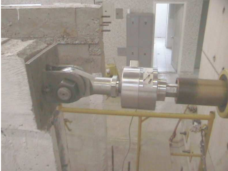
FIGURA 4.11 Aplicación de Carga Lateral a la Pared
