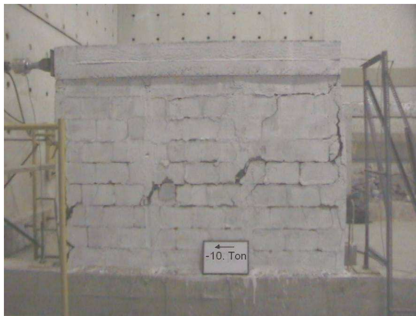
FIGURA 4.17 Fisuras en la pared a las 8,9 t de carga positiva.
