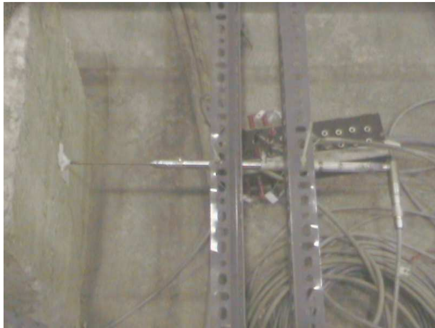
FIGURA 4.9 LVDT en viga inferior
