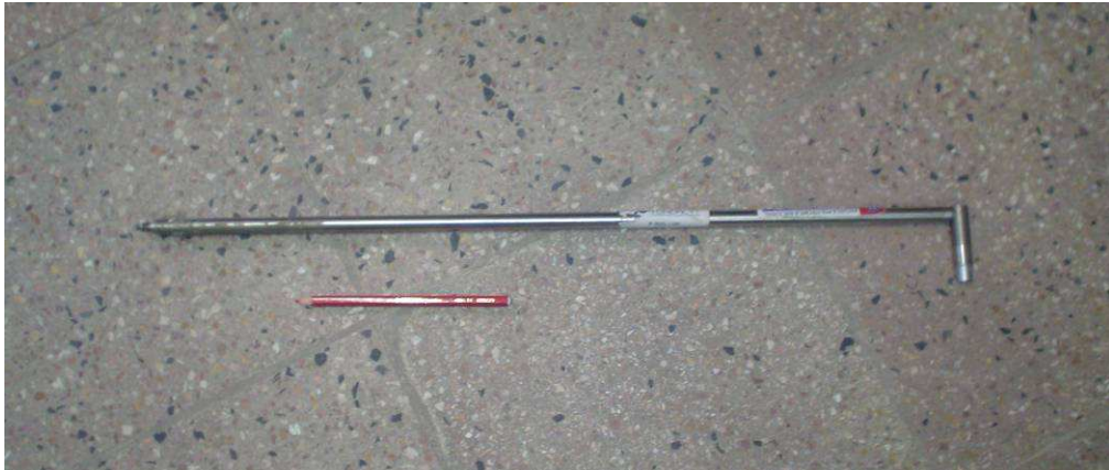
FIGURA 2.20 LVDTs HBM de 100 mm - 80 mv/V (Traductores de Desplazamiento Lineal Variable), sirven para medir deformaciones).
