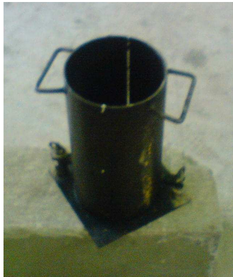
Fotografía 2.11: Moldes para cilindros de hormigón.
