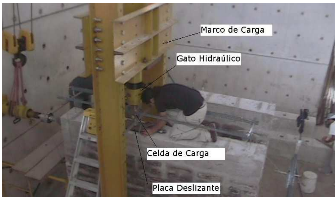
Fotografía 3.15: Dispositivo de aplicación de carga vertical con sus elementos.
