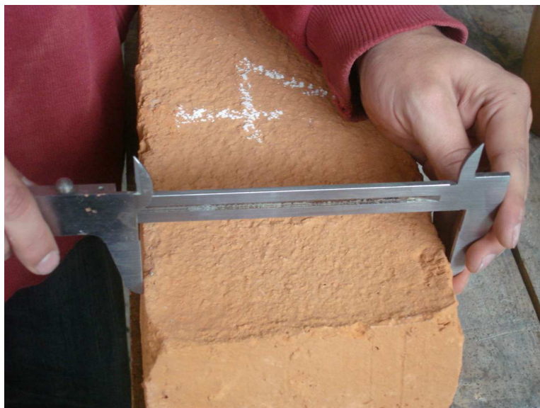
Fotografía 3.2: Toma de dimensiones de los mampuestos.
