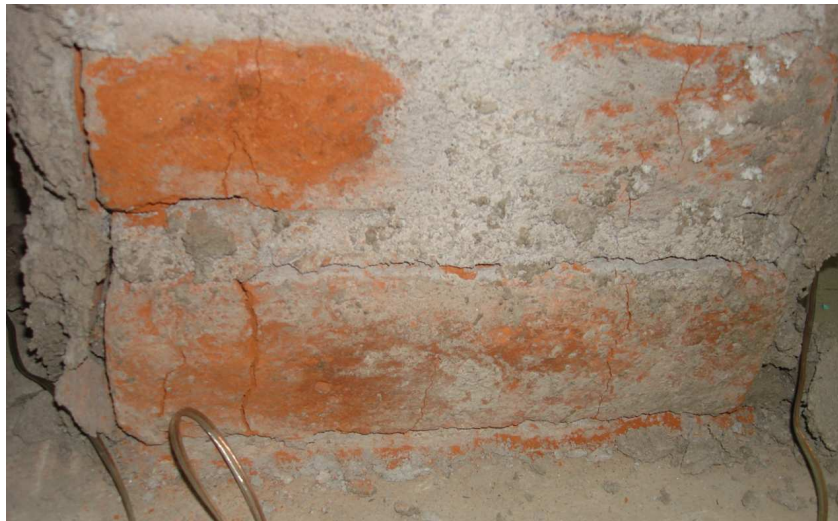
Fotografía 5.16: Fisuras en el interior de la pared las 30 t de carga positiva
