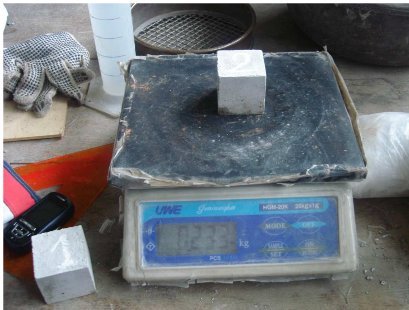
Fotografía 3.7: Medición del peso de los Cubos Standard de mortero de pega con ayuda de una balanza electrónica.
