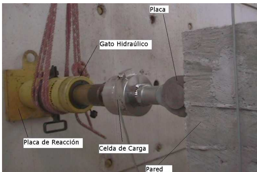
Fotografía 5.2: Dispositivo de aplicación de carga lateral con sus elementos.
