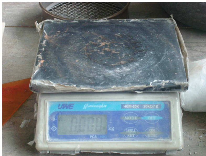
Fotografía 2.12: Balanza de precisión, para pesar todas las muestras.
