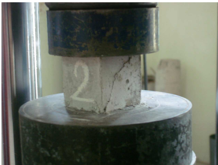
Fotografía 3.8: Ensayo de compresión del mortero de pega a los 28 días.
