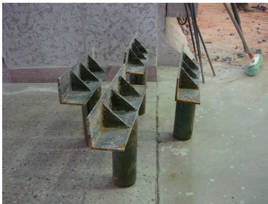
Fotografía 2.9: Apoyos antideslizantes tipo Tee de acero.
