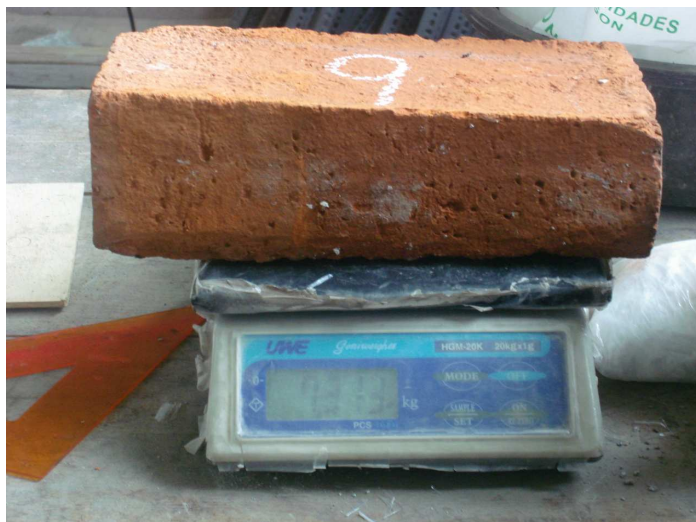
Fotografía 3.3: Medición del peso de los mampuestos con ayuda de una balanza electrónica.
