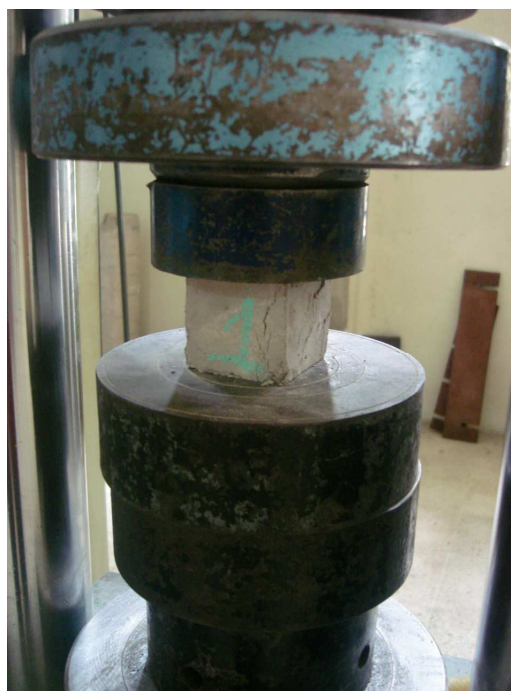
Fotografía 3.10: Ensayo de compresión del mortero de enchape los 28 días.
