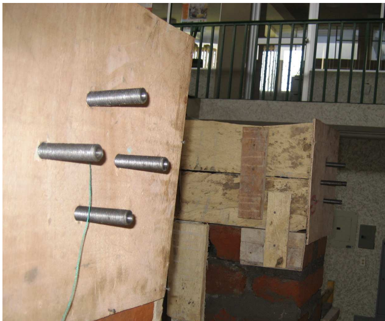
Fotografía 4.13: Vista lateral de las varillas transmisoras de carga.
