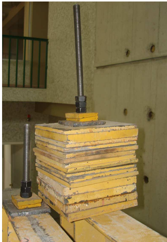
Fotografía 5.20: Dispositivo para aplicar tensión en las varillas de acero consta de 18 placas ubicadas sobre la viga superior.
