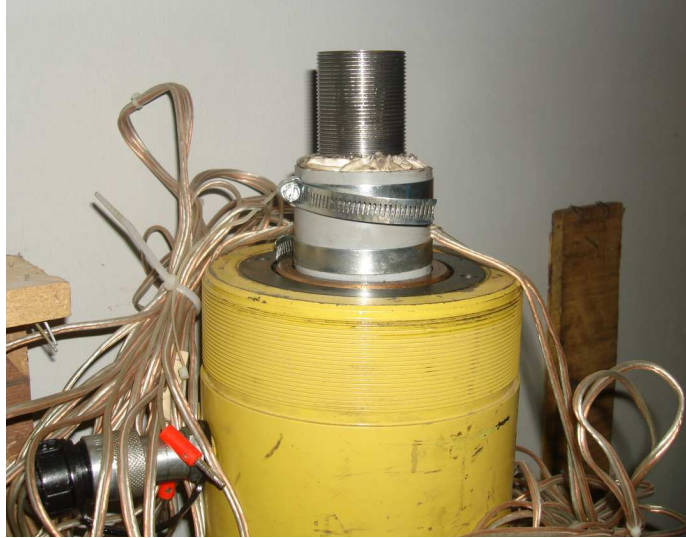
Fotografía 2.6: Celda de Carga construida por el personal del Centro de investigación de la Vivienda de la EPN.
