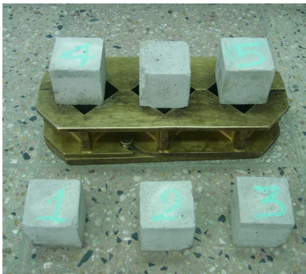
Fotografía 3.9: Cubos Standard de mortero de enchape para la prueba de compresión.
