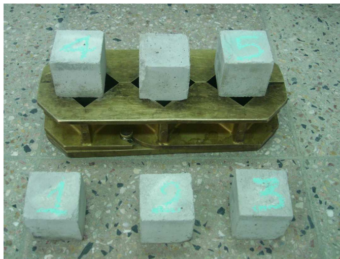
Fotografía 4.23: Probetas de mortero de enchape.
