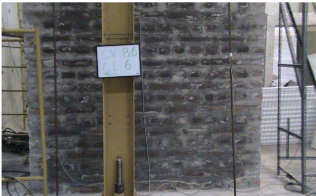
Fotografía 5.4: Pared lista para el ensayo, ubicación de tensores en los extremos.
