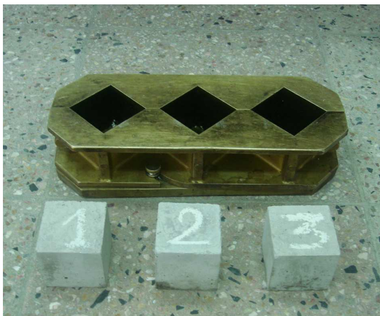
Fotografía 3.6: Cubos de mortero de pega Standard para la prueba de compresión.
