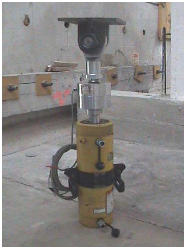
Fotografía 2.5: Dispositivo de transmisión de carga armado completamente.
