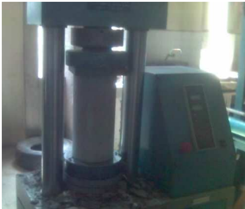
Fotografía 4.17: Procedimiento de ensayo de determinación del f'c . A los 28 días de toma de la muestra.
