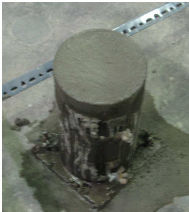
Fotografía 3.4: Cilindro Standard para realizar el ensayo sobre el hormigón de las vigas superiores.
