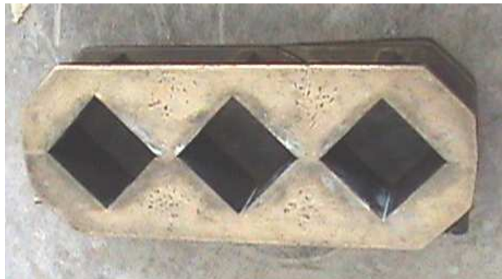
Fotografía 2.14: Moldes metálicos para tomar las muestras de mortero.
