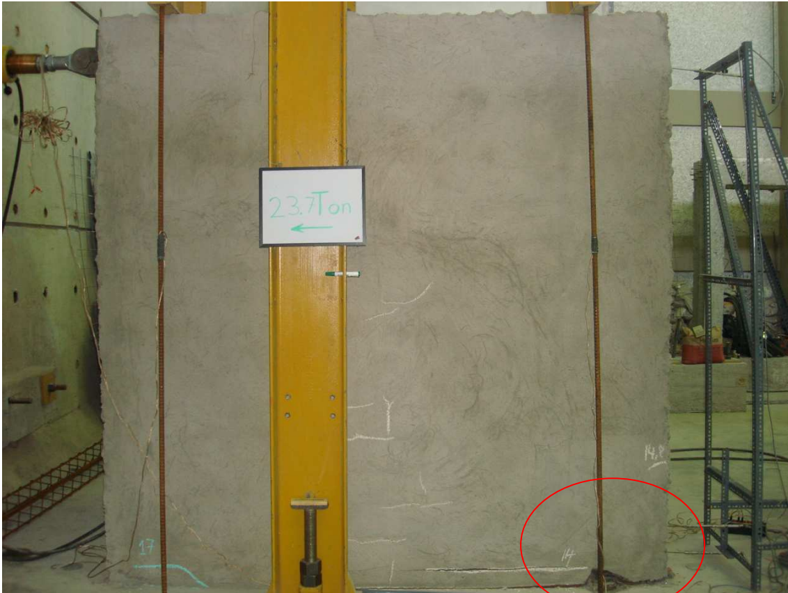
Fotografía 5.13: Efecto de volcamiento (levantamiento de la pared)
