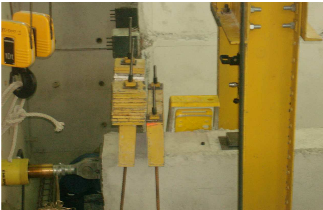
Fotografía 5.23: Ubicación final de los tensores, ensayo unidireccional (Aplicación de la Carga lateral en un solo sentido).
