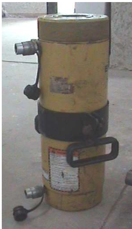
Fotografía 2.1: Gato hidráulico de carga cíclica con capacidad de 20 T.
