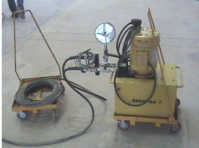
Fotografía 2.2: Bomba eléctrica ENERPAC con capacidad de 100 Toneladas.
