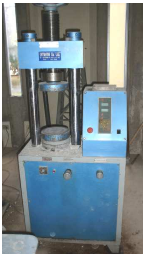
Fotografía 2.13: Máquina para realizar los ensayos a compresión de las muestras (prismas y cilindros).
