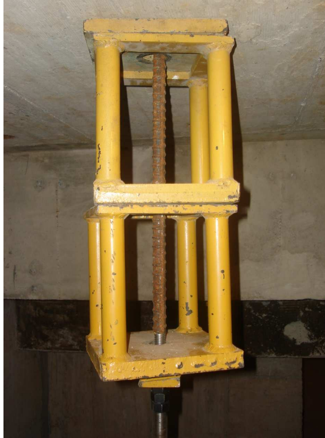
Fotografía 5.21: Dispositivo para aplicar tensión en las varillas (mesas de acero) ubicadas bajo la losa de reacción del laboratorio.
