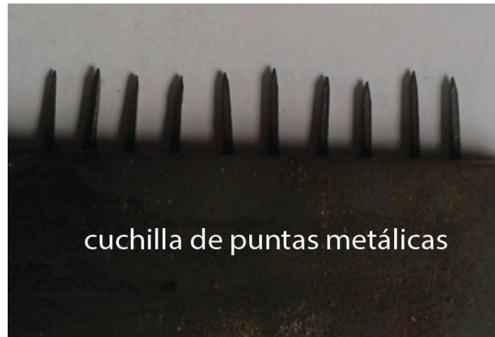
FIGURA 3.2 ENSAYO - 2 CUCHILLAS DE PUNTAS METÁLICAS
