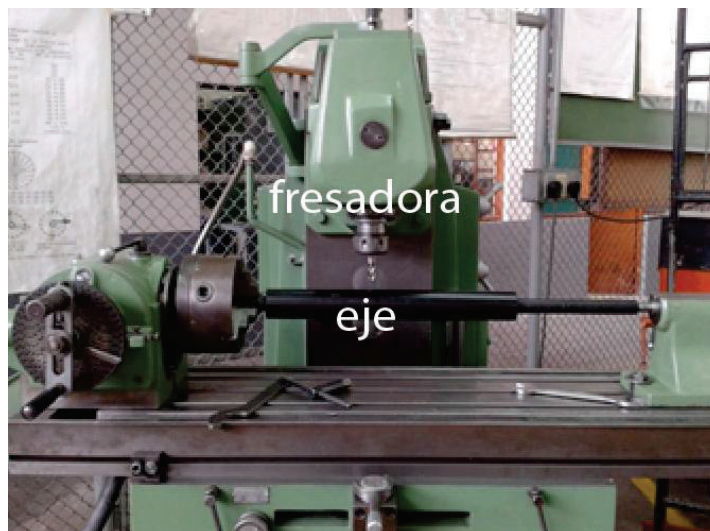
FIGURA 4.2 FRESADO DE CANALES PARA CUCHILLA EN EJE DE GRILÓN
