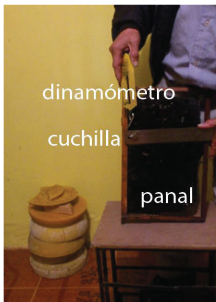
FIGURA 3.4 DETERMINACIÓN DE LA FUERZA NECESARIA PARA EL CORTE
