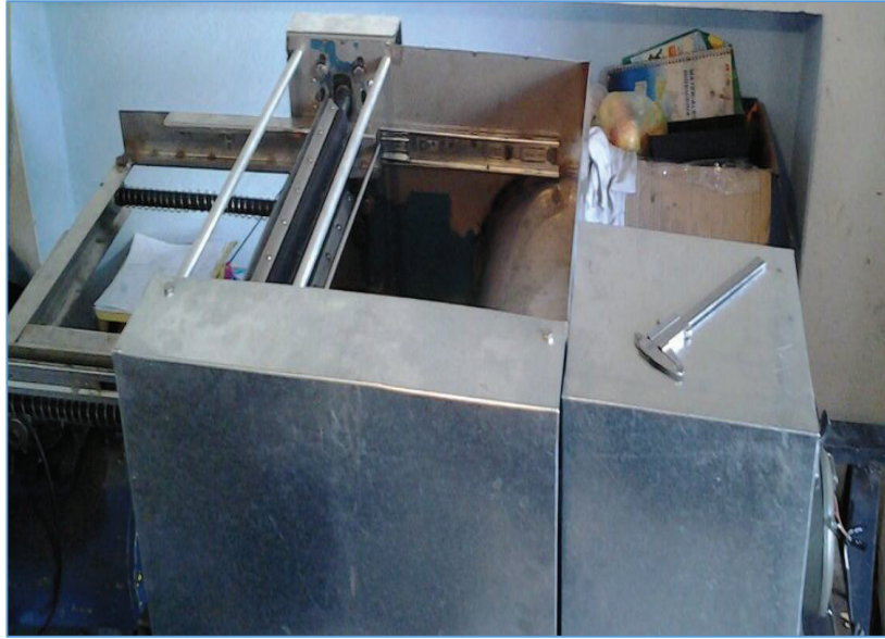
FIGURA 4.8 MÁQUINA ENSAMBLADA CON PROTECCIONES DE SEGURIDAD
