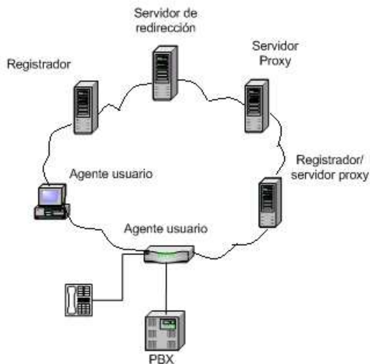
Figura 1.12: Cliente SIP y Componentes del Sistema del Servidor. [2]
