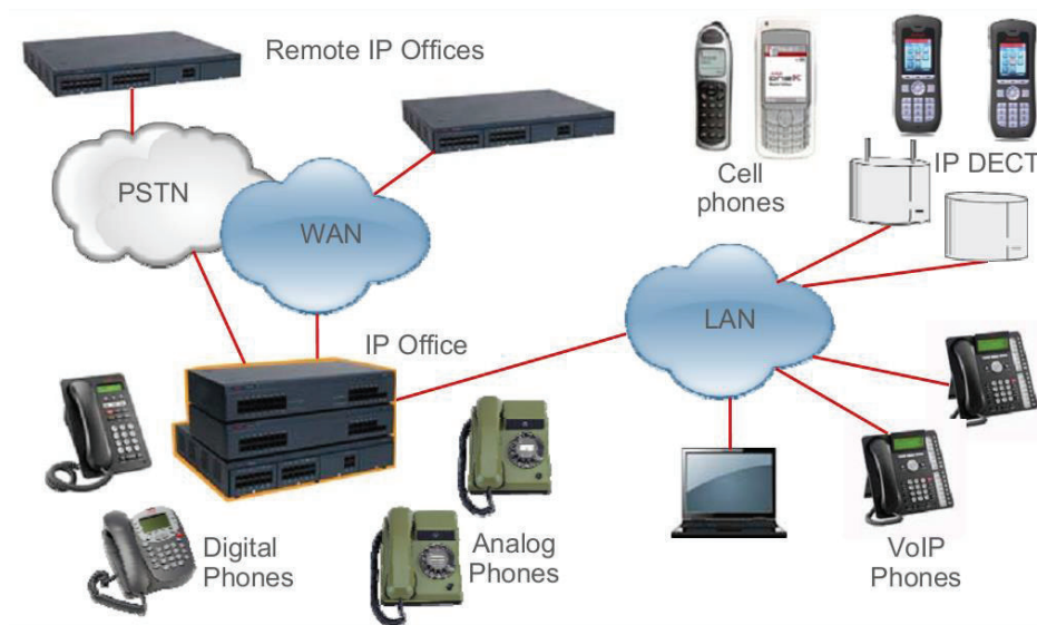
Figura 1.9 Entorno de comunicaciones IP Office [6]
