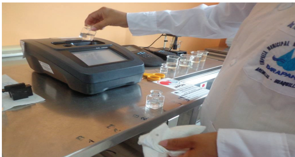
Fig. AIII.2. Medición de hierro total en las soluciones estándar (1 mg/l, 2 mg/l y 3 mg/l)
