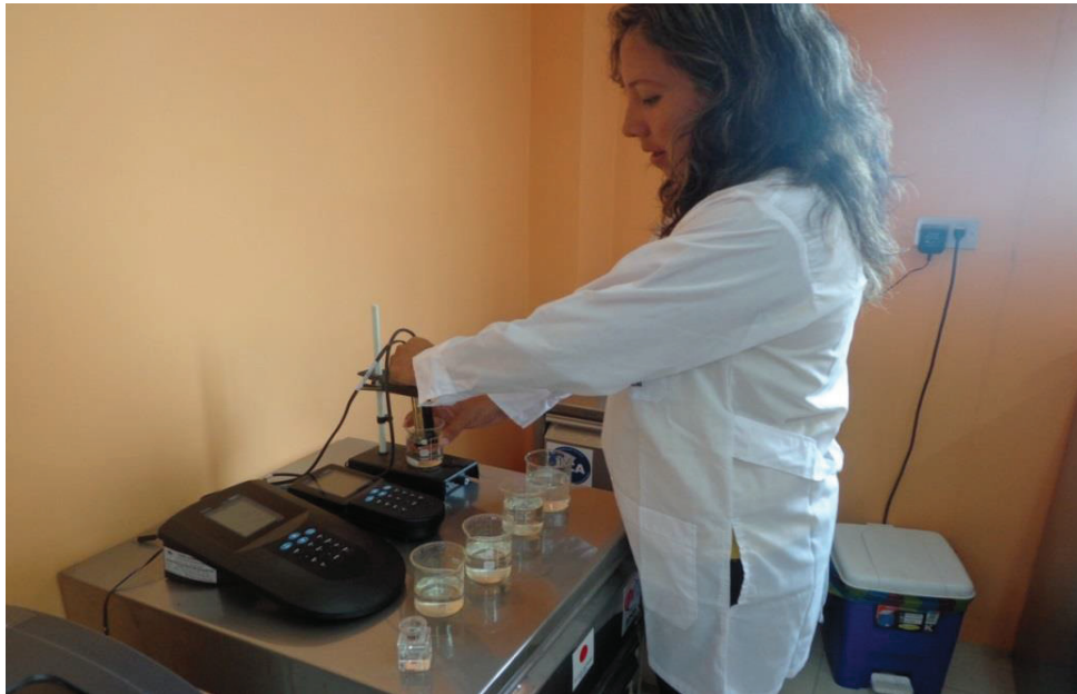
Fig. AIII.1. Medición de pH en los soluciones estándar (4, 7 y 10)
