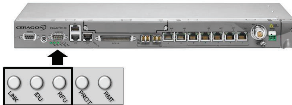
Figura 3.11 Estado de los leds del equipo
