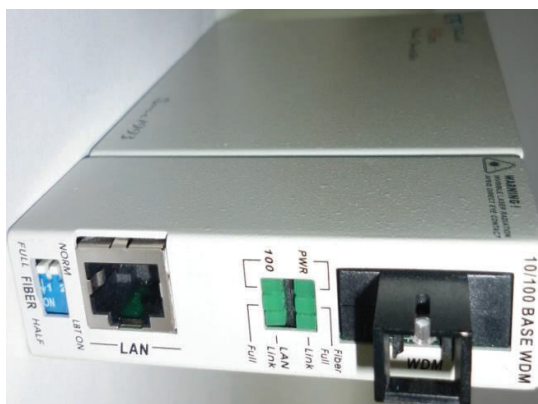
Figura 3.18 Conversor de F.O. marca CTC
