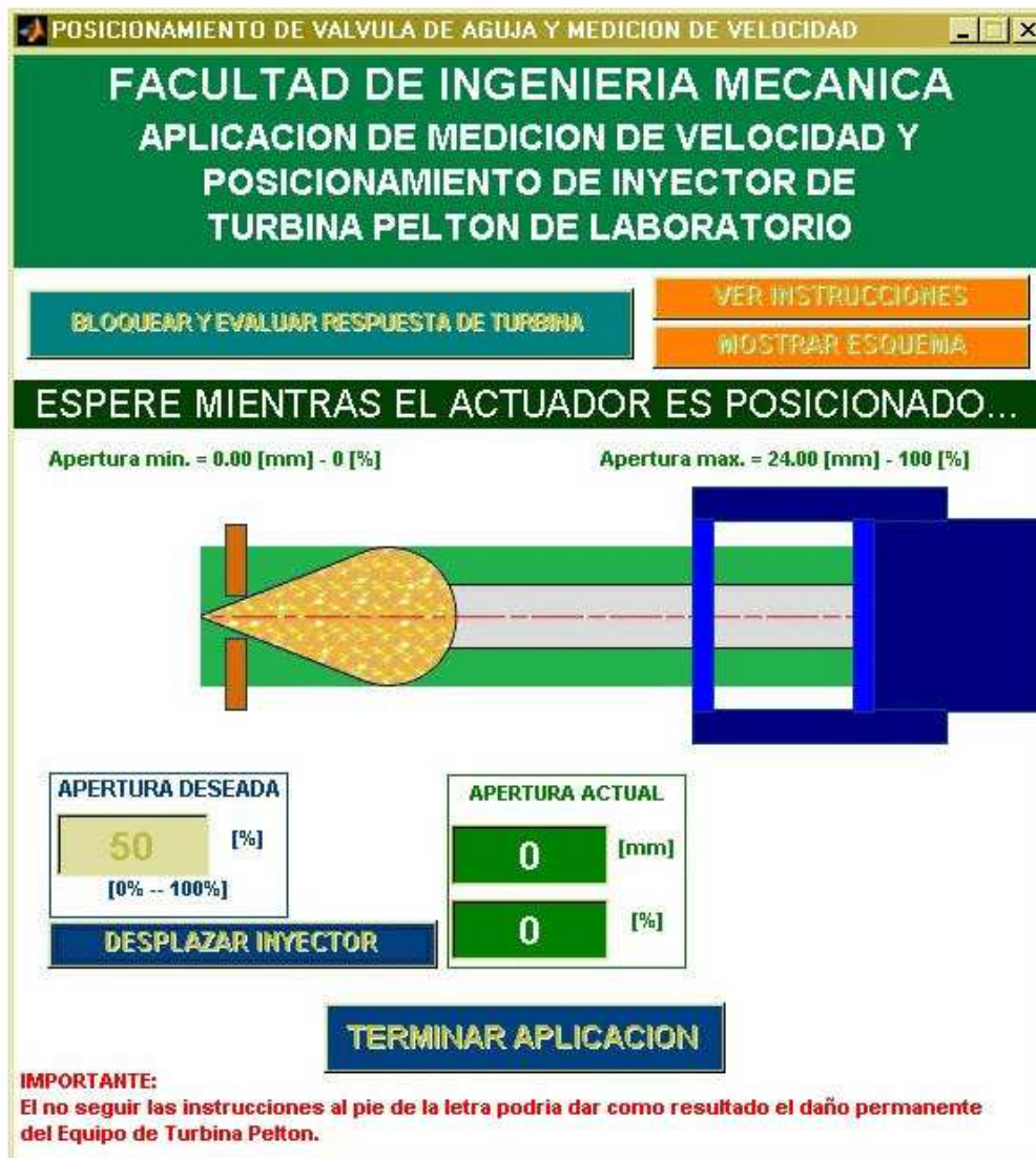
Figura 1.18. Interfaz bloqueada mientras se posiciona el actuador en el 50% de apertura de inyector.
