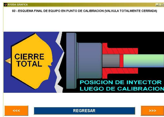
Figura 1.33. Esquema de actuador e inyector después de finalizar el proceso de calibración.
