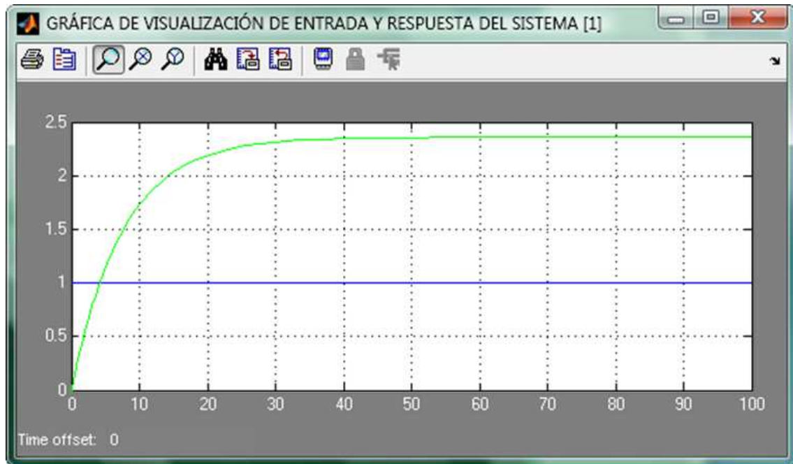
Figura 4.10. Respuesta del sistema a una entrada tipo escalón en lazo abierto, en unidad [1] (por unidad) – N_1 [1] vs. Z [1]
