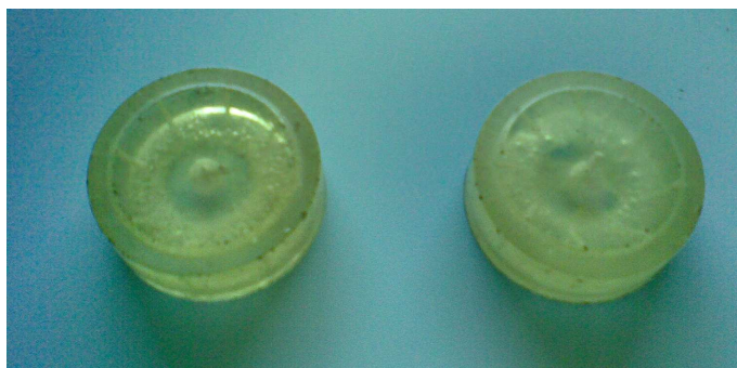
Figura 2.1 Moldes macho de resina.
