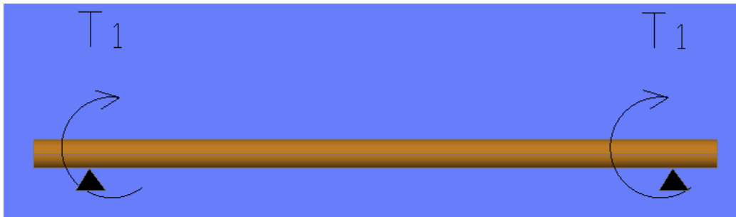
Figura 3.22 Cargas a las que está sometido el segundo eje.
