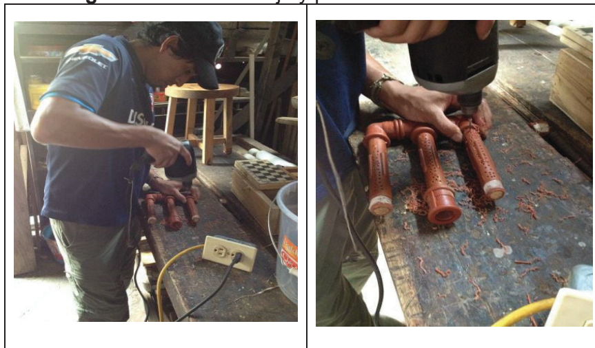
Figura 4-1.- Ensamblaje y perforación de la tubería
