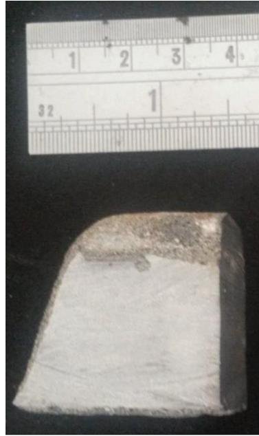
**Figura 6.3** Probeta para ensayo metalográfico
