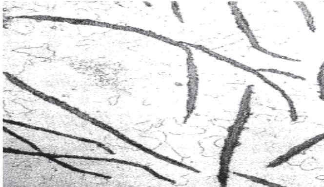
**Figura 1.2** Fundición gris ferrítica<sup>7</sup>
