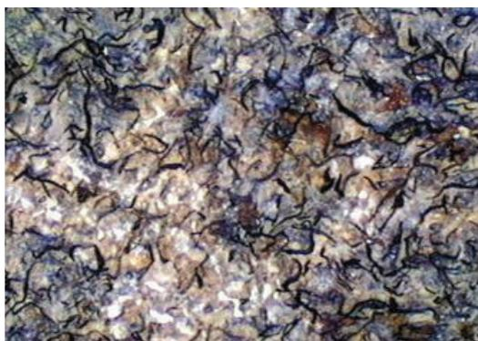
**Figura 1.6** Micrografía a 200 aumentos, cementita<sup>17</sup>
