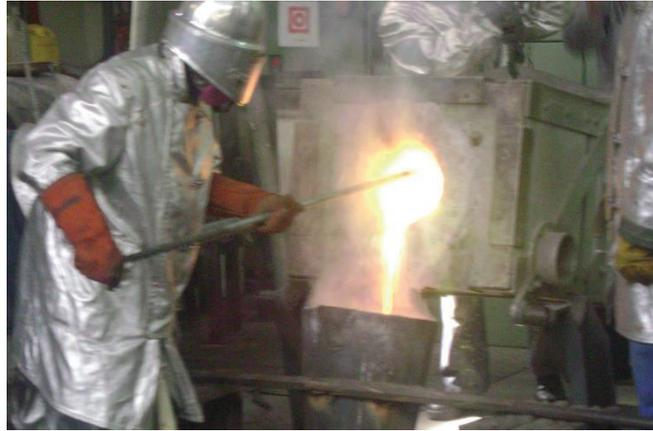
**Figura 4.3** Transporte del material fundido desde el horno hasta los moldes
