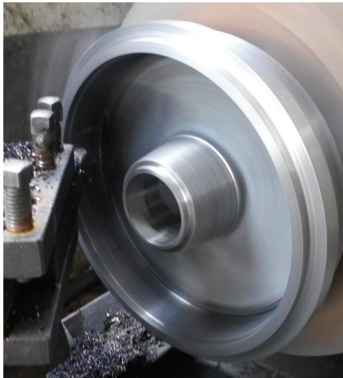
**Figura 4.7** Maquinado cara interna del tambor de freno
