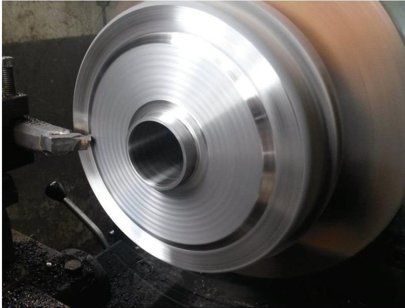
**Figura 4.6** Maquinado cara externa del Tambor de freno
