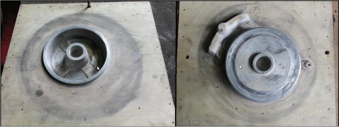
**Figura 4.1** Placa modelo semimetálica
