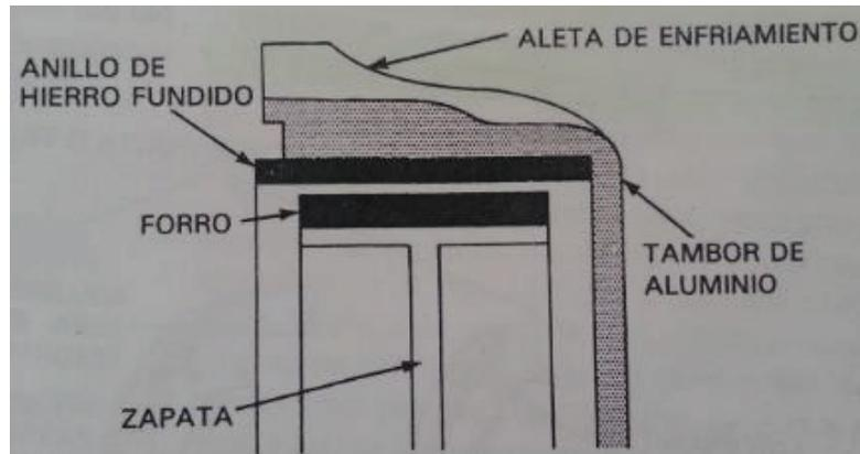
**Figura 2.8** Anillo de rozamiento de aleación de hierro fundido con tambor de aluminio<sup>54</sup>
