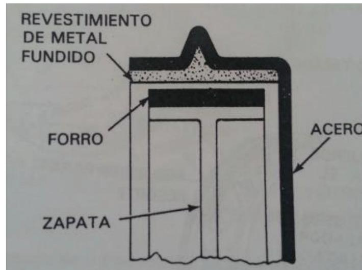
**Figura 2.7** Anillo de rozamiento de aleación de hierro fundido con tambor de acero<sup>53</sup>
