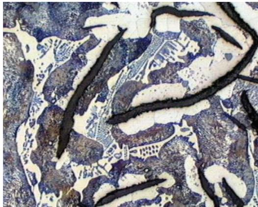
**Figura 1.5** Micrografía a 400 aumentos, steadita<sup>15</sup>
