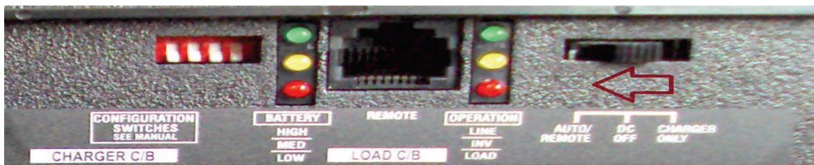
Figura 3.32 Posición del conmutador en el estado de automático del APS
