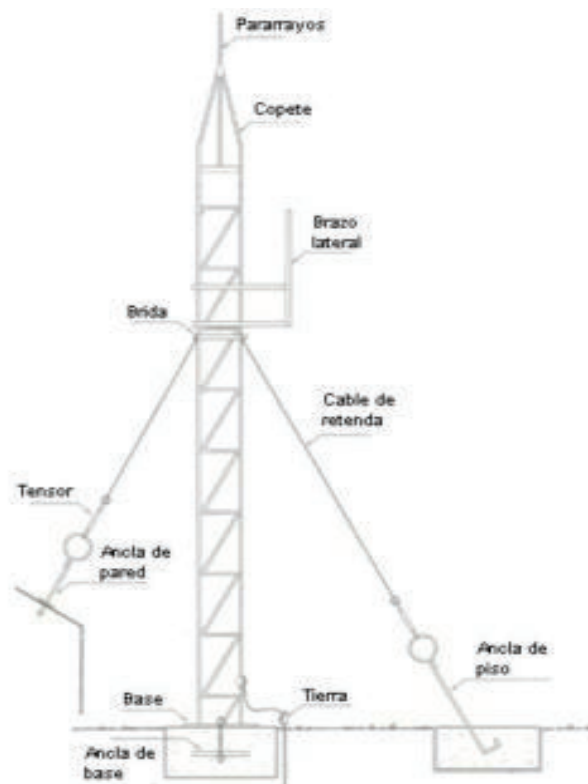
Figura 3.29 Partes de una torre soportada por tirantes 33
