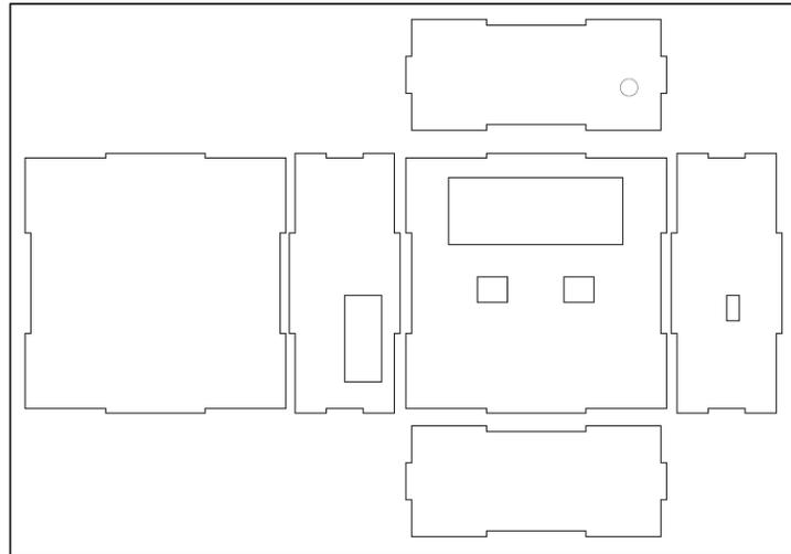
**Figura 3. 25** Piezas que conforman la Caja del Módulo del Entrenador.
