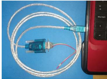
**Figura 3. 21** Conexión Cable Adaptador USB a RS-232 a PC.
