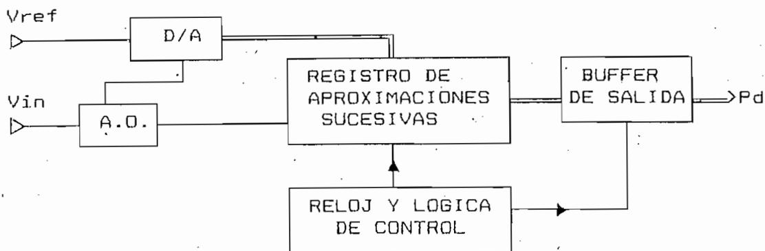
Fig. 2.11 Conversor A/D de aproximaciones sucesivas
