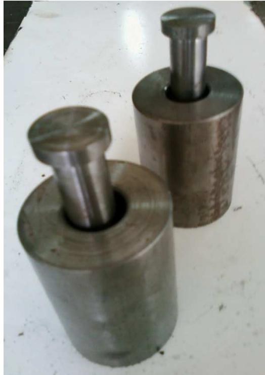
**Fig. 3.** Construcción de tochos de brazos exteriores con sus respectivos pasadores.
