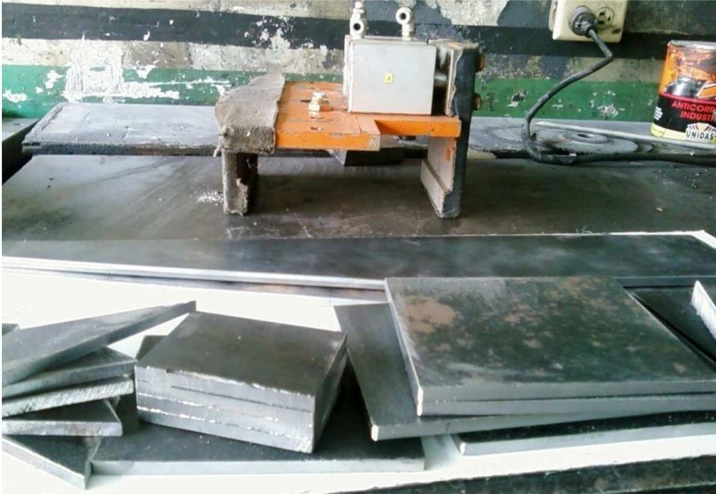
**Fig. 1.** Placas después de ser maquinadas, cuadradas.
