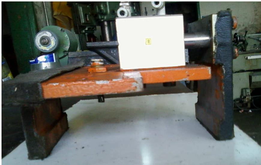
**Fig. 5.** Verificación de carrera del cilindro en sujetador de baterías.
