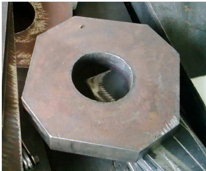
**Fig. 2.** Placas soporte de rodamientos ya maquinadas.
