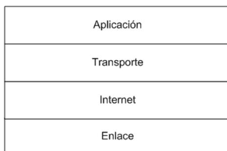
**Figura 3-18:** Capas del modelo TCP/IP
