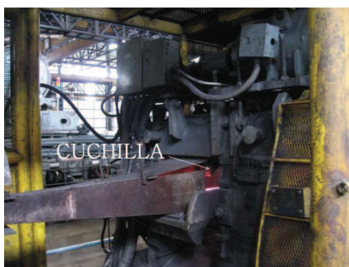
Figura 2.3 Cizalla Volante Tren de Laminación NOVACERO S.A.
