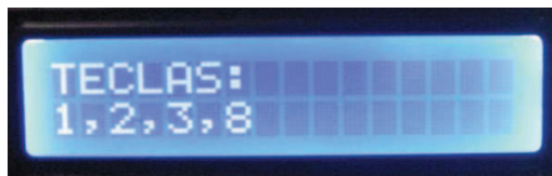
Figura 4.12 Lectura del teclado a través del módulo BV4218
