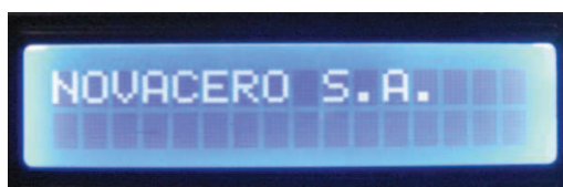
Figura 4.11 Escritura sobre el LCD a través del módulo BV4218
