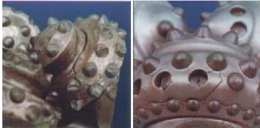
4. CC – Cono Fisurado
