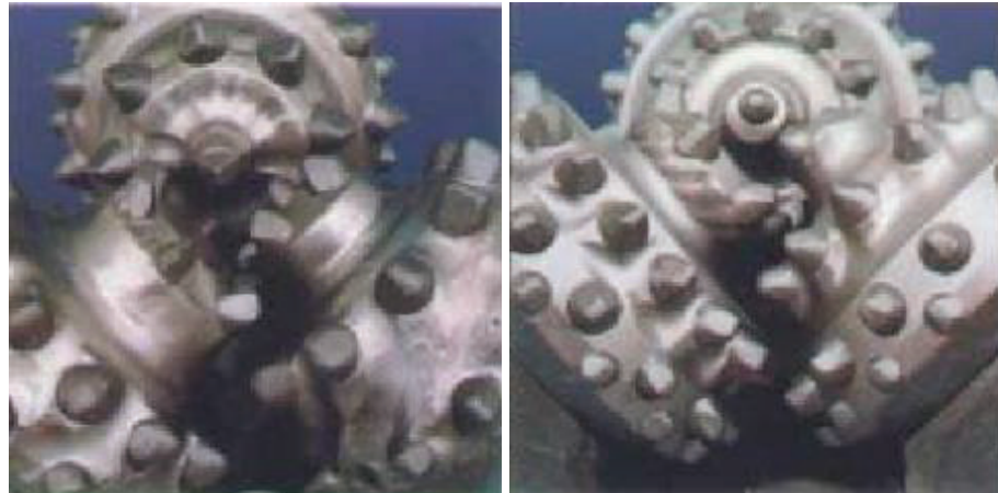
16. OC – Fuera de Centro
