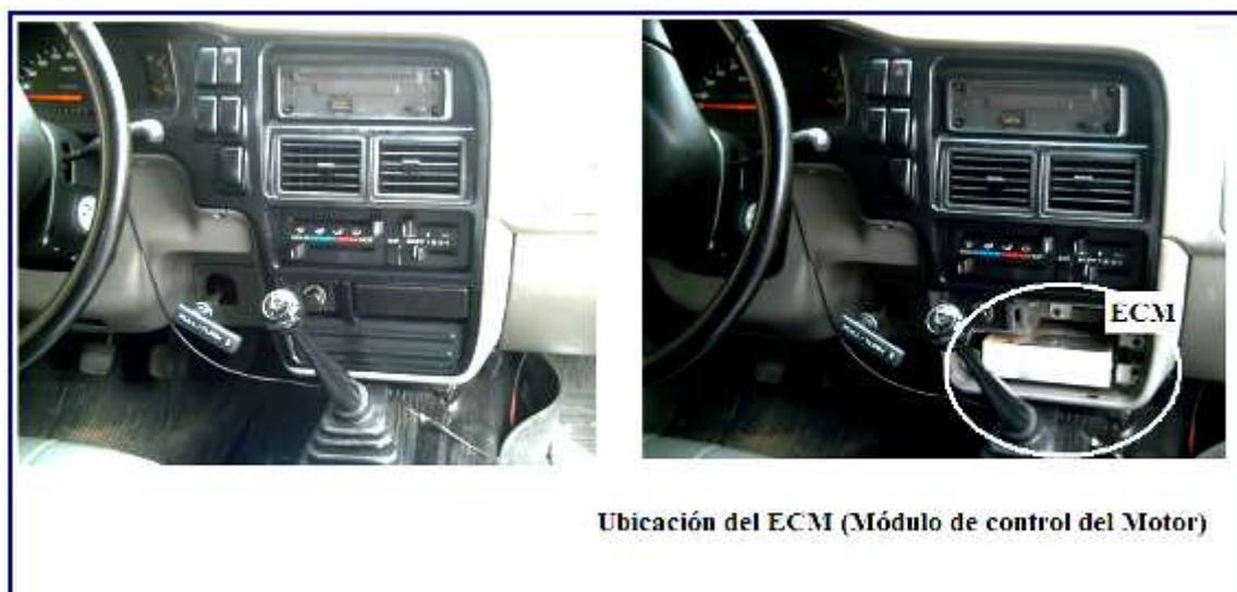
**Figura 3.72 “Ubicación del Módulo de control del motor”**
