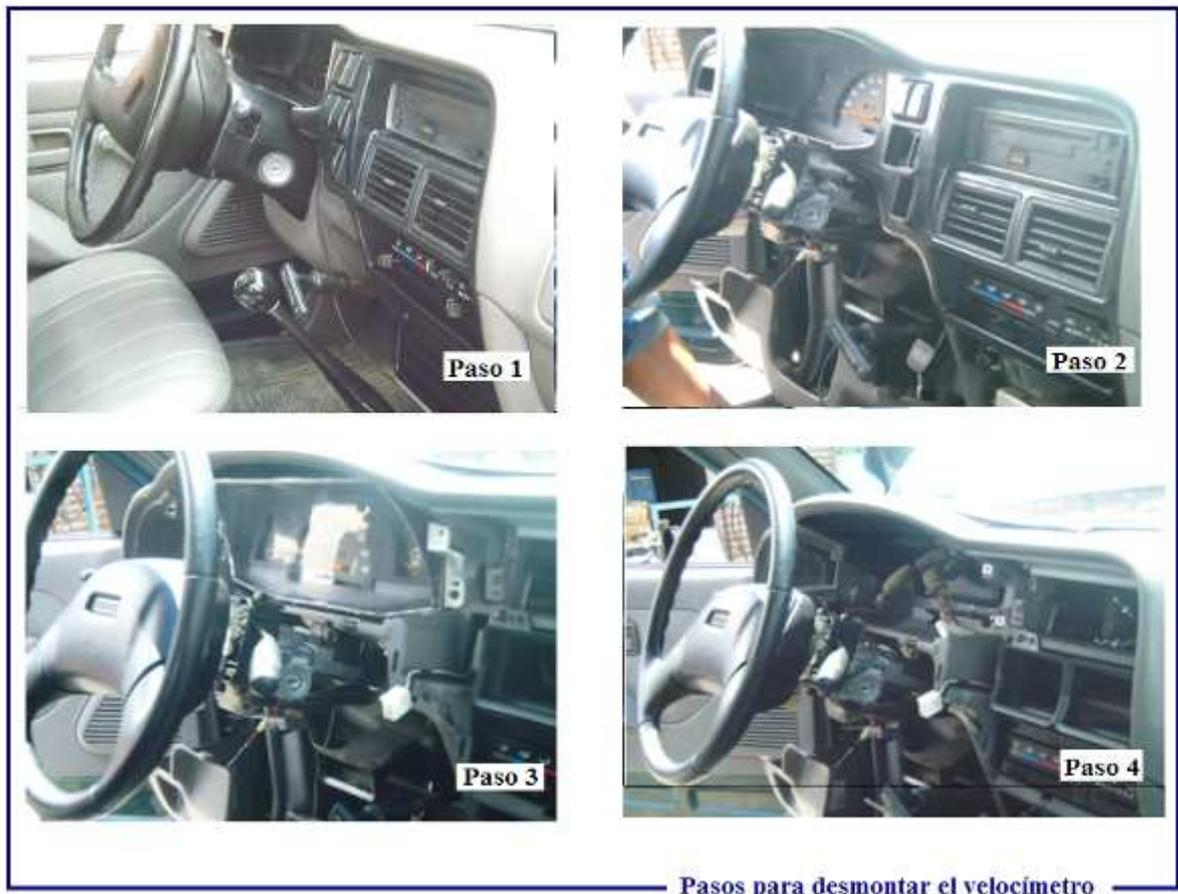
Figura 3.73 “Pasos para desmontar el Velocímetro del Panel frontal de la cabina”
