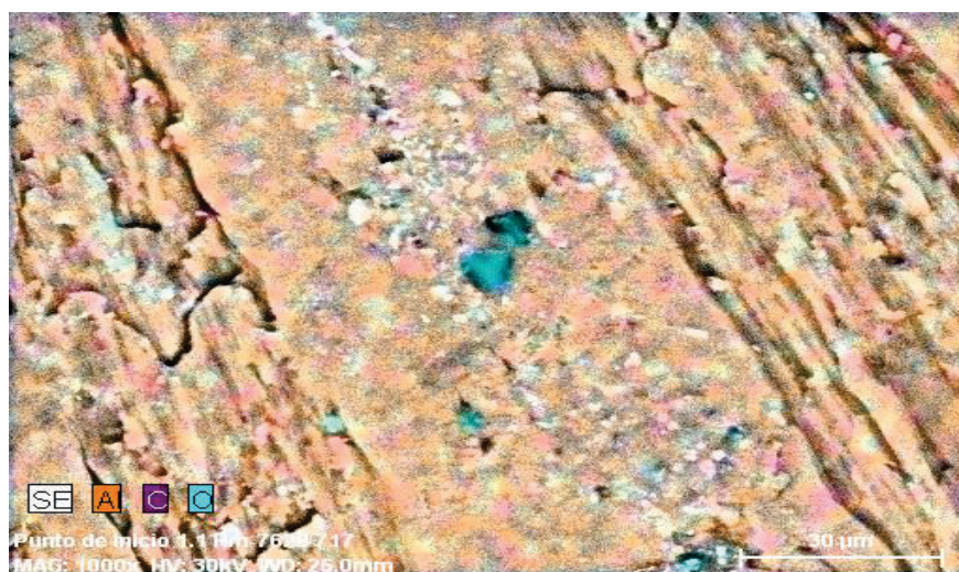
Figura 3.36. Imagen reportada por microscopía electrónica al realizar análisis semicuantitativo de una muestra de aluminio fundido (1000x)
