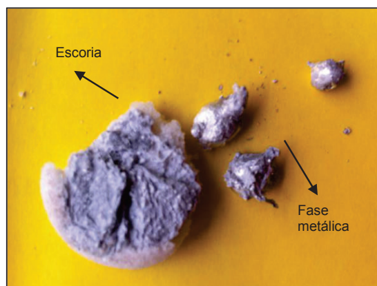
Figura 3.23. Fotografía del producto obtenido al realizar el proceso de fusión de láminas de Al como indica el Ensayo No.5
