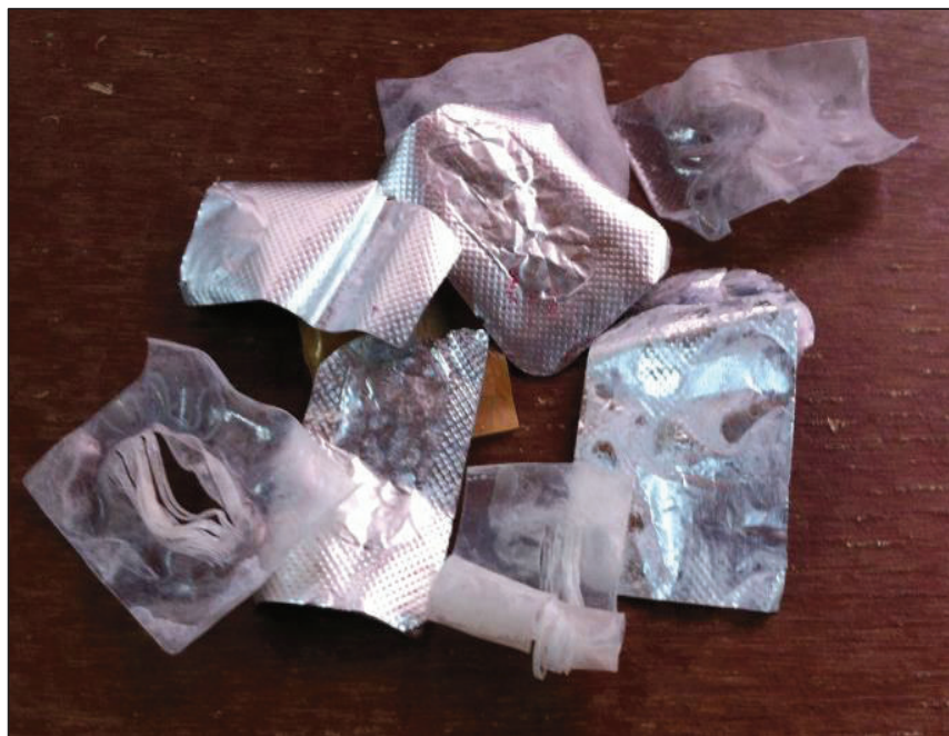
Figura 3.8. Fotografía de los productos obtenidos por lixiviación de empaques tipo blister usando como solvente acetona al 98 %
