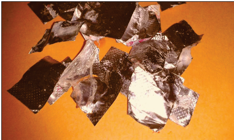
Figura 3.16. Fotografía del producto obtenido al realizar el proceso de lixiviación utilizando como solvente acetato de n-butilo al 50 % durante 180 min
