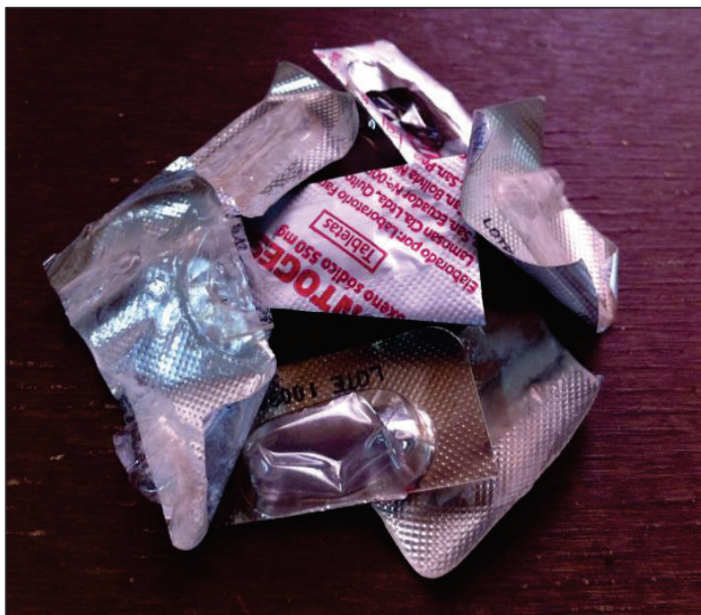
Figura 3.12. Fotografía de los productos obtenidos por lixiviación de empaques tipo blister usando como solvente acetona al 25 %
