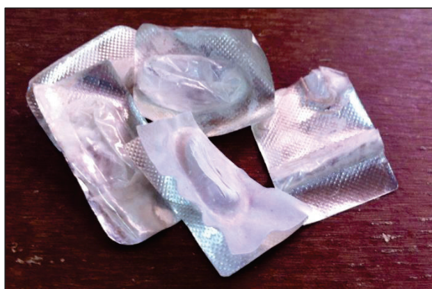
Figura 3.10. Fotografía de los productos obtenidos por lixiviación de empaques tipo blister usando como solvente acetona al 50 %
