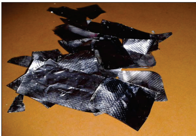
Figura 3.14. Fotografía del producto obtenido al realizar el proceso de lixiviación utilizando como solvente acetato de n-butilo al 98 % durante 150 min
