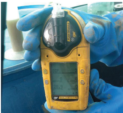
Figura 3.12 Evaluación puntual del H_2S luego de la reacción de sosa gastada con peróxido de hidrógeno
