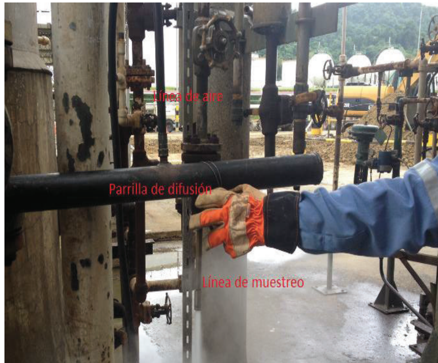
Figura 3.4 Muestreo en planta utilizando la parrilla de difusión
