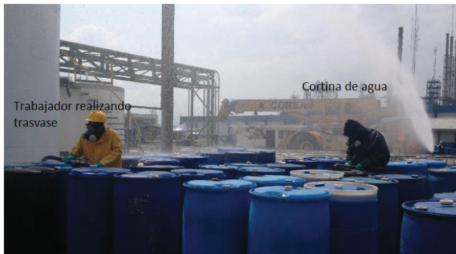
Figura 3.8 Utilización de medidas de control durante el trasvase de sosa gastada
