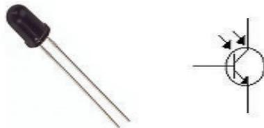
**Figura 1.16** – Apariencia y símbolo de un fototransistor
