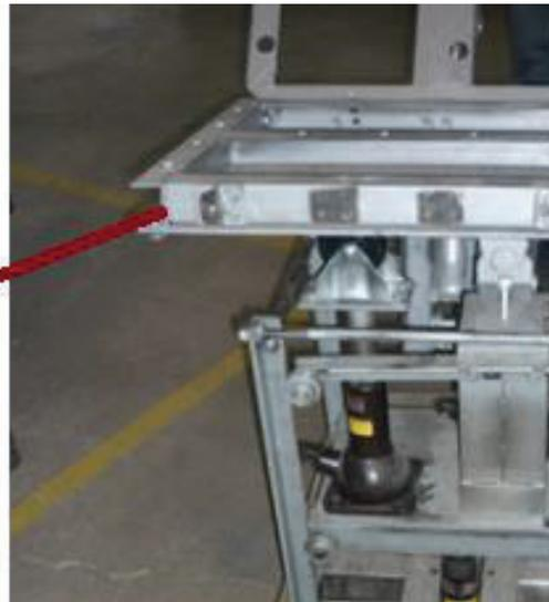
**Cambio de la geometría del trinquete actual.-** El mecanismo actual no funciona debido a que las tolerancias geométricas no son las correctas, por lo que se pretende mejorar el proceso de construcción con el fin de obtener las tolerancias que permitan mejorar el funcionamiento actual.
