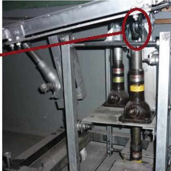
**Amortiguador.-** El amortiguador es un mecanismo complementario al elemento que se encuentra ya instalado, haciendo que la rueda que se encuentra instalada transmita el movimiento mientras que el amortiguador sirve de guía del movimiento.
