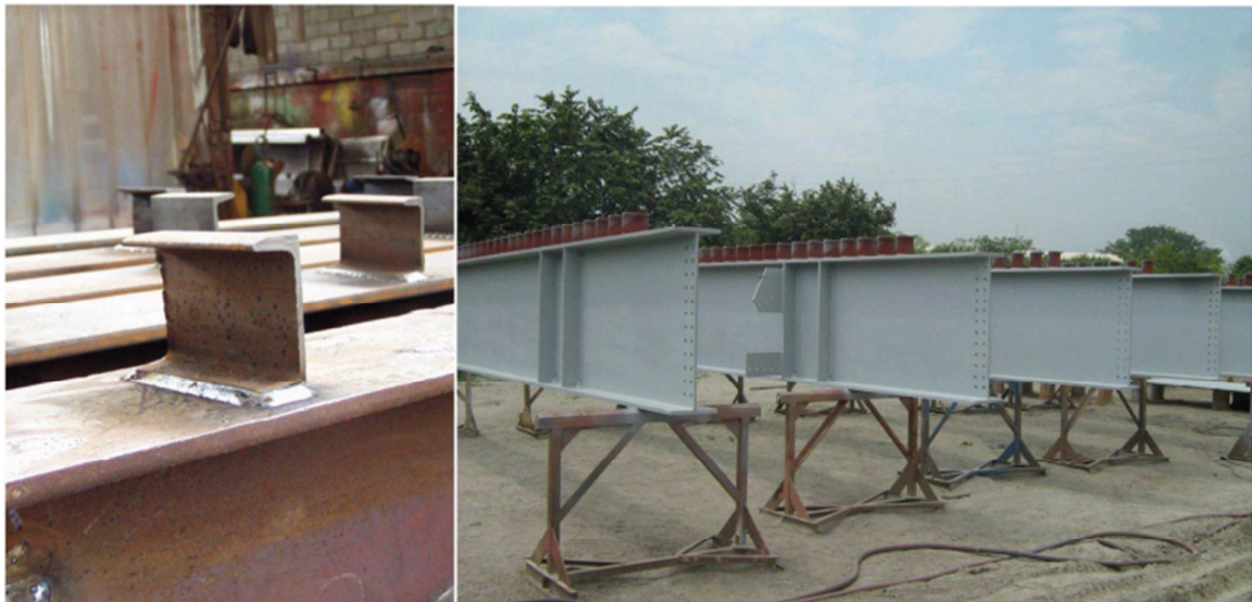
Imagen 9 Conectores tipo Canal laminado
