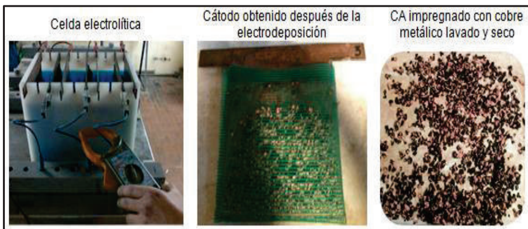
Figura 2.5. Esquema de la obtención de CAG impregnado con \text{Cu}^0
