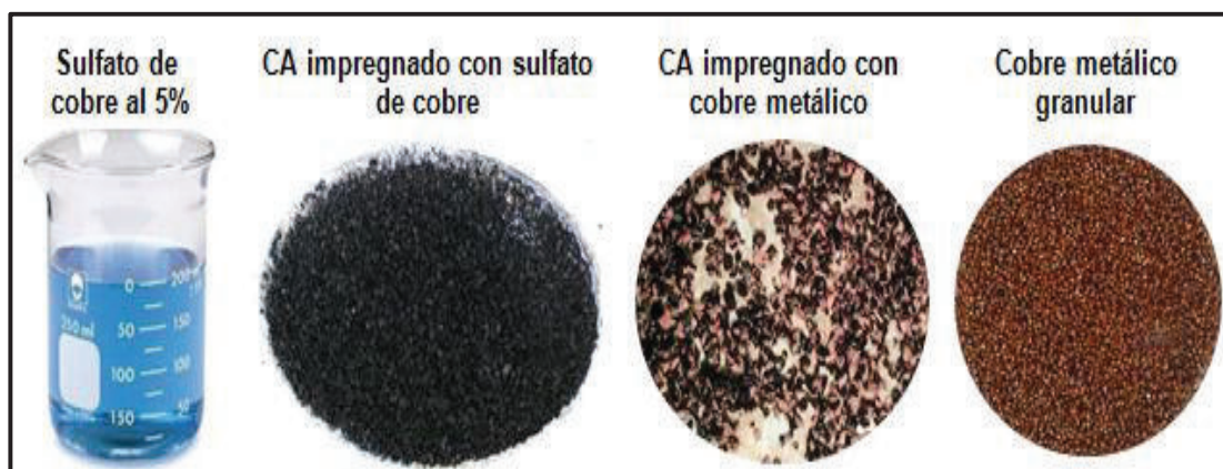
Figura 2.3. Catalizadores de cobre empleados en el proceso de oxidación de cianuro
