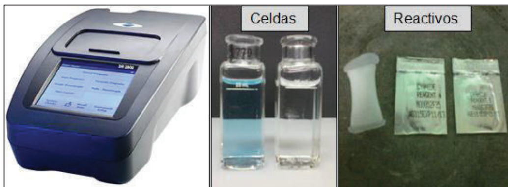
Figura AIV.1. Esquema de los equipos y reactivos empleados en la determinación de cianuro libre por el método colorimétrico Piridina-Pirazolona
