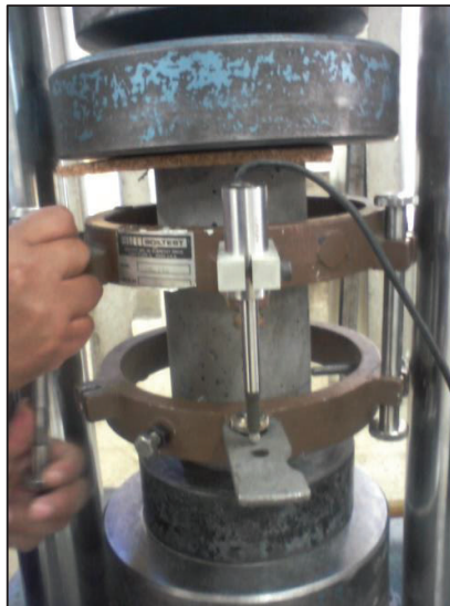
FIGURA 5.55 ESQUEMA DE LOS ACOPLES DE LOS ANILLOS Y DEFORMÍMETRO ADAPTADO A CILINDROS DE 100 X 200 mm.
