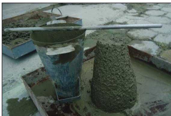
FIGURA 4.12 DETERMINACIÓN DEL ASENTAMIENTO EN MEZCLAS CON 1% DE ADITIVO HRWR.
