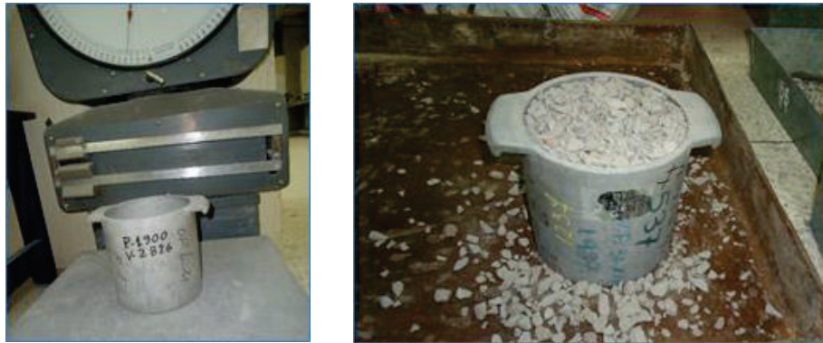
FIGURA 5.10 PROCEDIMIENTO PARA DETERMINAR LA DENSIDAD SUELTA PARA AGREGADO GRUESO
