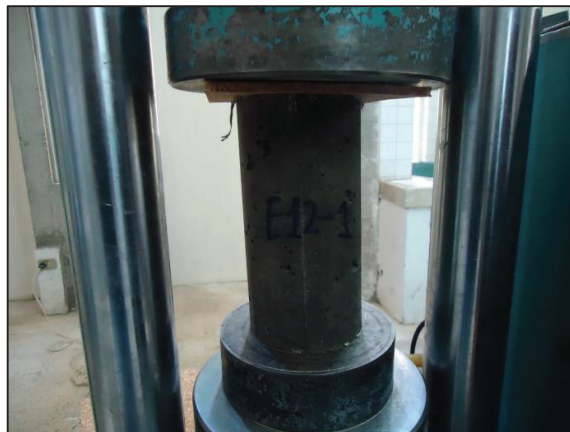
FIGURA 4.24 ENSAYO A COMPRESIÓN DE CILINDROS DE H.A.R CON FIBRAS.
