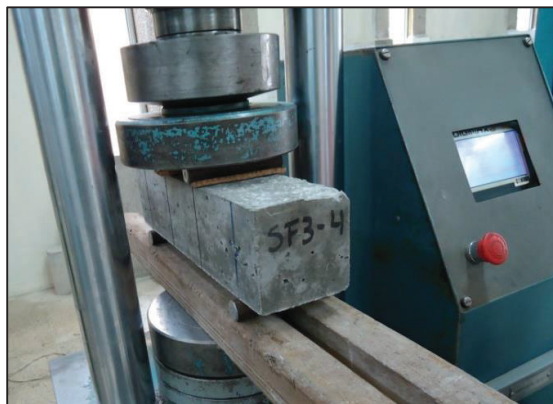
FIGURA 5.47 ENSAYO DE ROTURA A FLEXOTRACCIÓN EN CURSO
