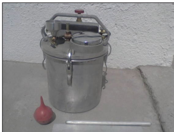
FIGURA 4.37 CONTENIDO DE AIRE, EQUIPO NECESARIO PARA EL ENSAYO GRAVIMÉTRICO.
