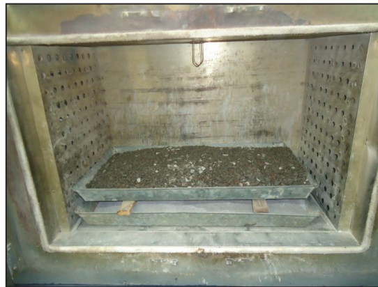
FIGURA 5.12 AGREGADO GRUESO EN PROCESO DE SECADO
