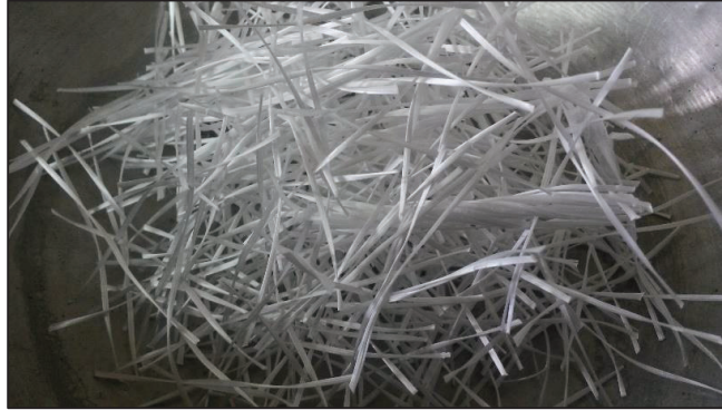
FIGURA 3.8 FIBRAS DE POLIPROPILENO/POLIETILENO TUF-STRAND.
