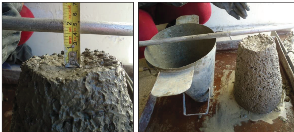
FIGURA 4.35 ASENTAMIENTO EN MEZCLA DE H.A.R CON 1.5% REDUCTOR
