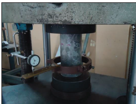
FIGURA 2.9 ENSAYO DE TENACIDAD EN CILINDROS DE 100X200 mm.
