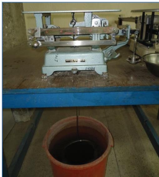
FIGURA 5.8 PESO DE CANASTILLA SUMERGIDA
