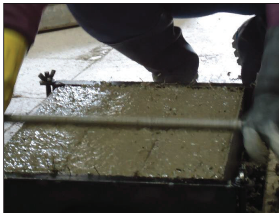
FIGURA 4.20 MOLDEO DE ESPECÍMENES PRISMÁTICOS DE H.A.R CON FIBRAS.
