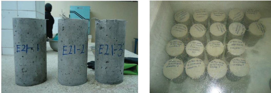
FIGURA 5.41 - MARCADO Y CURADO FINAL DE LAS PROBETAS
