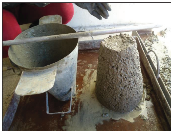
FIGURA 4.13 DETERMINACIÓN DEL ASENTAMIENTO EN MEZCLAS CON 1.5% DE ADITIVO HRWR.
