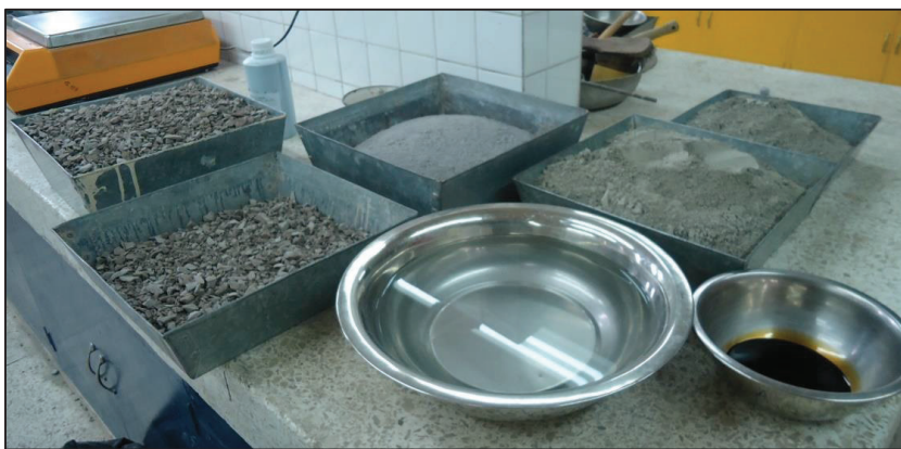
FIGURA 4.5 PROPORCIONES DE LOS COMPONENTES DEL HORMIGÓN.
