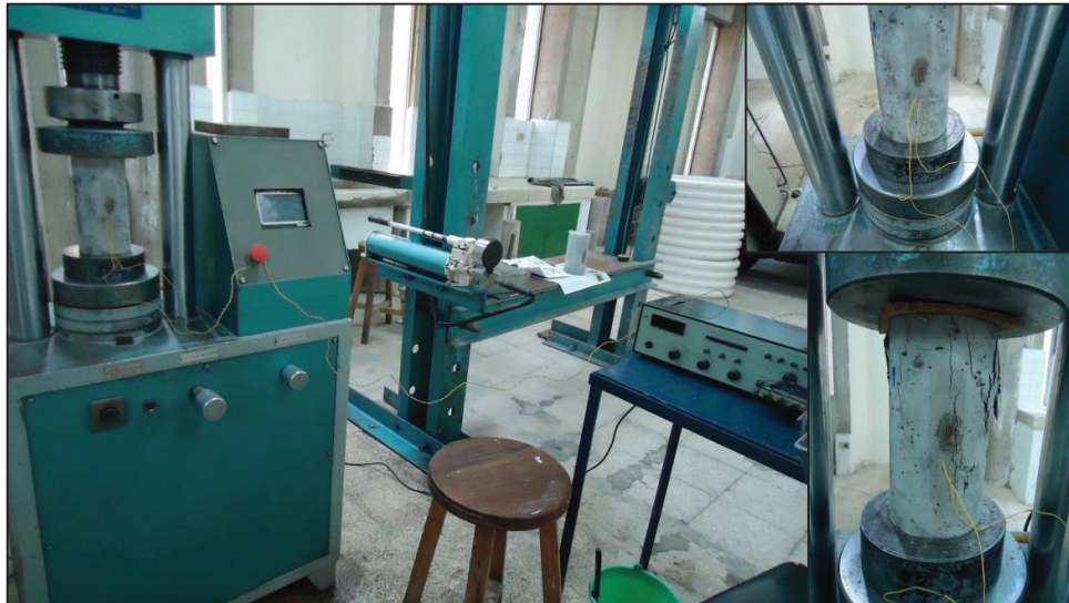
FIGURA 5.58 MONTAJE DE LA PROBETA PARA EL ENSAYO MÓDULO DE ELASTICIDAD.
