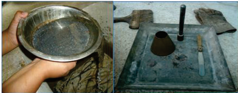
FIGURA 5.21 LAVADO DE LA MUESTRA Y EQUIPO PARA CONDICIÓN SSS
