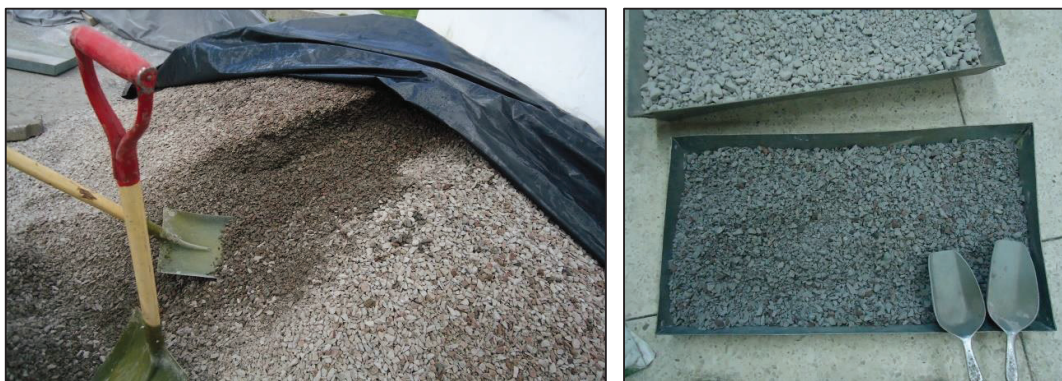
FIGURA 3.5 MUESTREO DEL AGREGADO GRUESO
