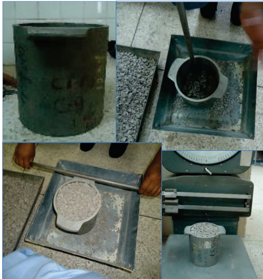
FIGURA 5.11 PROCESO DE DETERMINACIÓN DE DENSIDAD COMPACTADA DEL AGREGADO GRUESO.
