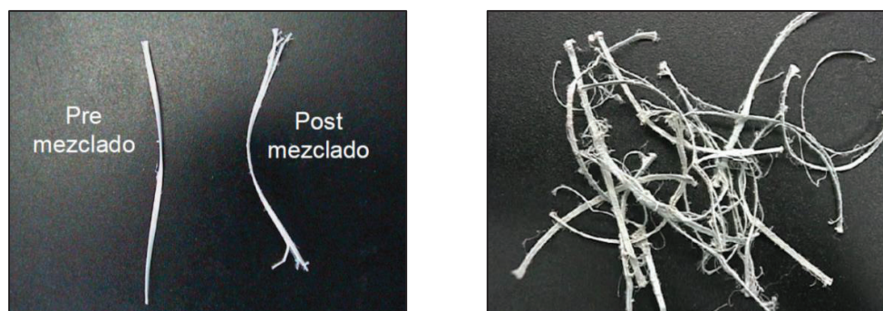
FIGURA 3.7 FIBRAS DE POLIPROPILENO/POLIETILENO TUF-STRAND, DESFRIBILADAS.
