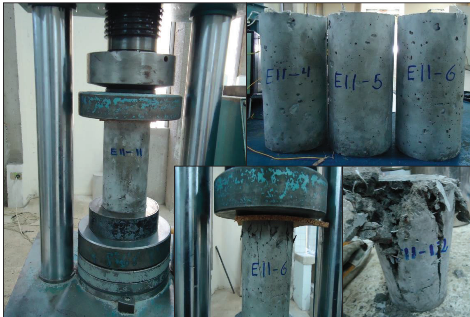
FIGURA 5.43 RESUMEN FOTOGRÁFICO DEL PROCEDIMIENTO DEL ENSAYO ROTURA POR COMPRESIÓN
