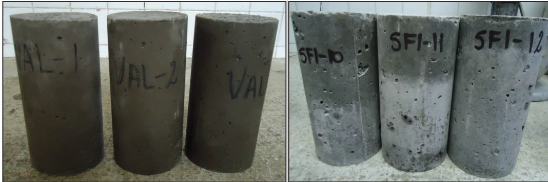
FIGURA 6.41 COMPARACIÓN DE PROBETAS MOLDEADAS CON ARENA LAVADA (IZQ.) Y CON ARENA EN ESTADO NATURAL
