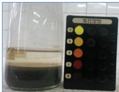
FIGURA 5.28 MEZCLA DEL REACTIVO Y AGREGADO EN REPOSO A LAS 24 HORAS.
