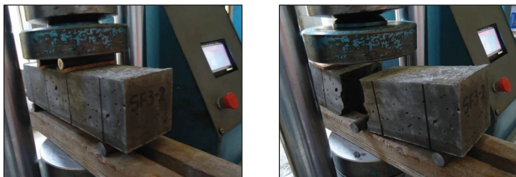
FIGURA 2.5 ENSAYO A FLEXIÓN EN VIGAS DE 100X100X400 MM.
