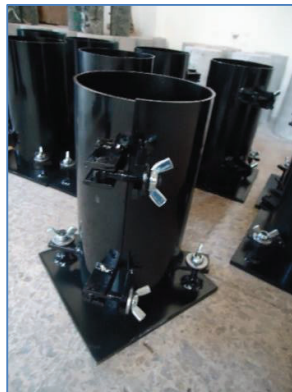
FIGURA 5.37 MOLDE CILÍNDRICO DE 100 mm DE DIÁMETRO
