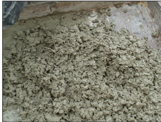
FIGURA 4.17 MEZCLA DE H.A.R CON INCLUSIÓN DE FIBRAS.
