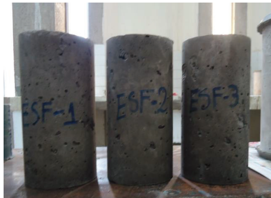
FIGURA 5.42 PROBETAS ANTES DEL ENSAYO ROTURA POR COMPRESIÓN
