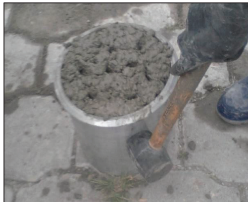
FIGURA 4.39 EVACUACIÓN DE BURBUJAS DE AIRE.
