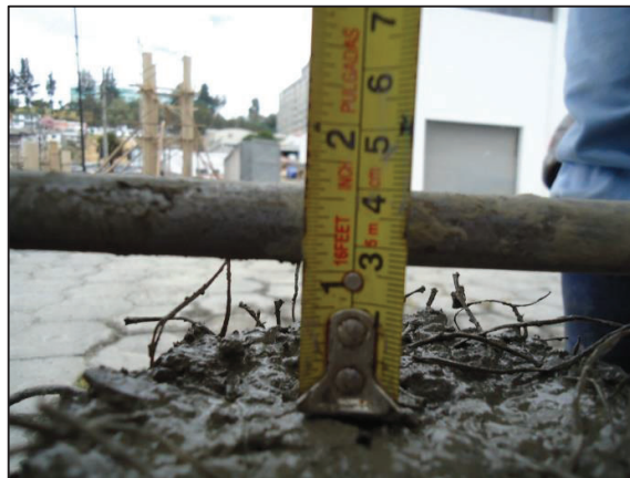
FIGURA 4.18 DETERMINACIÓN DEL ASENTAMIENTO EN MEZCLA CON FIBRAS.
