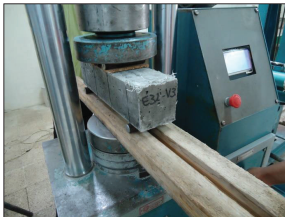
FIGURA 4.26 ENSAYO A FLEXIÓN, DE VIGUETAS DE H.A.R CON FIBRAS.
