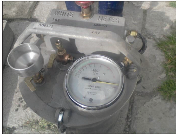
FIGURA 4.38 RECIPIENTE DE MEDICIÓN DE CONTENIDO DE AIRE.
