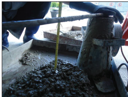
FIGURA 4.11 DETERMINACIÓN DEL ASENTAMIENTO EN MEZCLAS CON 1% DE ADITIVO, PARA LA SEGUNDA CORRECCIÓN.
