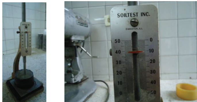
FIGURA 5.34 DETERMINACIÓN DE LA CONSISTENCIA NORMAL
