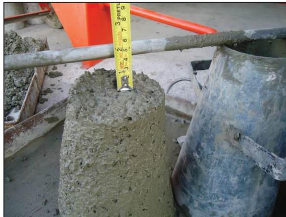
FIGURA 4.32 ASENTAMIENTO EN MEZCLA DE H.A.R CON 0.5% FLUIDIFICANTE
