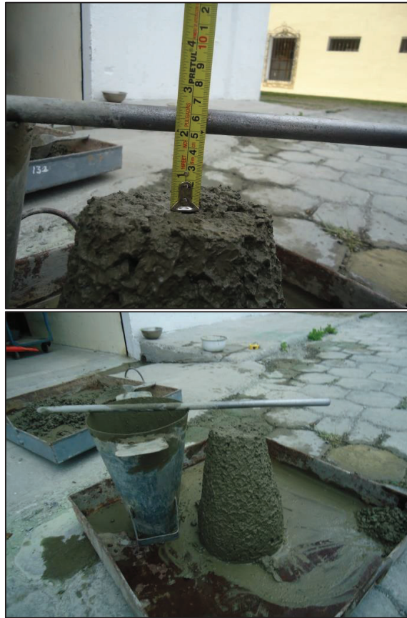
FIGURA 4.34 ASENTAMIENTO EN MEZCLA DE H.A.R CON 1% REDUCTOR
