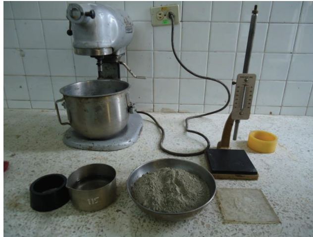
FIGURA 5.32 EQUIPO Y MATERIALES PARA CONSISTENCIA NORMAL
