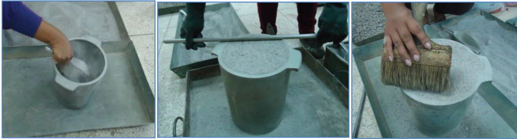
FIGURA 5.24 PROCESO DE LLENADO DEL MOLDE CON EL AGREGADO
