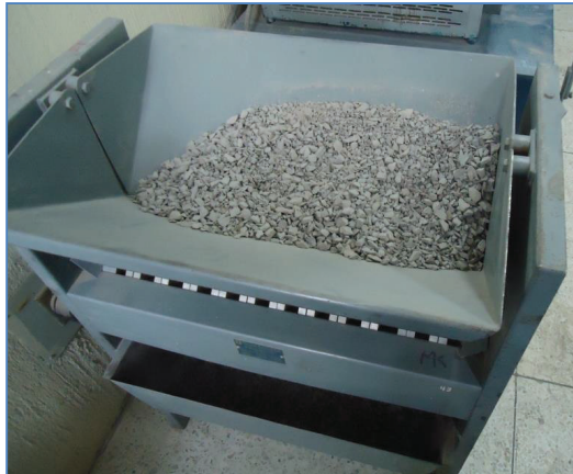
FIGURA 5.1 CUARTEO DE AGREGADO GRUESO
