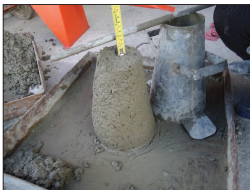
FIGURA 4.7 DETERMINACIÓN DEL ASENTAMIENTO EN MEZCLAS CON 0.5% DE ADITIVO, CON CORRECCIÓN DE AGUA.
