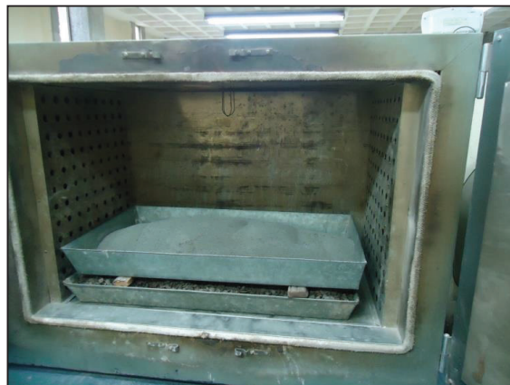
FIGURA 5.13 AGREGADO FINO EN PROCESO DE SECADO
