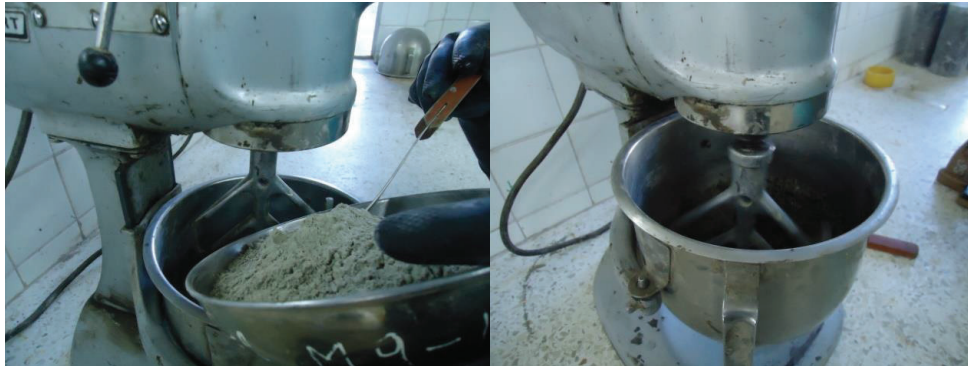
FIGURA 5.33 PREPARACIÓN DE LA PASTA DE CEMENTO
