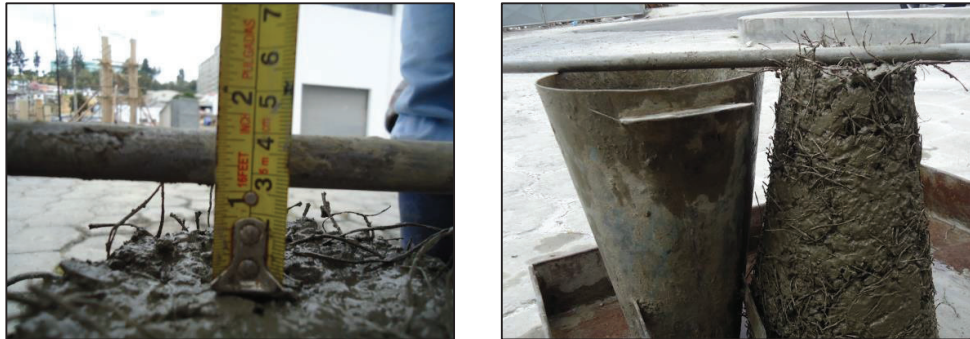
FIGURA 4.36 ASENTAMIENTO EN MEZCLA DE H.A.R CON ADICIÓN DE FIBRA.
