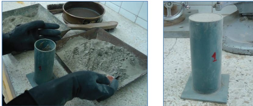
FIGURA 5.30 PROCESO DE DETERMINACIÓN DE LA DENSIDAD SUELTA DEL CEMENTO
