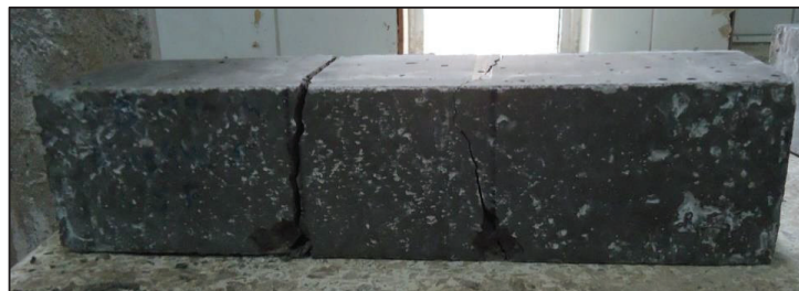
FIGURA 2.7 FALLAS EN ESPÉCIMEN DESPUÉS DEL ENSAYO A CORTE.
