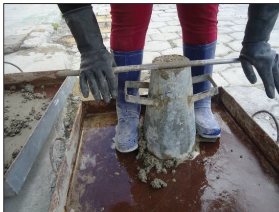
FIGURA 4.29 ENRASE Y NIVELACIÓN DE LA SUPERFICIE DE HORMIGÓN, EN EL CONO DE ABRAMS.
