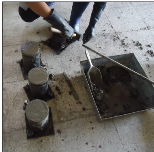
FIGURA 4.9 FABRICACIÓN DE ESPECÍMENES PARA ENSAYO A COMPRESIÓN.
