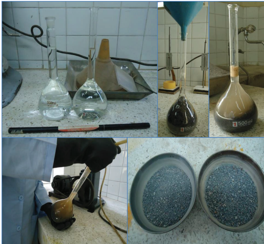
FIGURA 5.23 PROCEDIMIENTO GRAVIMÉTRICO PARA GRAVEDADES ESPECÍFICAS.
