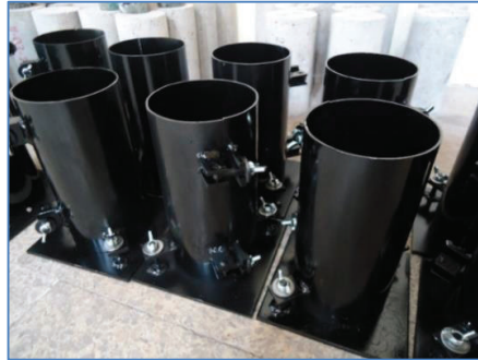
FIGURA 5.36 MOLDES CILÍNDRICOS PARA PROBETAS DE HORMIGÓN.
