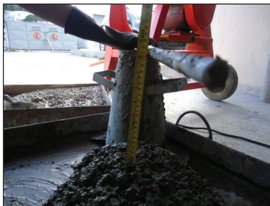
FIGURA 4.33 ASENTAMIENTO EN MEZCLA DE H.A.R CON 1% FLUIDIFICANTE
