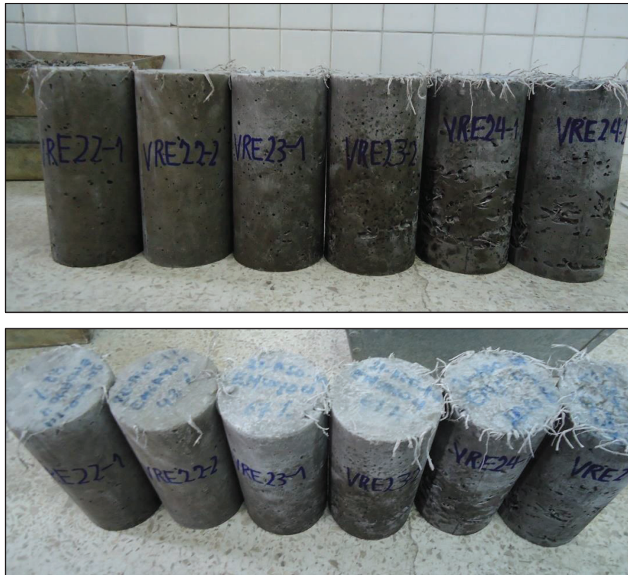
FIGURA 4.16 PROBETAS FABRICADAS CON DIFERENTES PORCENTAJES DE FIBRA AÑADIDA.
