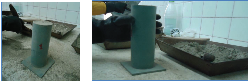
FIGURA 5.31 - PROCESO DE DETERMINACIÓN DE LA DENSIDAD COMPACTADA DEL CEMENTO
