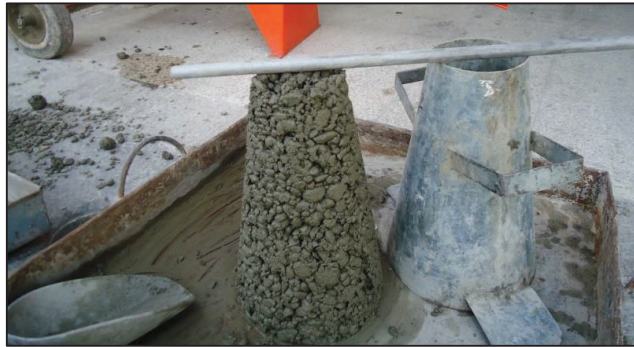
FIGURA 4.31 ASENTAMIENTO EN MEZCLA DE H.A.R SIN FLUIDIFICANTE
