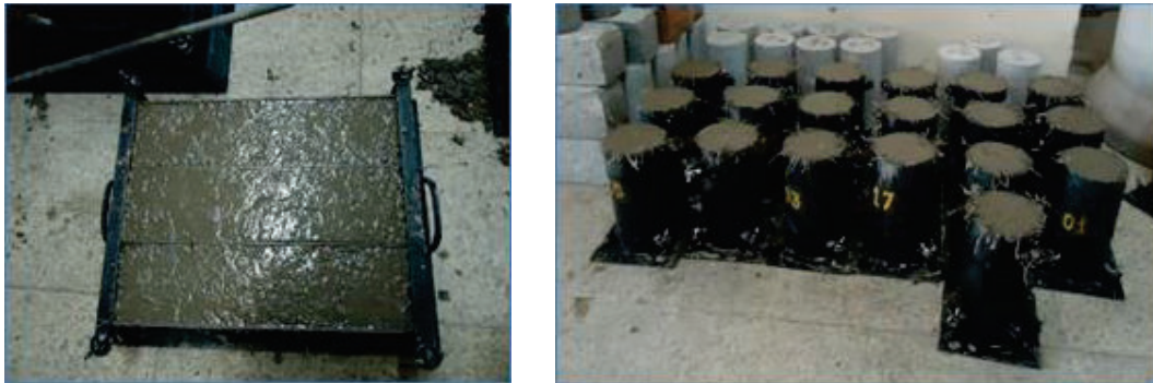
FIGURA 5.40 CURADO INICIAL DE LAS PROBETAS
