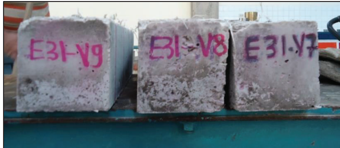
FIGURA 5.46 PROBETAS IDENTIFICADAS ANTES DEL ENSAYO DE ROTURA A FLEXOTRACCIÓN
