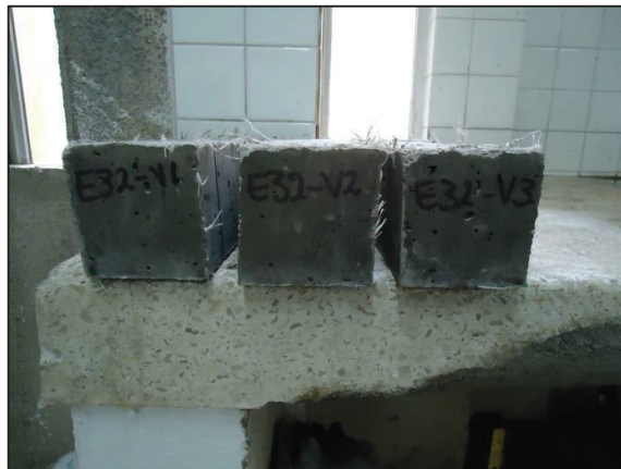
FIGURA 4.22 ESPECÍMENES PRISMÁTICOS DE H.A.R CON FIBRAS.
