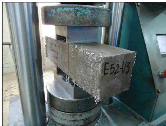
FIGURA 4.27 ENSAYO A CORTANTE, DE VIGUETAS DE H.A.R CON FIBRAS.
