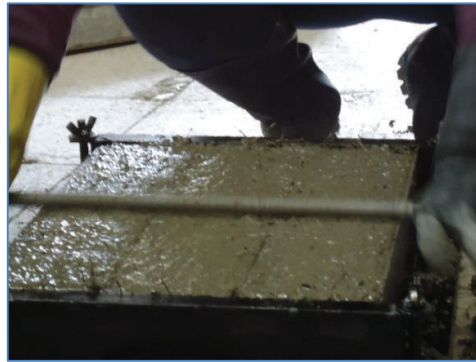
FIGURA 5.39 MOLDEO DE PROBETAS EN FORMA DE VIGAS
