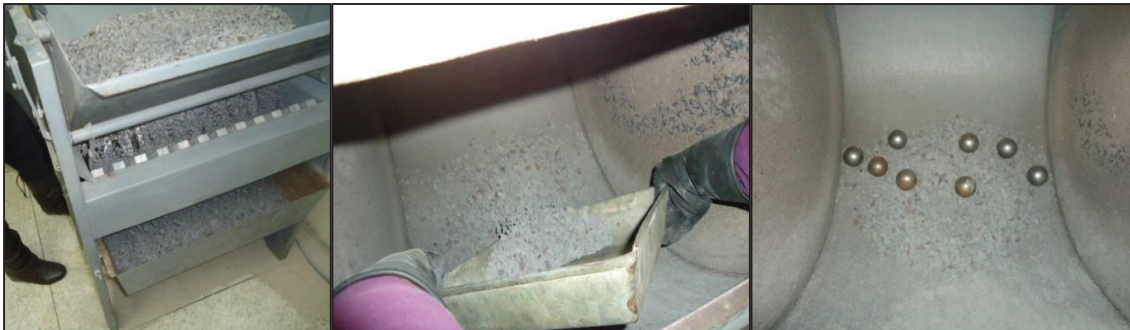
FIGURA 5.15 CUARTEADO Y COLOCACIÓN DE LA MUESTRA PARA EL PROCESO DE ABRASIÓN.
