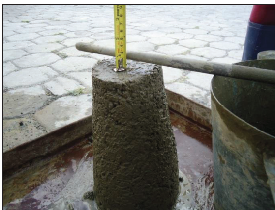
FIGURA 4.30 DETERMINACIÓN DEL ASENTAMIENTO MEDIANTE CONO DE ABRAMS
