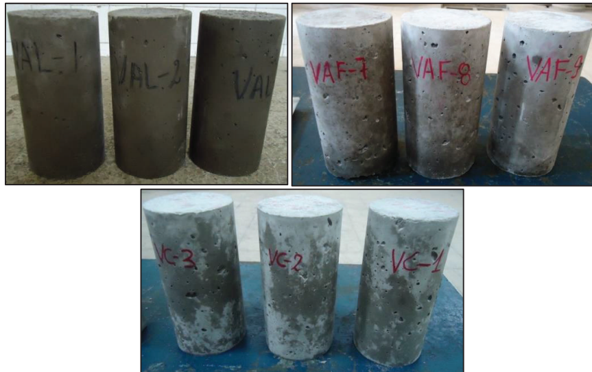
FIGURA 6.45 PROBETAS MOLDEADAS CON ARENA LAVADA (ESQ. SUP. IZQ.), ADITIVO FLUIDIFICANTE (ESQ. SUP. DER.) Y PARA CONTROL DE TEMPERATURA DE CURADO.
