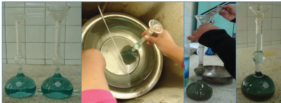
FIGURA 5.29 PROCESO DE LA DETERMINACIÓN DE LA DENSIDAD REAL DEL CEMENTO
