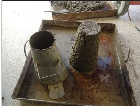
FIGURA 4.10 DETERMINACIÓN DEL ASENTAMIENTO EN MEZCLAS CON 1% DE ADITIVO.
