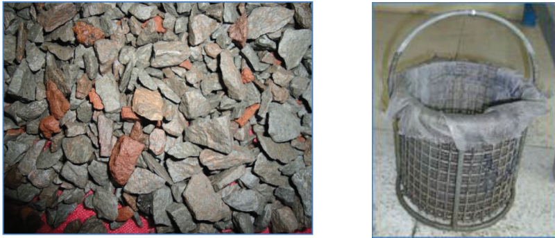
FIGURA 5.7 AGREGADO EN CONDICIÓN SSS Y CANASTILLA
