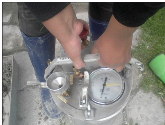
FIGURA 4.43 ACCIONAMIENTO DE LA LLAVE DE COMUNICACIÓN DEL DEPÓSITO Y EL RECIPIENTE.
