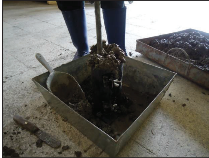
FIGURA 4.8 – MOLDEO DE ESPECÍMENES DE 100X200 mm.
