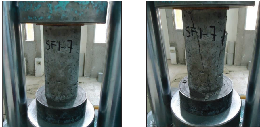
FIGURA 2.3 ENSAYO A COMPRESIÓN EN ESPECÍMENES DE 100X200 mm
