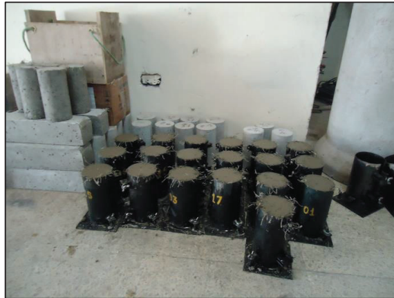
FIGURA 4.19 MOLDEO DE ESPECÍMENES CILÍNDRICOS DE H.A.R CON FIBRAS.
