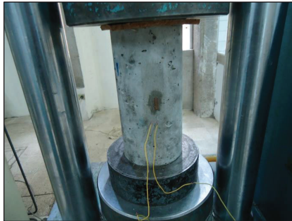
FIGURA 4.25 ENSAYO DE MÓDULOS DE ELASTICIDAD EN H.A.R CON FIBRAS.
