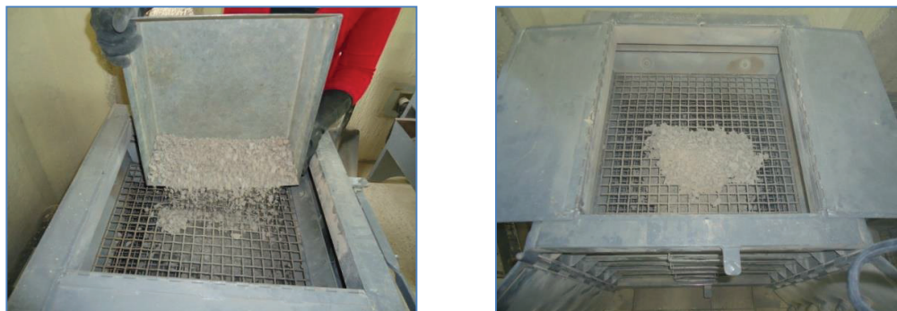
FIGURA 5.2 MUESTRA COLOCADA EN LA SERIE DE TAMICES CORRESPONDIENTES
