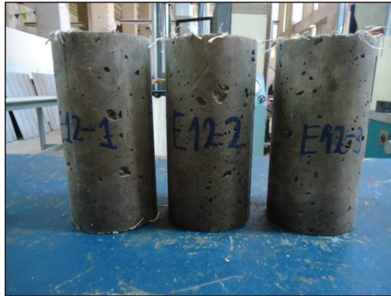
FIGURA 4.21 ESPECÍMENES CILÍNDRICOS DE H.A.R CON FIBRAS.
