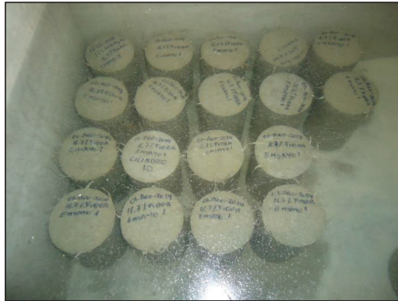
FIGURA 4.23 CURADO DE ESPECÍMENES DE H.A.R CON FIBRAS.
