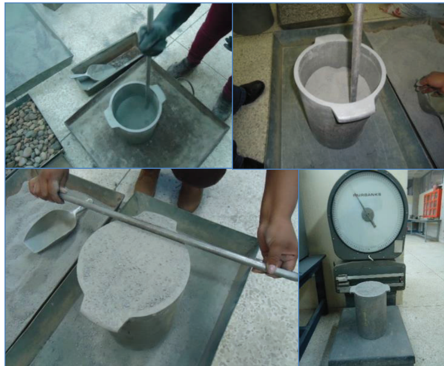
FIGURA 5.25 PROCESO DE LLENADO Y COMPACTADO DEL AGREGADO FINO
