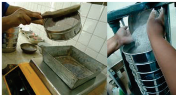
FIGURA 5.17 TAMIZADO Y DETERMINACIÓN DEL PESO RETENIDO EN LAS DIFERENTES MALLAS
