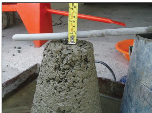
FIGURA 4.6 DETERMINACIÓN DEL ASENTAMIENTO EN MEZCLAS CON 0.5% DE ADITIVO.
