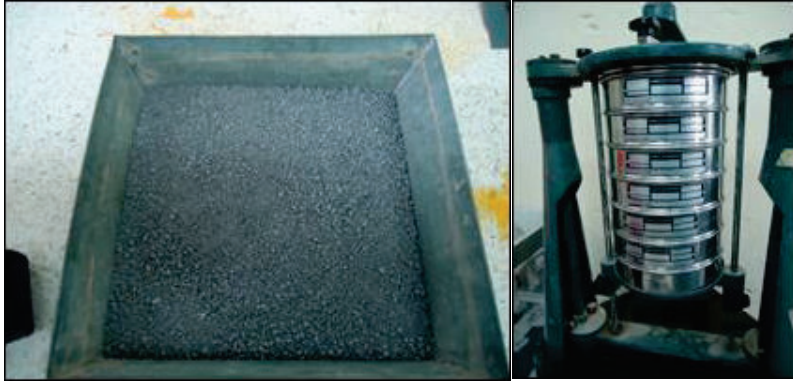
FIGURA 5.16 TAMIZADORA PARA AGREGADO FINO Y MUESTRA
