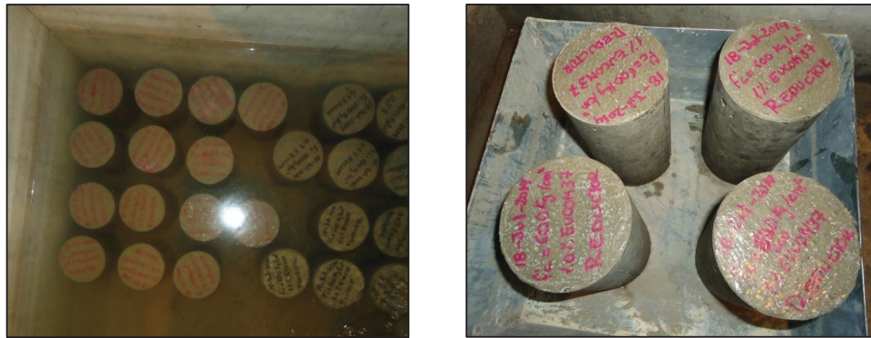
FIGURA 4.4 ESPECÍMENES FABRICADOS PARA SER ENSAYADOS A DIFERENTES EDADES.
