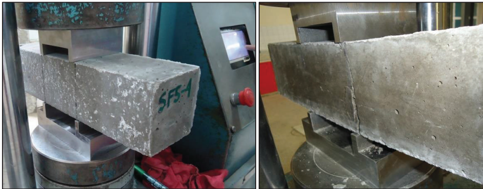
FIGURA 2.6 ENSAYO A CORTE CON ESPECÍMENES DE 10X10X400 mm.
