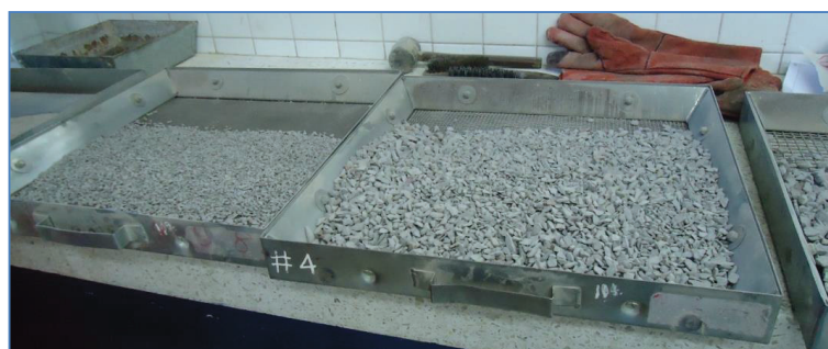
FIGURA 5.3 MATERIAL RETENIDO EN LAS DIFERENTES MALLAS
