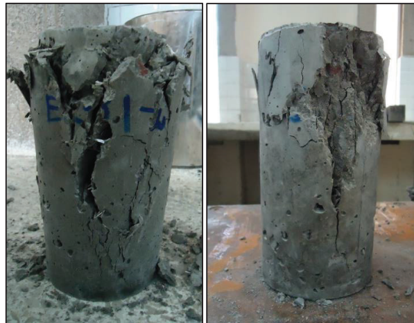
FIGURA 5.44 PROBETAS DE HORMIGÓN CON Y SIN FIBRA DESPUÉS DEL ENSAYO ROTURA POR COMPRESIÓN
