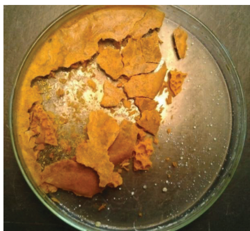
Figura 3.22. Producto obtenido de la solución cristalizada proveniente de la flotación iónica (relave)
