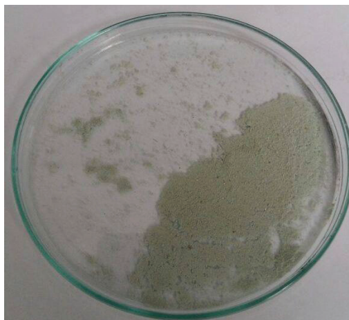
Figura 3.21. Producto obtenido de la solución cristalizada proveniente de la flotación iónica (concentrado)
